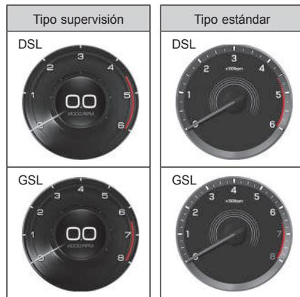
Indica las revoluciones por minuto del motor. El número indicado por la aguja se multiplica por 1.000 para obtener las RPM.
