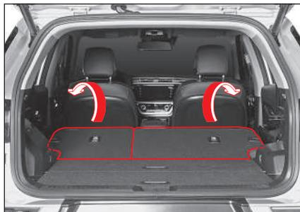
Al desplegar el espaldar hacia su posición original, realice el procedimiento en la secuencia inversa.
