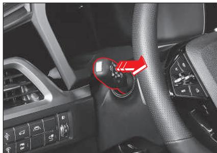
Las luces altas y las luces bajas se encienden al mismo tiempo mientras presiona el interruptor de luces en dirección del conductor.
