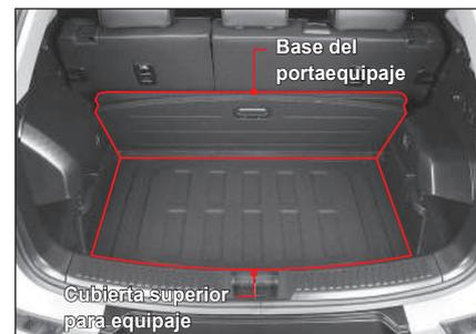
La base del portaequipaje puede almacenarse conforme se muestra en la figura y la cubierta del portaequipaje está ubicada debajo de ésta.
