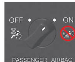
El airbag del pasajero frontal se desactiva (no se despliega) al ajustar el interruptor de activación/desactivación (ON/OFF) en posición "OFF". Este interruptor está ubicado al lado derecho del panel de instrumentos, y puede acceder a éste al abrir la puerta del pasajero frontal. Presione y gire el interruptor para accionarlo.
