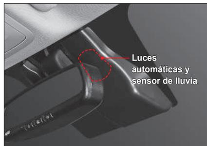
El sensor de lluvia está integrado con el sensor de luces automáticas.
