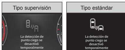
Si el sensor no logra detectar las áreas laterales y posterior del vehículo normalmente mientras que el sistema de advertencia lateral y posterior está activado, aparecerá el mensaje en la pantalla del panel de instrumentos.
