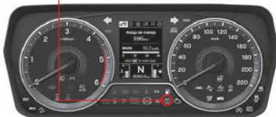
Si la presión de inflado es inadecuada o si el sistema de monitoreo de la presión en las llantas presenta anomalías, el indicador de advertencia general parpadeará y luego permanecerá encendido.
