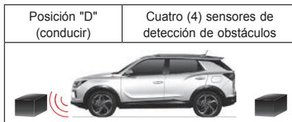
El sensor de detección de obstáculos al frente se activa al ajustar la palanca de cambios en la posición "D" (conducir).
