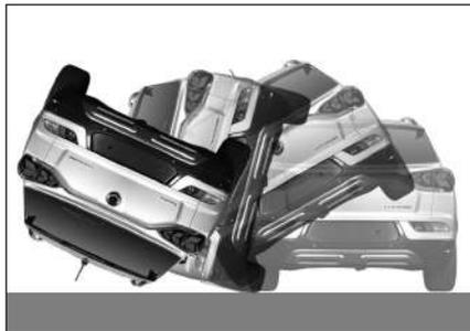
Si el vehículo se vuelca o sale rodando, los ocupantes no serán protegidos completamente por los airbags. En tal caso, no se despliegan los airbags.
