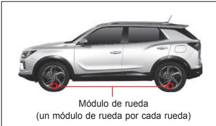
La unidad de control electrónico del sistema TPMS procesa varios datos incluidos la temperatura y presión de inflado desde el módulo de las ruedas integrado en cada rueda y muestra estos datos en el panel de instrumentos.
