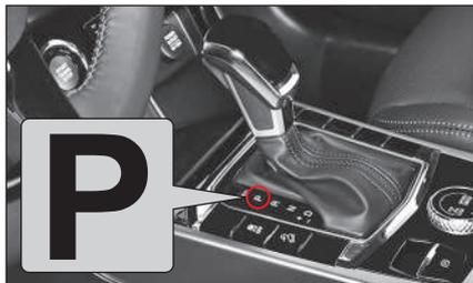
Seleccione esta posición para estacionar el vehículo, encender o precalentar el motor, o para detener el vehículo por un largo período de tiempo.
