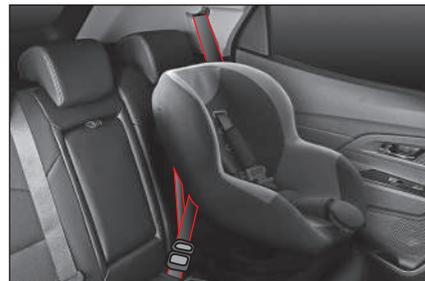
Sujete el sistema de protección para niños con un cinturón de seguridad tal como se muestra en la figura.
