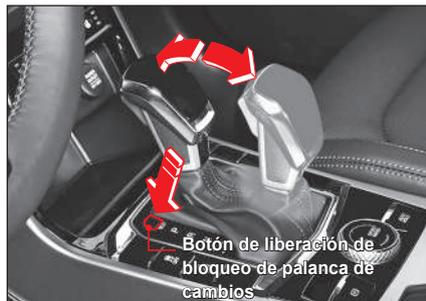
Si bien se ha operado la palanca de cambios conforme a la secuencia de funcionamiento del sistema de liberación del bloqueo de la palanca de cambios, si no es posible moverla de la posición "P" (parqueo) a las demás posiciones, muévala manualmente de la siguiente manera:
