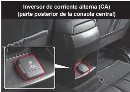
El inversor de corriente alterna (CA) es un dispositivo conveniente que convierte la corriente de 12 voltios CC provista por el vehículo en 220V (200W) [110V (150W)], cuya corriente es apta para uso doméstico, lo cual permite conectar y utilizar dispositivos eléctricos comunes tales como una computadora portátil, smartphone, TV móvil, equipo de iluminación, cargador de batería, etc.
