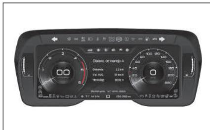
Verifique si todos los indicadores y las luces de advertencia se muestran correctamente en el panel de instrumentos con el motor de arranque en posición de encendido "ON".
