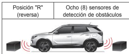
Al ajustar la palanca de cambios en la posición "R" (reversa), se activan simultáneamente cuatro (4) sensores de detección de obstáculos al frente y cuatro (4) sensores de detección de obstáculos por atrás.
