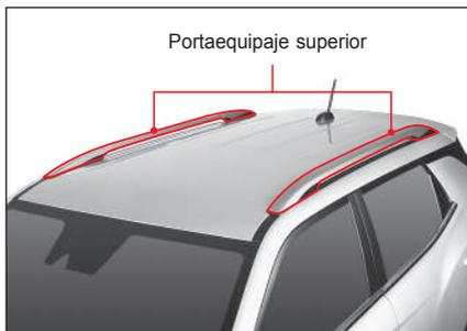
El equipaje puede cargarse en la parte superior del vehículo utilizando el portaequipaje superior.
