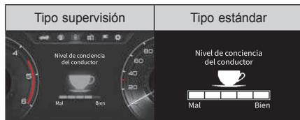
Se muestra el mensaje "Cautious driving level" (Nivel de conducción prudente) en 5 pasos y el conductor puede determinar su propio nivel de conducción prudente actual.
