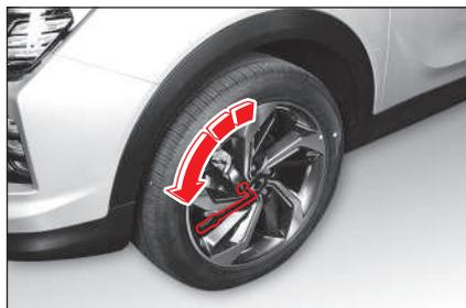
Si aplica demasiada tensión en los pernos, éstos podrían dañarse. No aplique demasiada tensión presionando los pernos de la rueda con el pie o utilizando una extensión.
