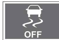
Al desactivar el sistema ESP presionando y sosteniendo el interruptor ESP OFF (por 3 segundos o más), el indicador se activa.
