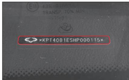
El VIN está incorporado en la parte superior del panel de instrumentos.
