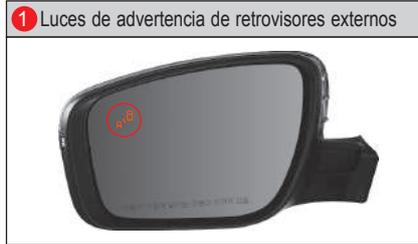
Cuando la luz de advertencia de los retrovisores externos parpadea dos veces con el interruptor START/STOP en posición "ON" o mientras el motor está operando, significa que el sistema de advertencia lateral y posterior está funcionando correctamente.
