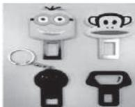
Al insertar un clip en el acople del cinturón de seguridad, el cinturón de seguridad es reconocido como si estuviese abrochado, así que la luz de advertencia de cinturón de seguridad y la alarma no serán activados.
