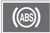
La luz de advertencia se enciende al ajustar el interruptor START/STOP en la posición "ON", y se apaga automáticamente si el sistema funciona correctamente.
