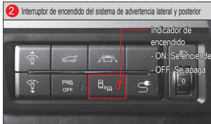
Al apagar el motor con el sistema de advertencia lateral y posterior desactivado y ajustar el interruptor START/STOP en posición "ON", el sistema se enciende sin regresar al estado anterior.
