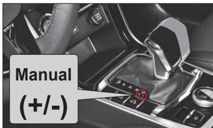
Al mover la palanca de cambios de la posición "D" (conducir) a la posición "M" (manual) +/-, el conductor podrá cambiar de marchas (1ra a 6ta) manualmente, como en una transmisión manual.
