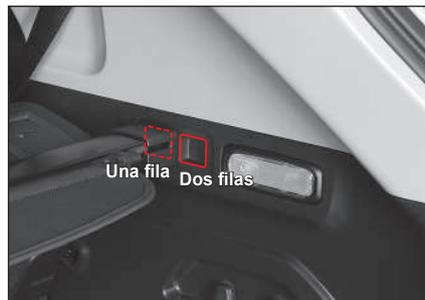
La cubierta superior para equipaje puede ajustarse en la posición de una o dos filas dependiendo del nivel de ajuste del ángulo de la espalda de los asientos posteriores.
