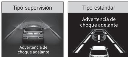
Si la distancia respecto al vehículo por delante es tan corta que podría ocurrir una colisión o si el vehículo por delante se aleja de la parte delantera debido a un cambio de carril, etc. mientras el control de crucero inteligente está activado, se mostrará este mensaje en el panel de instrumentos.
