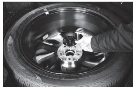
Abra la cubierta en el portaequipaje y extraiga la llanta de repuesto.
