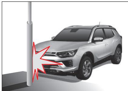
En caso de una colisión con un objeto angosto tal como un poste de alumbrado público o un árbol, el grado de impacto aplicado al sensor no sería suficiente, así que los airbags no se desplegarán.
