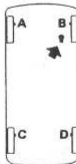
5. Instalar un tubo de sangrado en el tornillo de sangrado delantero más alejado del cilindro principal y sumergir el extremo libre en un recipiente transparente que contenga líquido de frenos. Comenzar a sangrar el sistema operando alrededor del vehículo y terminando en el freno trasero más próximo al cilindro principal; A, B, C y D.
