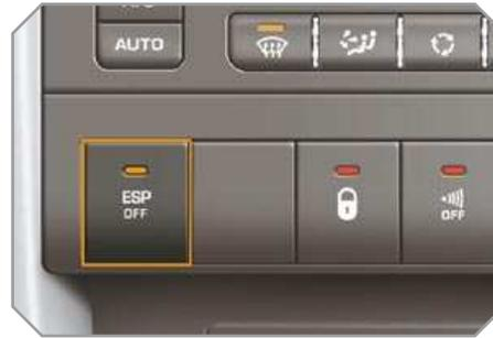
☞ Pulse el botón **"ESP OFF"**, situado en el medio del panel de instrumentos.
