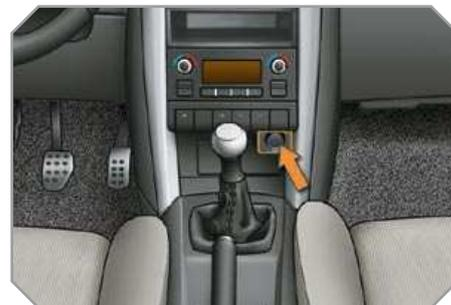
Este módulo de conexión, compuesto por una toma JACK y un puerto USB, está situado en la consola central.
