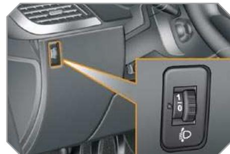
Para no molestar a los demás usuarios de la vía, los faros deben estar regulados en altura, en función de la carga del vehículo.
