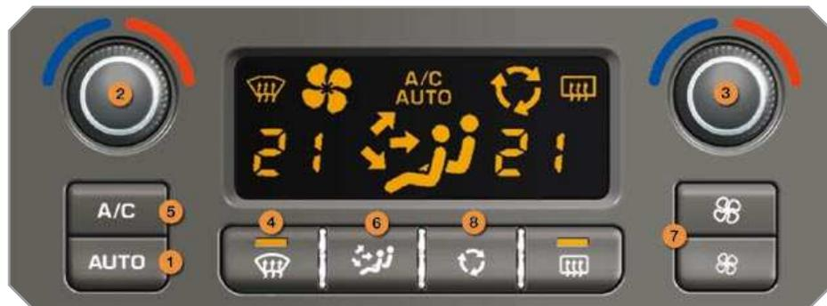
El aire acondicionado sólo puede funcionar con el motor en marcha.
