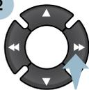
Pulse una de las teclas para seleccionar un fragmento del CD. Pulse la tecla LIST REFRESH para visualizar la lista de las pistas del CD. Mantenga pulsada una de las teclas para avanzar o retroceder rápidamente.
