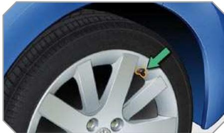
Unos sensores, montados en cada válvula, disparan una alerta en caso de mal funcionamiento (velocidad superior a 20 km/h).
