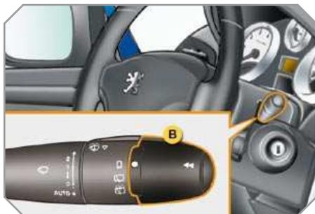
**!** En caso de nieve o de hielo importante y a la hora de utilizar un porta-bicicletas en el portón trasero, neutralice el limpiavientos trasero automático en el menú de configuración de la pantalla multifunción.
