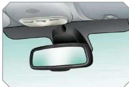
Gracias a un sensor que mide la luminosidad procedente de detrás del vehículo, este sistema realiza progresivamente y de forma automática el paso entre los modos día y noche.
