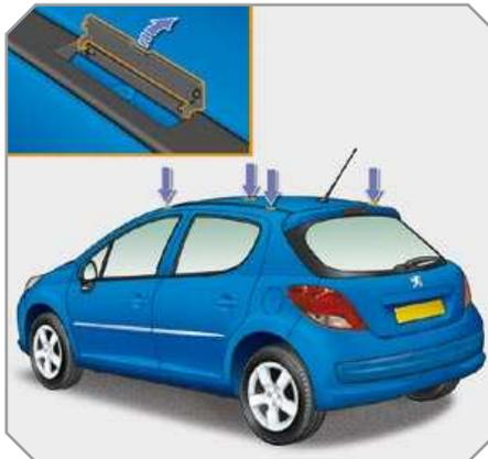
**i** Peso máximo autorizado en baka de techo, para una altura de carga que no sobrepase los 40 cm (excepto porta-bicicletas): 65 kg.
