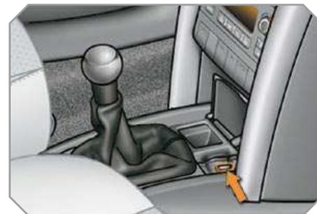
☞ Para conectar un accesorio 12 V (potencia máxima: 120 Vatios), levante la tapa y conecte el adaptador adecuado.
