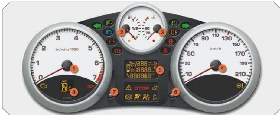
Panel que agrupa los señalizadores y testigos que indican el funcionamiento del vehículo.
