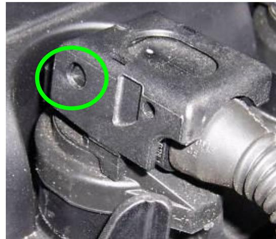
Conector mal fijado con clips.
