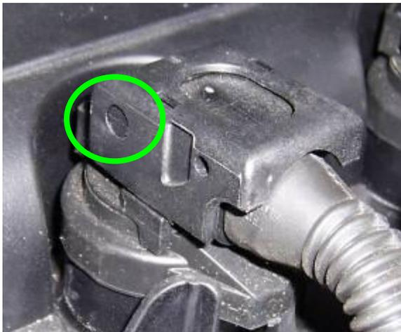
Conector bien fijado con clips.
