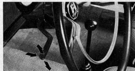
Con la tecla montada en el interruptor de luces intermitentes se acciona la luz de cruce y de carretera. Cuando la luz de carretera está conectada, luce en el velocímetro la lámpara de control azul. Asimismo, con el alumbrado desconectado y con la luz de población, se acciona la bocina óptica.
