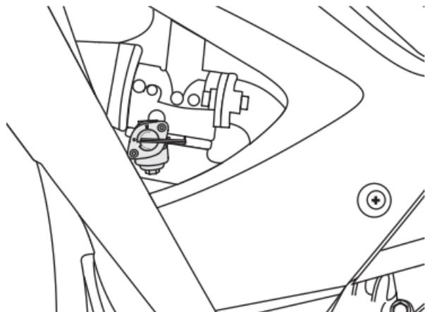
El grifo de paso de gasolina está ubicado en la parte lateral izquierda del carenaje, el cual se observa a través del orificio. Éste tiene las siguientes dos posiciones:
