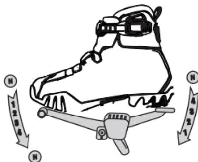
La AK125 FLEX ULTRA viene equipada con una caja de cambios de 4 velocidades que opera según la gráfica, esta se encuentra ubicada al lado izquierdo del motor. Para accionar los cambios de manera apropiada, se debe desacelerar y pisar la palanca. Cada vez que se seleccione un cambio, la palanca vuelve a su posición inicial y queda lista para seleccionar otro cambio. Empuje hacia abajo
