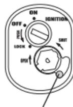
El switch de seguridad sirve para tapan la ranura donde se introduce la llave.
