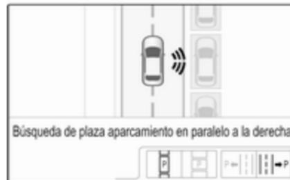
Seleccione la plaza de aparcamiento paralela o perpendicular tocando el icono correspondiente en la pantalla. Seleccione el lado de estacionamiento tocando el icono correspondiente en la pantalla.
