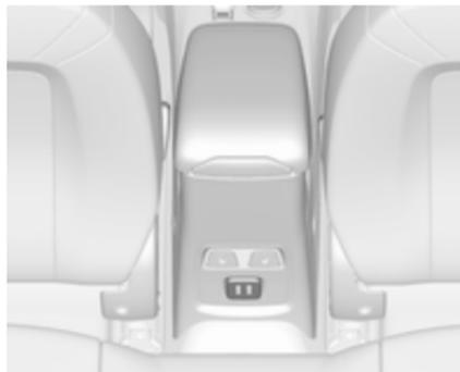
Los dos puertos USB para cargar dispositivos están situados solamente en la parte trasera de la consola central.
