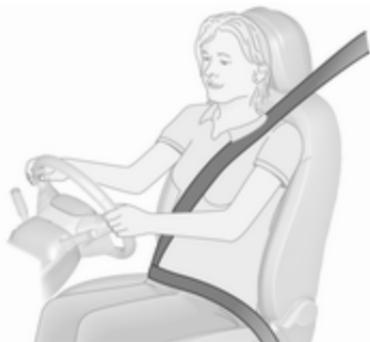
Al acelerar o frenar bruscamente el vehículo, los cinturones de seguridad se bloquean para sujetar a los ocupantes en la posición de asiento. De este modo, se reduce considerablemente el riesgo de que se produzcan lesiones.
