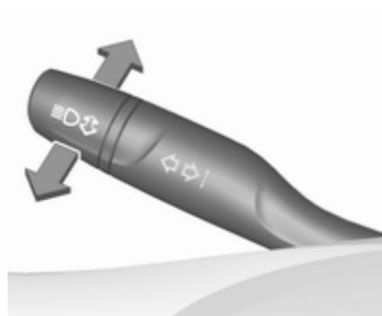
Pulse la palanca para cambiar de luz de cruce a luz de carretera.
