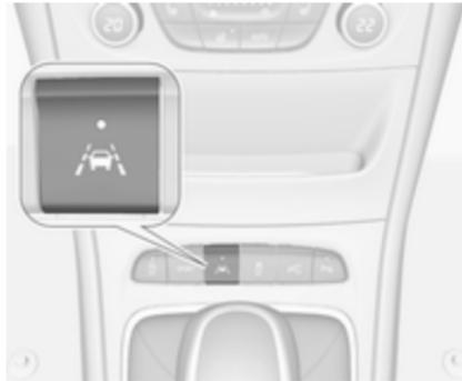
El asistente de mantenimiento de carril se activa pulsando
