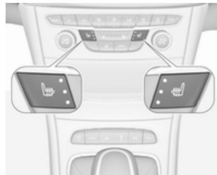
Para ajustar la potencia de calefacción deseada, pulse una o varias veces
