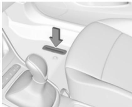
El número de identificación del vehículo puede estar estampado en la placa de características y en el panel del piso, debajo de la cubierta del piso, visible bajo una tapa.
