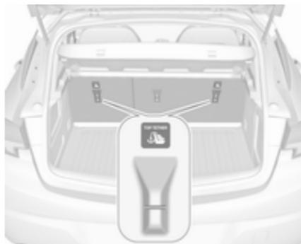
Además de los soportes de montaje ISOFIX, fije la correa del anclaje superior a las argollas de fijación del anclaje superior. La correa debe pasar entre las dos varillas guía del reposacabezas.
