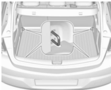
En vehículos equipados con rueda de repuesto, las argollas delanteras se encuentran ubicadas en las paredes laterales.
