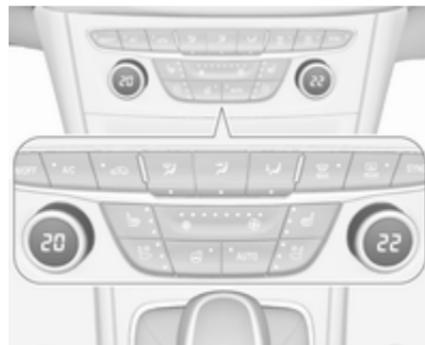
Configure las temperaturas al valor deseado. El mando del lado del acompañante cambia la temperatura del lado del acompañante. El mando del lado del conductor cambia la temperatura del lado del conductor o ambos lados, en función de la activación de sincronización **SYNC**.
