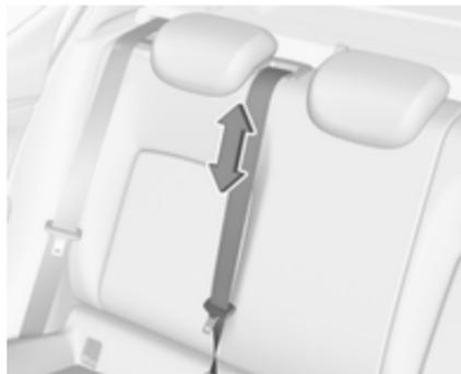
El cinturón de seguridad del asiento central podría bloquearse si el respaldo se endereza demasiado rápidamente. Para desbloquear el retractor, introduzca el cinturón de seguridad o tire de él unos 20 milímetros y luego suéltelo.
