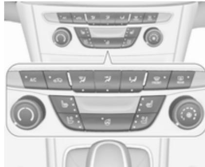
Además de los mandos del sistema de calefacción y ventilación, el sistema de aire acondicionado dispone de controles para:
