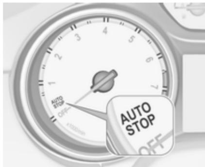
Si el vehículo circula a baja velocidad o está parado y se cumplen determinadas condiciones, se activa una función de parada automática (Auto-stop).
