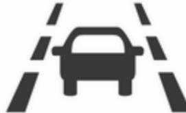
Cuando el testigo de control
