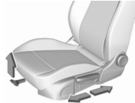
Tire del asidero, deslice el asiento, suelte el asidero. Intente mover el asiento hacia delante y hacia atrás para asegurarse de que el asiento está bloqueado en su posición.
