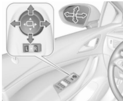
Seleccione el retrovisor exterior correspondiente cambiando el mando basculante al espejo retrovisor izquierdo (**L**) o espejo retrovisor derecho (**R**). Ajuste el espejo correspondiente con el mando de cuatro direcciones.
