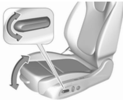
Incline la parte delantera del interruptor hacia arriba / hacia abajo.
