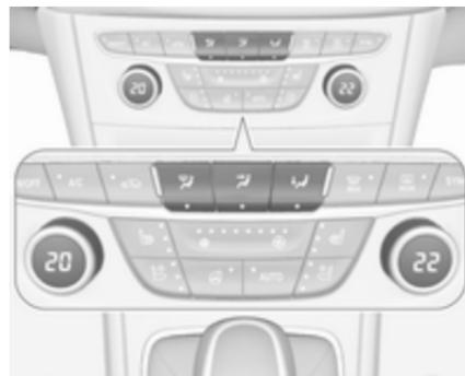
Pulse el botón apropiado para el ajuste deseado. La activación se indica mediante la iluminación del LED del botón.
