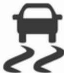
El TC está operativo cada vez que arranca el motor en cuanto se apaga el testigo de control
