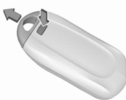
1. Pulse el botón de la parte posterior de la unidad de la llave electrónica y saque la hoja de la llave de la carcasa.
