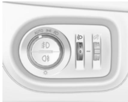
Para adaptar el alcance de los faros a la carga del vehículo y evitar el deslumbramiento: gire la rueda de ajuste
