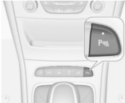
Pulse el botón del asistente de aparcamiento **P**▲ para desactivarlo, el LED del botón se apaga.
