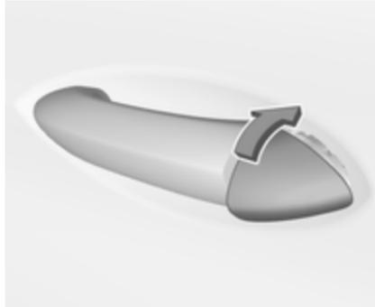
Después del bloqueo, cubra el cilindro de la cerradura con la tapa: introduzca la tapa con el lado inferior en el rebaje, gire y presione la tapa hasta que se acople en el lado superior.
