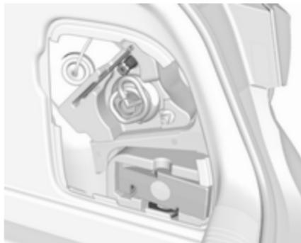
Abra la cubierta de la pared lateral derecha del compartimento de carga. Algunas herramientas y la argolla de remolque se encuentran junto con el juego de reparación de neumáticos en una caja de herramientas.
