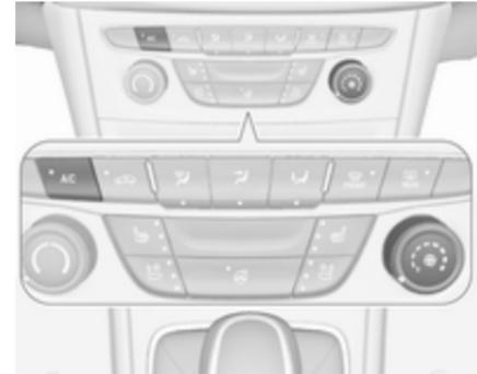
Pulse **A/C** para activar la refrigeración. La activación se indica mediante la iluminación del LED del botón. La refrigeración sólo funciona con el motor en marcha y el ventilador de la climatización conectado.
