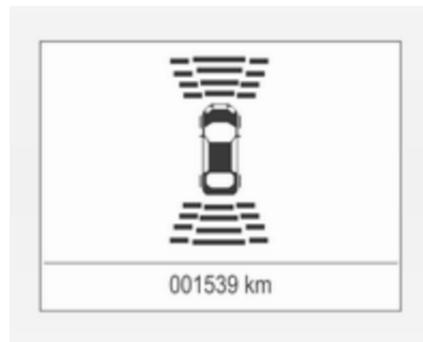
La indicación de distancia puede verse solapada por mensajes del vehículo con mayor prioridad. Después de descartar el mensaje, la indicación de distancia vuelve a aparecer.
