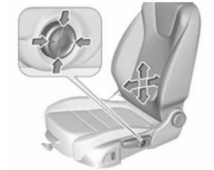
Ajuste el apoyo lumbar con el conmutador de cuatro posiciones para adaptarlo a sus necesidades personales.
