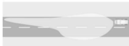
Se activa automáticamente a una velocidad superior a aproximadamente 55 km/h al conducir por zonas rurales. Mejora la iluminación del carril actual y el lateral de la carretera. No se deslumbra a los vehículos que vienen de frente ni a los que se encuentran delante.
