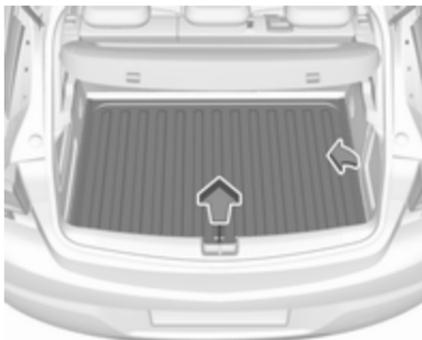
La cubierta del piso trasero se puede retirar. Levante la cubierta en la parte posterior y gire ligeramente a un lado antes de extraer.
