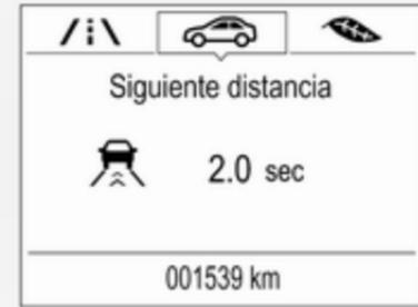
En la pantalla de nivel superior, seleccione el menú **Info** con los botones del volante y pulse **✓** para seleccionar la siguiente indicación de distancia ↻ 119.
