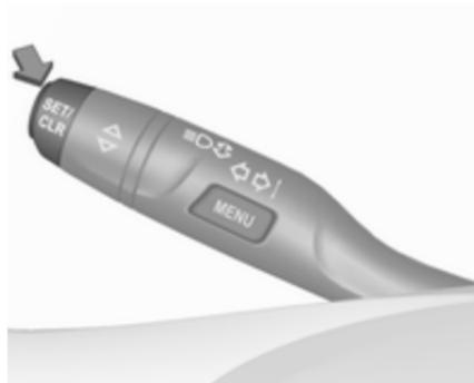
En la pantalla de nivel medio, pulse **SET/CLR** en la palanca de intermitentes para confirmar un mensaje.
