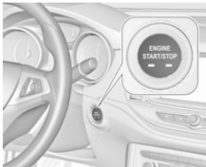
Botón de encendido: pulse **Engine Start/Stop** y suelte.
