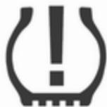
Si se detecta un problema de presión baja de los neumáticos, se indica mediante el testigo de control (⚠) ⇨ 117.
