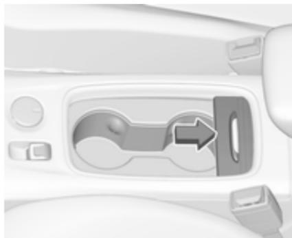
En función de la versión, los portavasos están debajo de una cubierta en la consola central. Deslice la cubierta hacia atrás.
