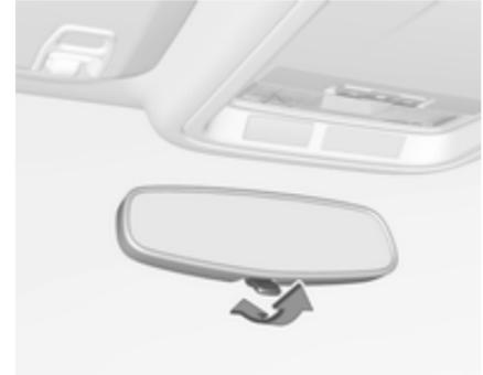
Para reducir el deslumbramiento, ajuste la palanca que hay debajo de la carcasa del espejo.
