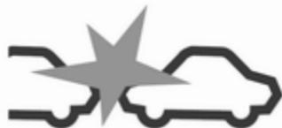
Cuando el tiempo hasta una posible colisión con un vehículo precedente es demasiado corto y la colisión es inminente, aparece el símbolo de alerta de colisión en el centro de información del conductor y el conductor recibe una notificación con una tira
