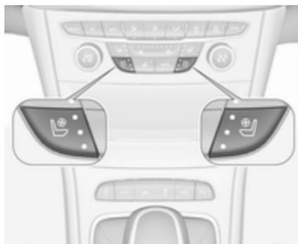
Para ajustar la potencia de ventilación deseada, pulse una o varias veces
