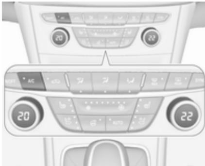
Pulse **A/C** para activar la refrigeración. La activación se indica mediante la iluminación del LED del botón. La refrigeración sólo funciona con el motor en marcha y el ventilador de la climatización conectado.
