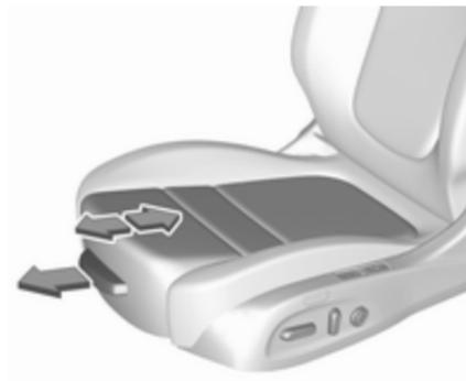
Tire de la palanca y deslice el apoyo para los muslos.
