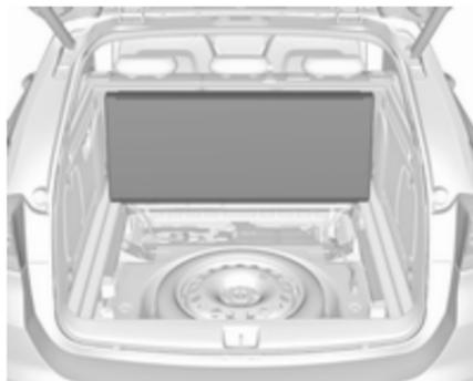
Coloque la cubierta plegada en vertical detrás de los respaldos de los asientos traseros.
