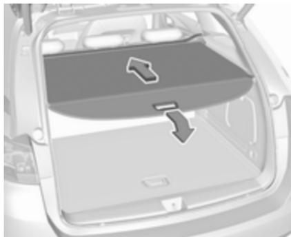
Tire del asa del extremo de la persiana hacia atrás y hacia abajo. Se enrolla automáticamente.
