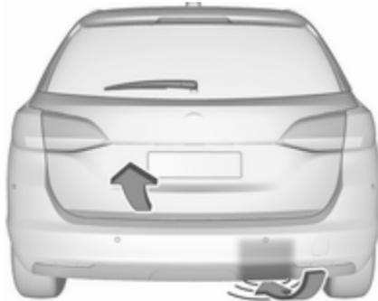
Para abrir o cerrar el portón trasero, mueva hacia delante y hacia atrás el pie debajo del parachoques trasero en la zona que se muestra en la ilustración. Si está equipado con asistente de aparcamiento, se puede reconocer la zona debajo del sensor que se muestra. No mantenga el pie mucho tiempo debajo del parachoques ni tampoco lo mueva lentamente. La llave electrónica debe estar fuera del vehículo a una distancia máxima de un metro aproximadamente del portón trasero.
