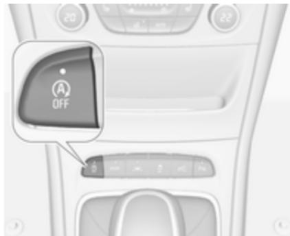
Desactive manualmente el sistema stop-start pulsando **(A) OFF**. Para indicar la desactivación, se ilumina el LED del botón.
