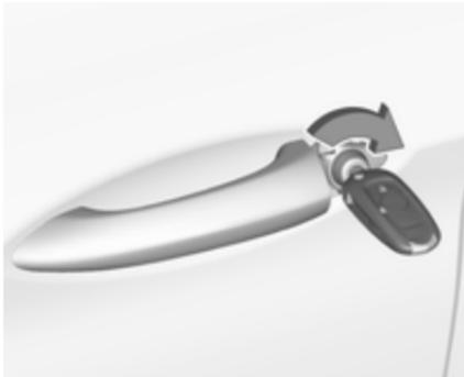
Pulse el pomo de bloqueo interior de todas las puertas excepto la puerta del conductor o pulse
