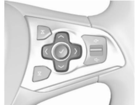
En la pantalla de nivel superior seleccione el menú **Infor.** pulsando < en el volante. Pulse ∨ para seleccionar la página **Índice del est. útil del aceite**.
