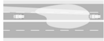
El asistente de luz de carretera incluye un modo especial de autovía. Al conducir a una velocidad superior a 115 km/h por autovías, la luz de carretera se hace más pequeña para evitar deslumbrar al tráfico que viene en dirección contraria. Al adelantar o seguir a vehículos que se encuentran delante, se reduce el deslumbramiento en el espejo de estos vehículos.
