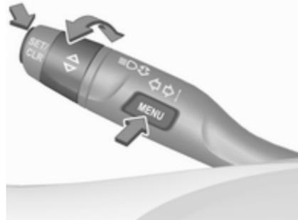
En la pantalla de nivel intermedio seleccione el menú **Configuración** pulsando **MENU** en la palanca del intermitente. Gire la rueda de ajuste para seleccionar la página **Índice del est. útil del aceite**.
