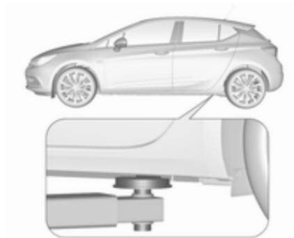
Posición del brazo trasero de la plataforma elevadora bajo el rebaje posterior del estribo.
