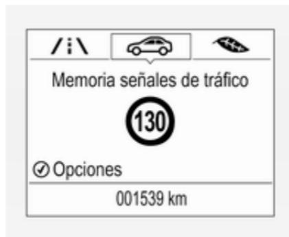
Una vez activada y cuando la página de detección de señales de tráfico no se muestra, se muestran el límite de velocidad y las señales de no adelantar nuevas detectadas como alertas en el centro de información del conductor.
