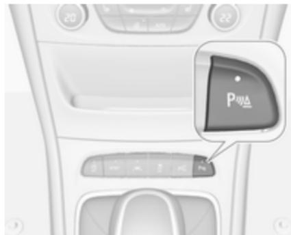
Si está iluminado el LED situado en el botón del asistente de aparcamiento **P**▲, indica que el sistema está listo para funcionar.
