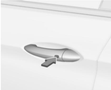
Sistema de llave electrónica: Al desbloquear el vehículo pulsando el botón de la manilla de la puerta se desactiva el sistema de alarma antirrobo.
