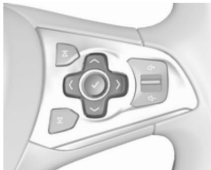
En la pantalla de nivel superior, seleccione el menú **Infor.** con los botones derechos del volante y pulse  $\vee$  o  $\wedge$  para seleccionar la página del asistente de señales de tráfico  $\rightarrow$  119.
