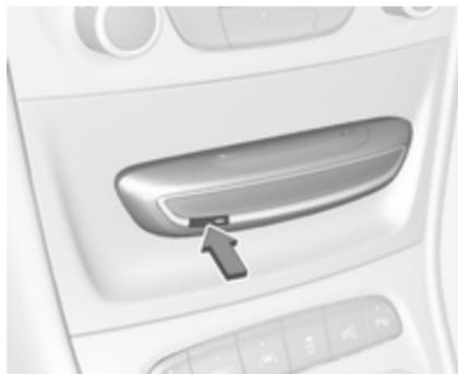
2. Pulse el botón delantero para activar y desactivar el difusor de fragancia. El LED indica activación.
