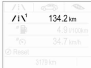
Seleccione la página **Infor.** pulsando **Menu** de la palanca de los intermitentes. Gire la rueda de ajuste en la palanca del intermitente y seleccione **Viaje A** o **Viaje B**. Cada cuentakilómetros parcial se puede poner a cero pulsando **SET/CLR** en la palanca durante unos segundos en la página correspondiente.
