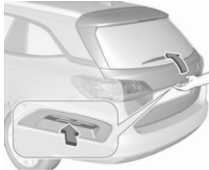
Para abrir el portón trasero, pulse el interruptor de panel táctil situado debajo de la moldura hasta que el portón trasero empiece a moverse. Si el
