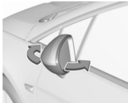
Para la seguridad de los peatones, los retrovisores exteriores basculan de su posición de montaje normal al recibir impactos de una determinada
