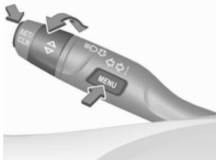
Pulse **MENU** para cambiar entre los menús principales o para volver de un submenú al siguiente nivel superior del menú.
