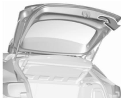
Utilice una de las manillas interiores. No pulse el interruptor del panel táctil al cerrar ya que se volverá a desbloquear el portón trasero.
