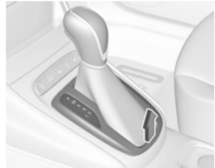
2. Suelte el revestimiento de la palanca selectora de la consola central. Introduzca un dedo en la cavidad de piel debajo de la palanca selectora y presione el revestimiento hacia arriba. Gire el revestimiento hacia la izquierda.
