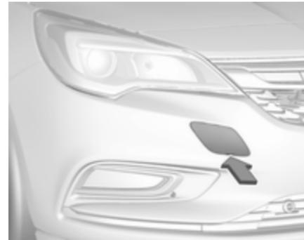
Introduzca un destornillador en la ranura de la parte inferior de la tapa. Suelte la tapa moviendo cuidadosamente el destornillador hacia abajo.
