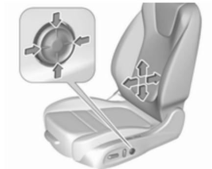
Ajuste el apoyo lumbar con el conmutador de cuatro posiciones para adaptarlo a sus necesidades personales.
