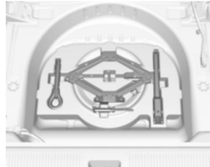
El gato, la argolla de remolque y las herramientas se encuentran en la caja de herramientas debajo de la rueda de repuesto. Rueda de repuesto ⇨ 273.
