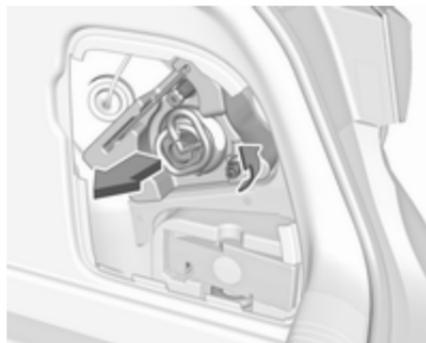
2. Vehículos con juego de reparación de neumáticos: Para reemplazar las bombillas del lado derecho, afloje primero la tuerca de plástico y saque la inserción con la botella de sellante.
