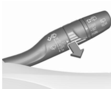
Tire de la palanca. Se pulveriza líquido de lavado sobre el parabrisas y el limpiavientos se realiza el barrido varias veces.
