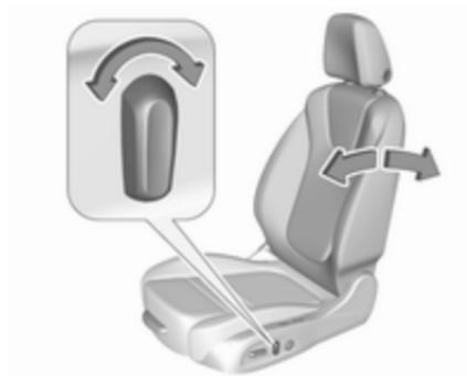
Incline el interruptor hacia delante / hacia atrás.
