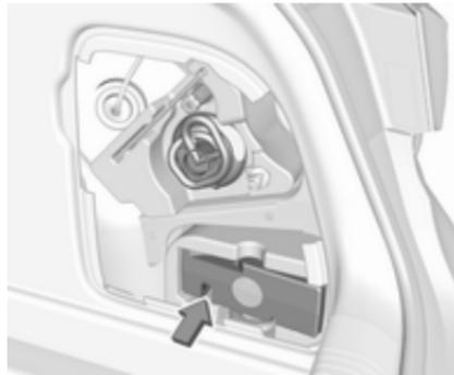
En la versión 5 puertas, el juego de reparación de neumáticos está en el lado derecho del compartimento de carga, detrás de una tapa.
