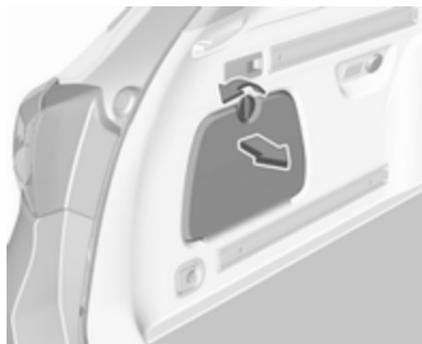
1. Suelte y abra la cubierta del lado correspondiente.
