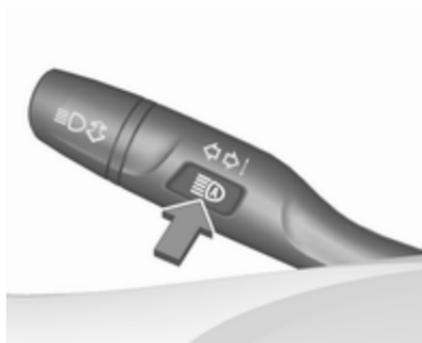
Active el asistente de luz de carretera pulsando
