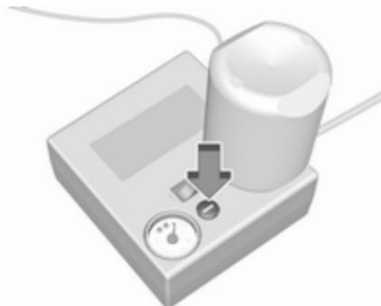
Si la presión prescrita no se alcanza en un plazo de diez minutos, desconecte el juego de reparación de neumáticos. Haga girar el neumático una vuelta completa. Vuelva a conectar el juego de reparación de neumáticos y continúe el proceso de inflado du-
