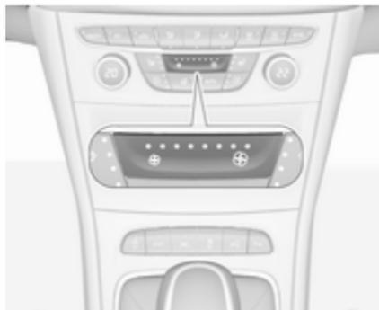
Pulse el botón izquierdo para disminuir la velocidad del ventilador o el botón derecho para aumentarla. La velocidad del ventilador se indica mediante el número de LED del botón.
