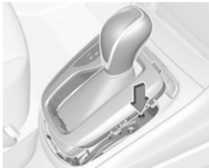
3. Introduzca una barra pequeña (por ejemplo, un lápiz o un destornillador) en la apertura cerca de la palanca selectora. Presione la barra verticalmente y saque la palanca selectora de **P**. Si se vuelve a acoplar esta posición, se volverá a bloquear la palanca se-
