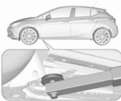
Posición del brazo trasero de la plataforma de elevación en los bajos del vehículo.
