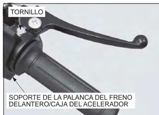
Desconecte el cable del acelerador y retire el soporte de la palanca del freno delantero/caja del acelerador del lado inferior.
