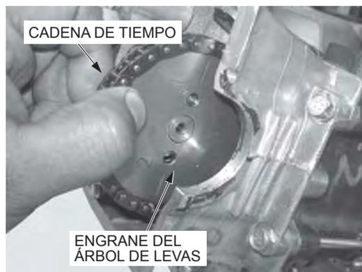
Alinee los orificios de los tornillos del árbol de levas y del engrane del árbol de levas, e instale los tornillos del engrane.
