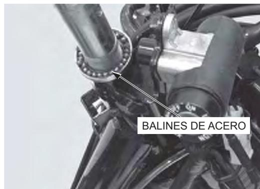
Retire los balines de acero inferiores (19) de la cabeza de la dirección.
