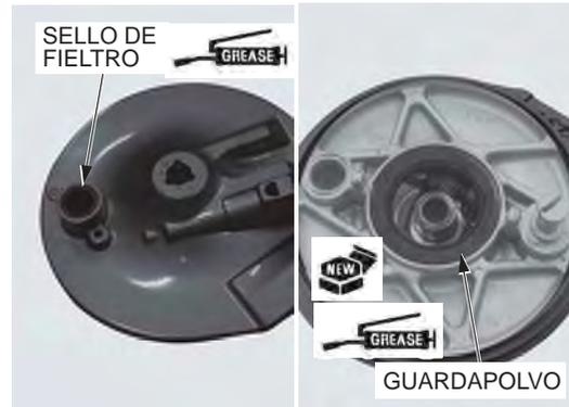
Aplique grasa en la superficie deslizante de la leva del freno e instálela en el panel del freno.
