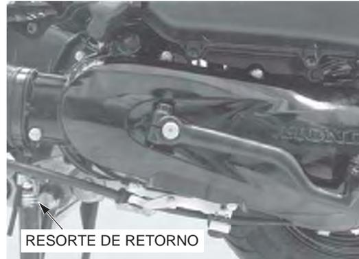
Retire la chaveta, la arandela, el tornillo pivote del soporte central y el soporte central.
