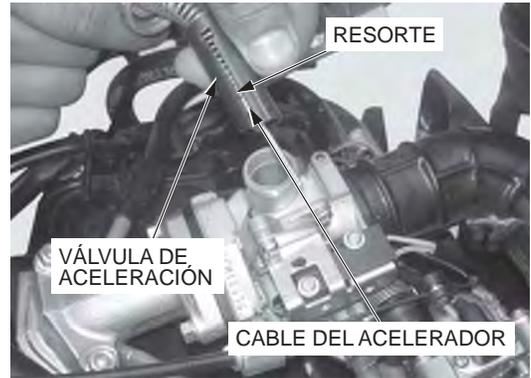
Instale la válvula de aceleración en el cuerpo del carburador.
