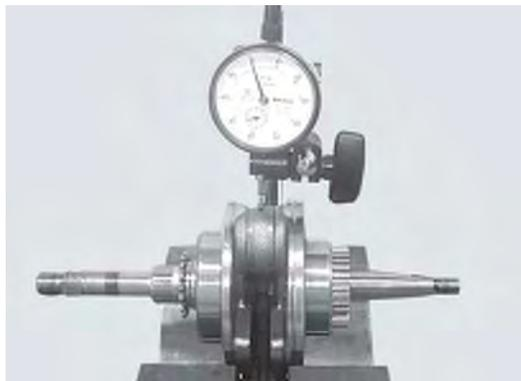
Coloque el cigüeñal sobre bloques-V y mida el descentramiento con un reloj indicador. El descentramiento real es 1/2 de la lectura total del indicador.
