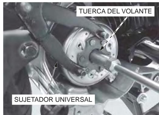
Retire el volante con el extractor de volante.
