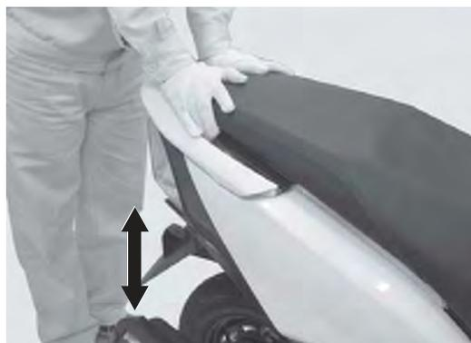
Levante del piso la parte trasera de la motoneta, colocándola sobre su soporte central.
