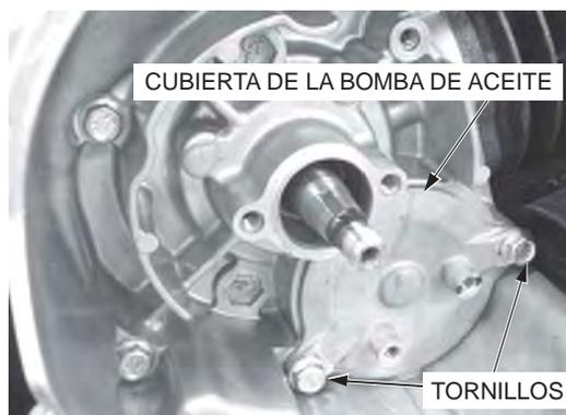
Atornille los dos tornillos de 5 mm en los orificios roscados de la cubierta de la bomba de aceite y jale la cubierta hacia fuera del cárter derecho.
