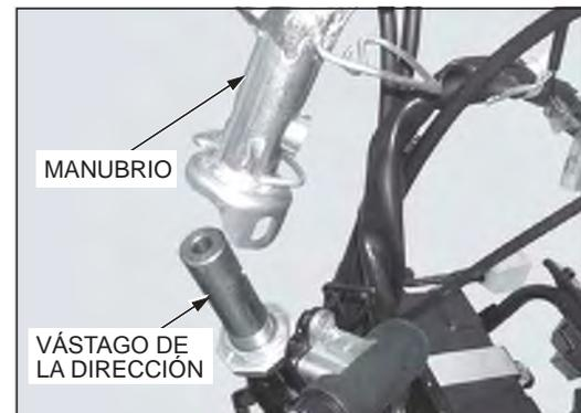
Alinee el orificio del tornillo del poste del manubrio con el orificio del vástago de la dirección e inserte el tornillo de presión (1) del poste del manubrio y el collarín desde el lado izquierdo, y también inserte un collarín desde el lado derecho.
