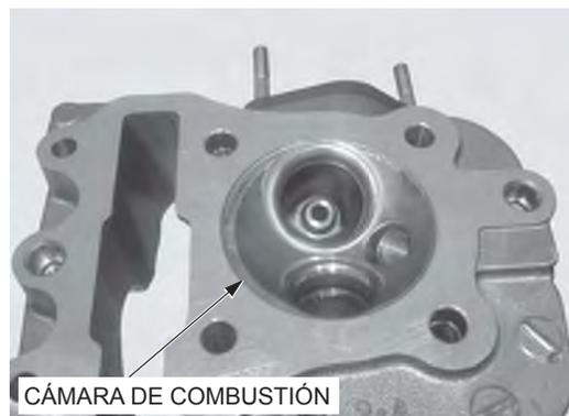
Compruebe con una regla y un calibrador de lámina, que no haya deformación de la cabeza de cilindro.
