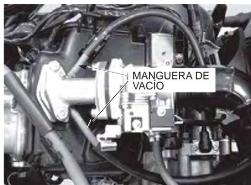
Desconecte la manguera de combustible del carburador y de la manguera de vacío.
