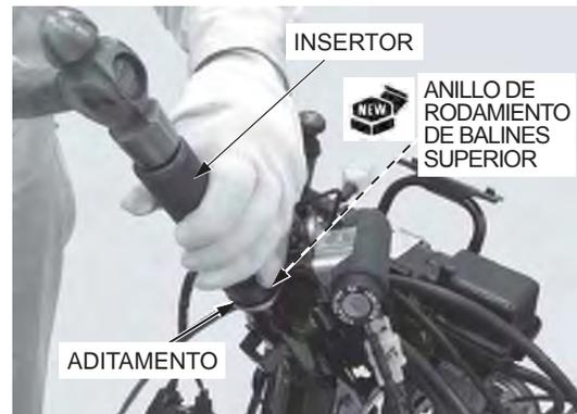
Inserte anillos de rodamiento de balines inferiores nuevos en la cabeza de la dirección, utilizando la herramienta especial.
