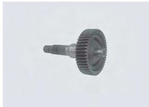
Revise que no haya desgaste excesivo, daños o señales de atascamiento en el eje de la contramarcha.
