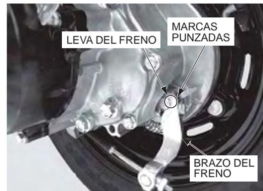
Instale y apriete el tornillo del brazo del freno (1).
