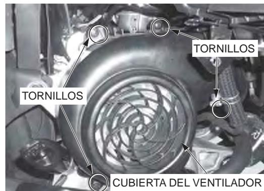
Retire los tornillos (3) y el ventilador.
