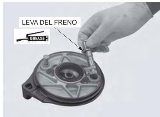
Instale el resorte de retorno, insertando su extremo en el orificio del panel del freno.
