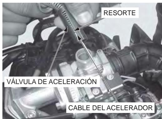
Retire la placa de fijación de la válvula y la aguja de la esprea.
