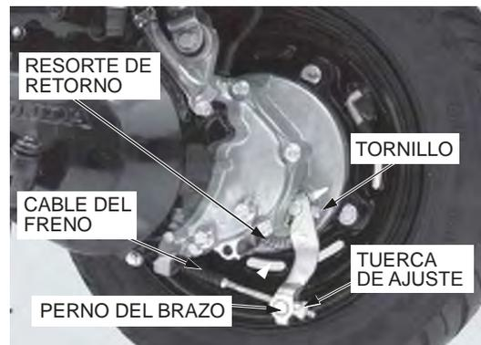
Aplique grasa en la leva del freno y el perno de anclaje.
