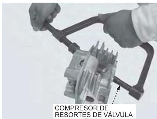
Retire el compresor de resortes de válvula, luego quite el retén, el resorte y la válvula.
