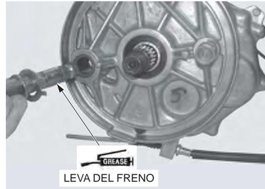
Instale el brazo del freno en la leva del freno, alineando las marcas punzadas del brazo y la leva.
