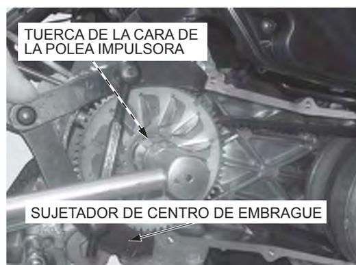
Retire la arandela y la aleta de la cara de la polea impulsora y la cara impulsora.
