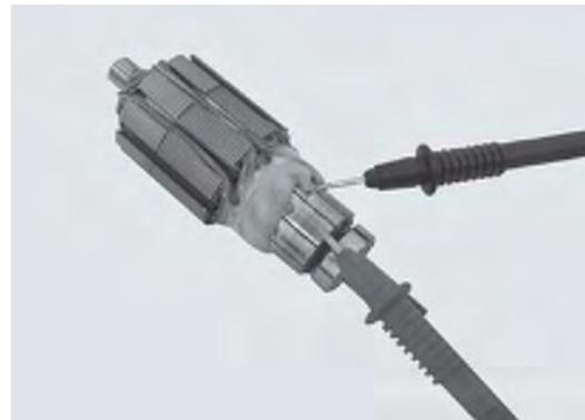
Revise si hay continuidad entre cada barra del conmutador y el eje del inducido.
