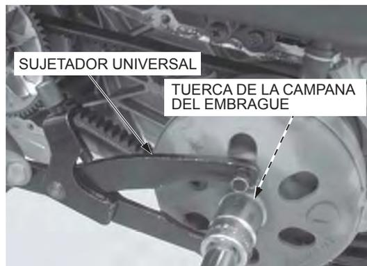
Retire el conjunto del embrague/polea impulsada y la banda de transmisión.
