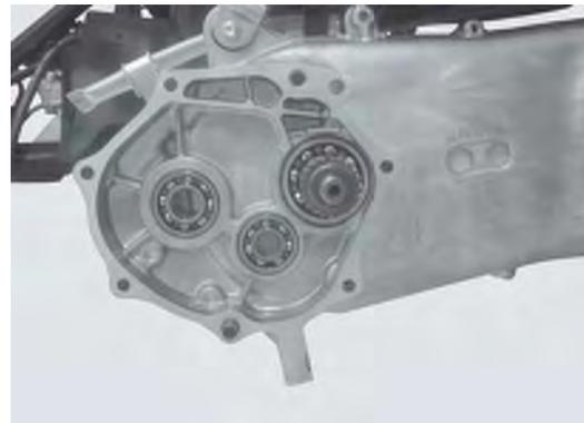
Revise que no haya desgaste excesivo, daños o señales de atascamiento en el eje final.
