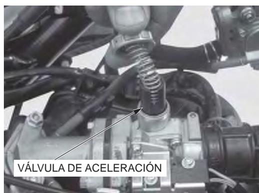
Retire el cable del acelerador de la válvula de aceleración, mientras comprime el resorte de la válvula de aceleración.
