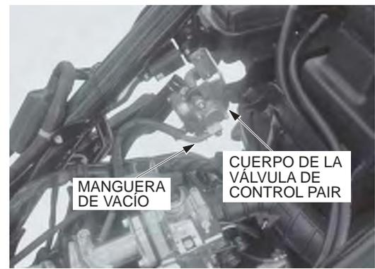
Desconecte la manguera del filtro de aire PAIR.
