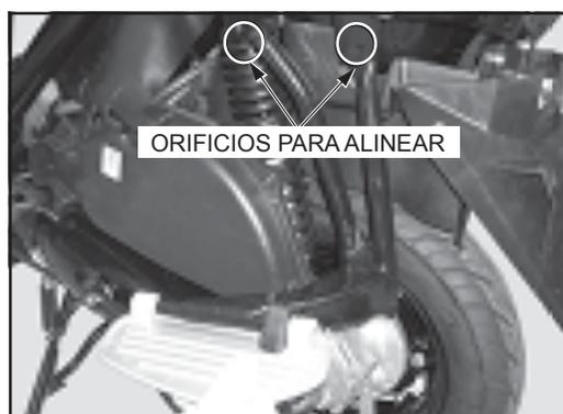
Inserte los tornillos (2) y apriete las tuercas (2) al torque especificado.
