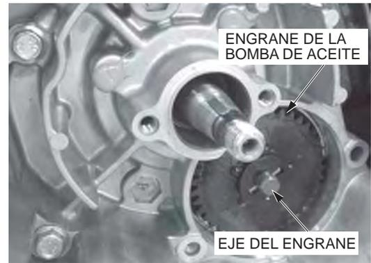
Aplique grasa en el orificio del eje del engrane de la bomba en la cubierta de la bomba de aceite.
