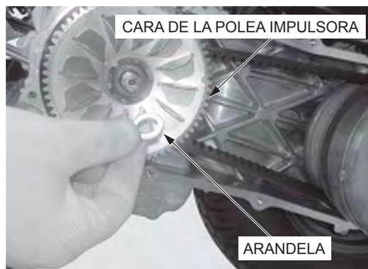
Retire del cigüeñal la arandela y la banda de transmisión.
