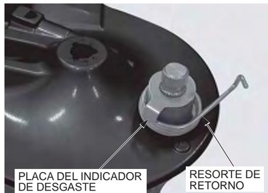
Instale el brazo del freno sobre la leva del freno, alineando las marcas punzadas del brazo y de la leva.
