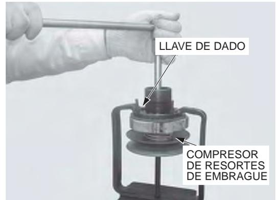
Instale la banda de transmisión y el conjunto del embrague/polea impulsada.
