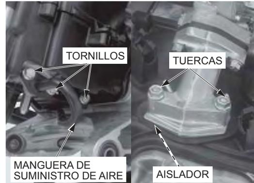
Retire los tornillos (3), el tornillo (1), la cubierta de admisión y la cubierta de escape.
