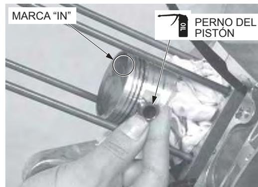
Instale clips del perno del pistón nuevos en las ranuras del orificio del perno.
