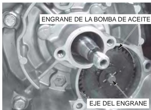
Retire los tornillos de montaje (2) de la bomba de aceite y el conjunto de la bomba de aceite.
