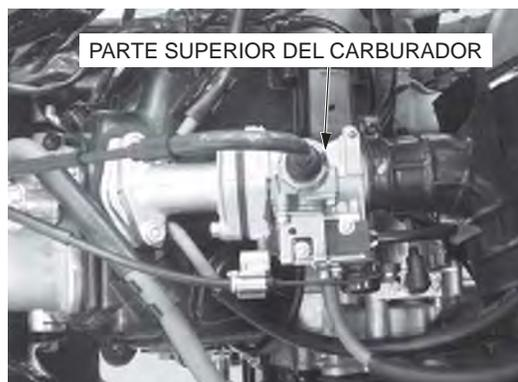
Retire del carburador la parte superior del carburador y la válvula de aceleración.
