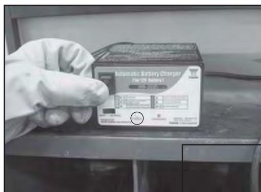
seguido del indicador LED amarillo que indica que la batería se está cargando adecuadamente.
