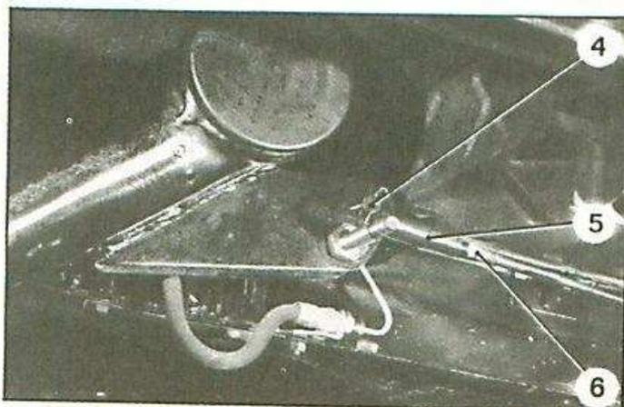
11. Montar el brazo de eje sobre la traviesa:
