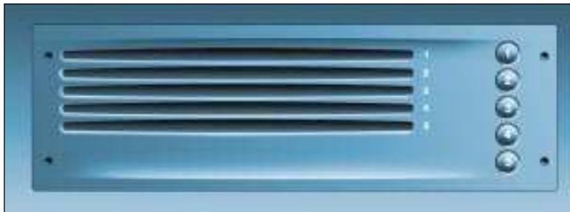
Está situado en la parte central del panel de instrumentos, debajo del autorradio y puede contener 5 discos.
