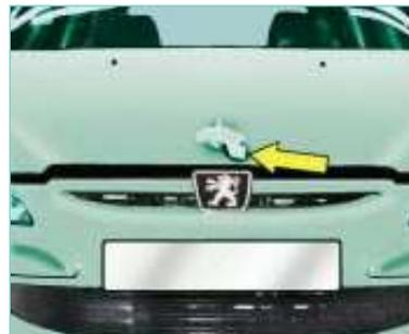
**Desde el exterior :** levante el mando, levante el capó y fije el soporte para mantener el capó abierto.
