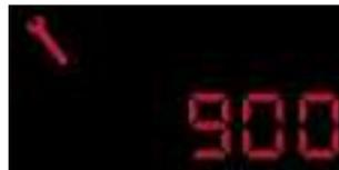
5 segundos después de poner el contacto, el totalizador kilométrico vuelve a su funcionamiento normal y la llave se queda encendida.
