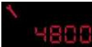
5 segundos después de poner el contacto, el totalizador kilométrico vuelve a su funcionamiento normal y la pantalla indica el kilometraje total y parcial.
