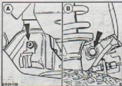
Extracción de montaje del motor. A: Emplazamiento de larguero. B: Tornillo de panel.
