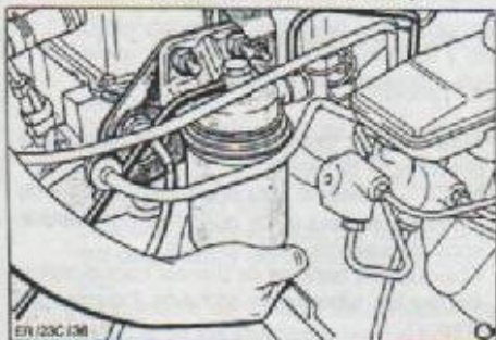
Desenrosque el elemento del filtro del cuerpo del mismo.
