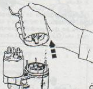
Separación de la carcasa de la caja de extremo de transmisión.
