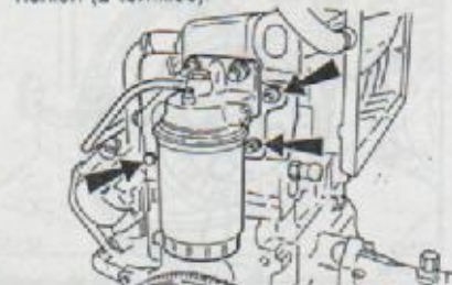
Montaje del filtro de aceite.
