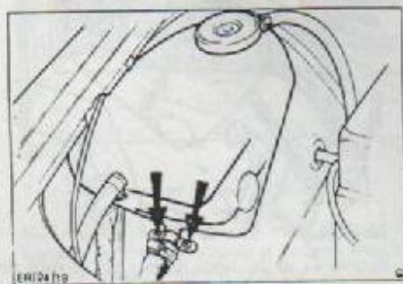
Tornillos de sujeción del tanque de desgasificación en los variantes de 1,3 y 1,6 litros.
