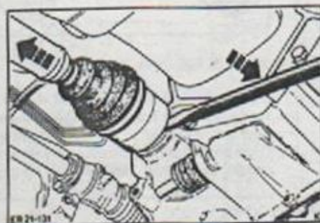
Insertión de palanca entre caja de cambios y junta de velocidad constante.
