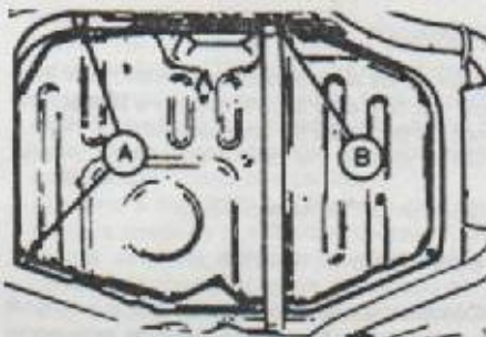
A: Tornillos del depósito de combustible. B: Tornillos de sujeción del fleje del depósito de combustible.
