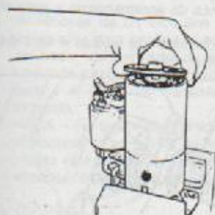
Extracción de la placa de extremo del colector.
