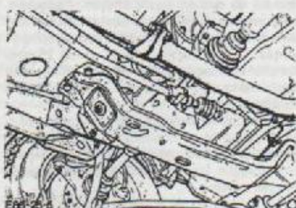
Conexión del tubo de bajada al silenciador delantero
