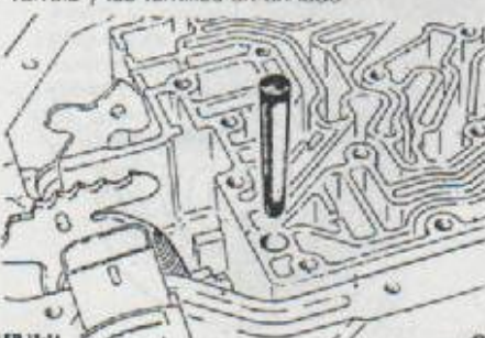
Extracción del filtro del regulador centrífugo.
