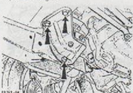
Aflojamiento del montaje trasero de la caja de cambios (se señala con la flecha los accesorios de retención).
