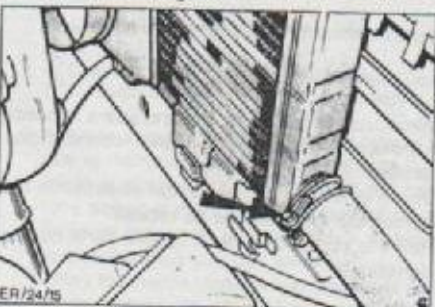
Abrazadera de retención del manguito inferior del radiador.
