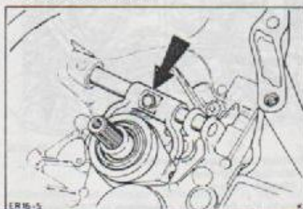
Acoplamiento de horquilla de cojinete de desembrague al eje de desembrague.
