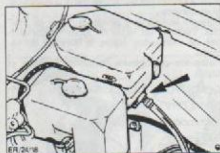
Abrazadera de sujeción inferior de la botella de rebose en los variantes de 1,1 litros, sin instalación de valeros.
