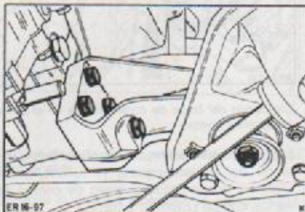
Montaje de caja de cambios delantero
