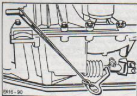
Herramienta auxiliar sujetando en posición el eje selector.
