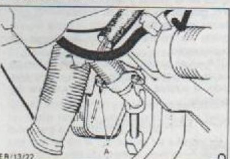
Montaje inferior de la columna de dirección. A: Tornillo de retención.
