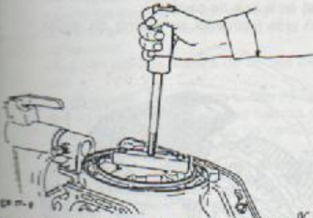
Extracción de la bomba de aceite con el martillo de percusión 15.011 y el acoplamiento de puente 17.016
