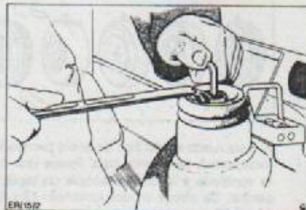
Extracción de la tuerca del montaje superior del amortiguador.
