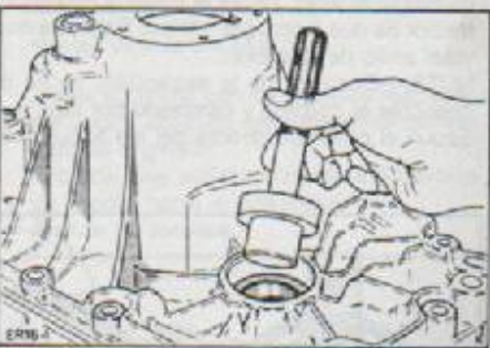
Saque cojinete y muelles de diafragma de sección corta alojamiento.
