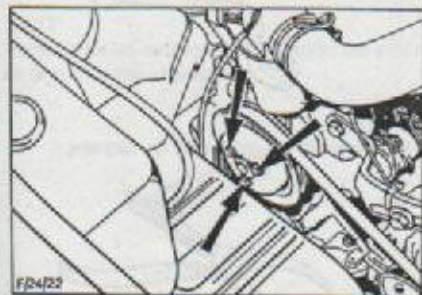
Tornillos de sujeción de la polea de la bomba.
