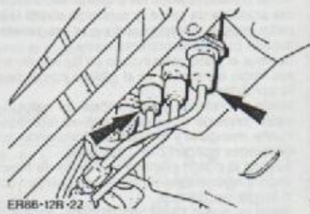
Desconexión de la tubería hidráulica de alimentación del soporte.
