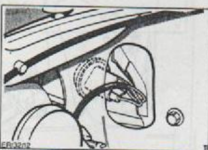
Bombilla de intermitente retirada por el rebajo de la carrocería.
