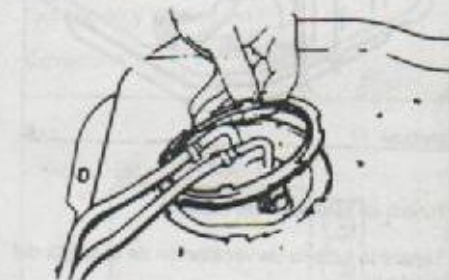
Montaje del anillo de bloqueo de la unidad aforadora del depósito de combustible.
