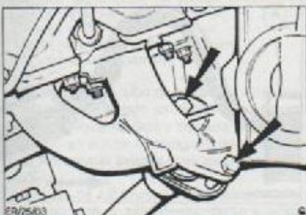
Tornillos de sujeción de tubo descendente a colector en las variantes de 1,1 litros.
