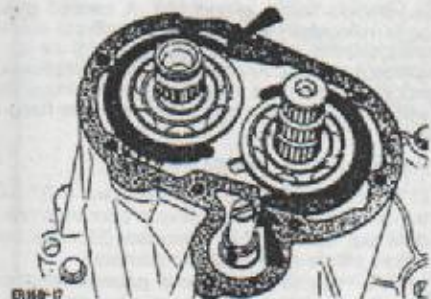
Alineación de anillos de presión sobre la junta de la tapa.
