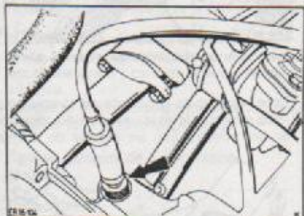
Desenrosque del cable de la caja de cambios del velocímetro.
