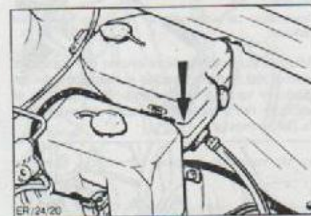
Marca de nivel máximo de refrigerante en la botella de rebose.
