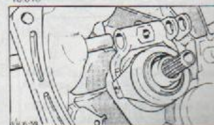
ER 16-42 Montaje de eje de desembrague con horquilla y cojinete de empuje.
