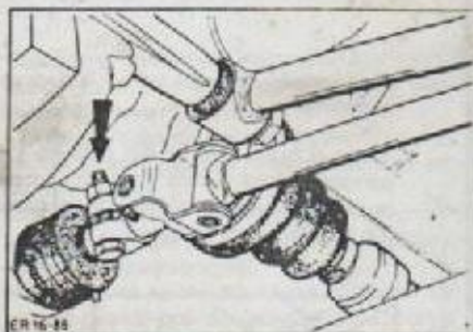
Tornillo de sujeción de tirante de cambio.
