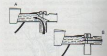
Funcionamiento de la charnela de control del filtro de aire.
