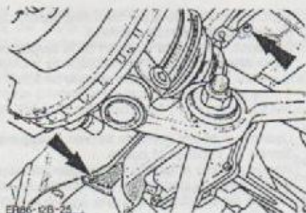
Montaje del revestimiento de larguero.
