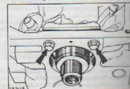
Sujeción de placa de empuje de árbol de levas.
