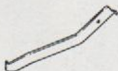
21.096 Extractor de retén de aceite delantero y trasero del cigüeñal.
