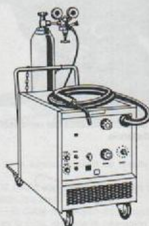
Equipo de soldadura metálica en atmósfera de gas inerte (MIG)
