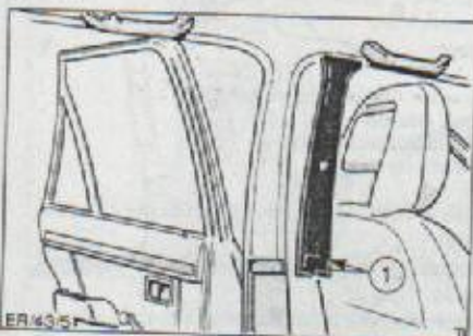
Sección superior del tapizado del montante «B». 1: Emplazamiento de la cinta.
