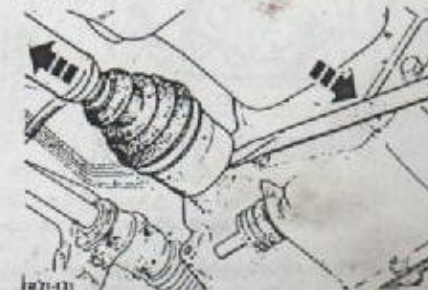
Colocación de una palanca entre la junta homocinética y la caja de cambio.
