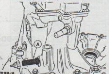
Giro hacia la derecha de la varilla de cambio con un destornillador, empuje hacia abajo y apriete el tornillo de la abrazadera.
