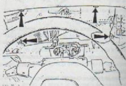
Puntos de fijación del grupo de instrumentos.
