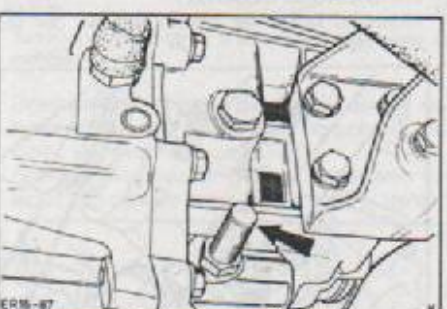
Mecanismo de bloqueo del eje selector.
