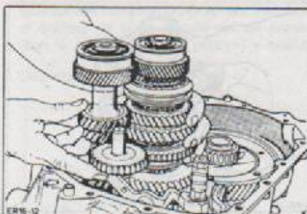
Extracción de eje secundario, eje primario y piñón de marcha atrás de la caja
