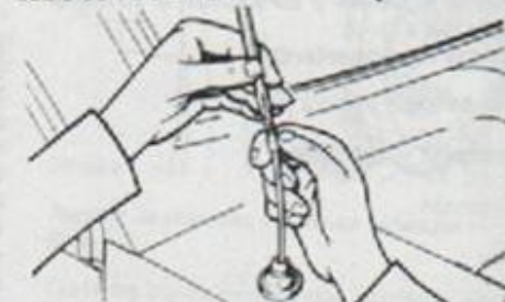
Introducción de la sección interna/cable de transmisión en los tubos telescópicos.
