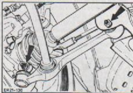
Colocación del brazo de control de vía en el portamangueta y cuerpo.
