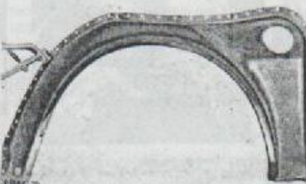
Punzonado de brida soldada con puntos de la nueva mitad de pasarruedas.
