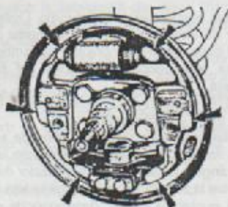
Lubricación de los seis puntos de contacto de la placa portafrenos con grasa «Thermopaul 1».
