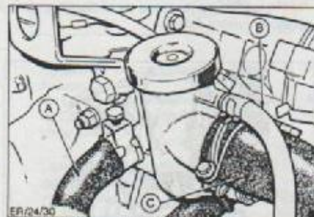
Conexiones de manguitos del alojamiento del termostato.
