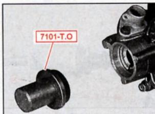
Desmontar la junta de salida del diferencial; sustituirla por una nueva; servirse del útil 7101-T.O; untar con grasa los labios de la junta.
