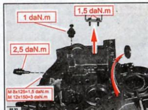
Quitar el soporte de retención del muelle del eje de selección, el interruptor de luz de M.A., el respirador de la caja y la plaqueta magnética.
