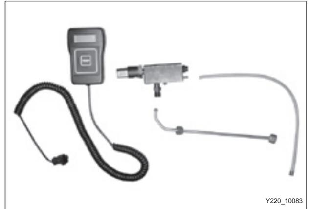
2. Retire el tubo de suministro de combustible de alta presión y coloque el conducto cerrado incluido en el conjunto de herramientas.
