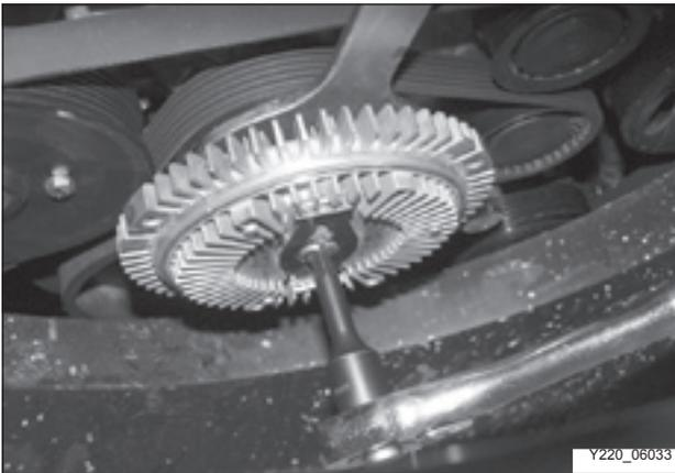
5. Desatornille el perno central y retire el embrague del ventilador mientras sujeta la correa con una herramienta especial.
