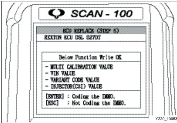
7. Si la calibración múltiple se completa correctamente, aparece la pantalla “ECU REPLACE (STEP 5).
