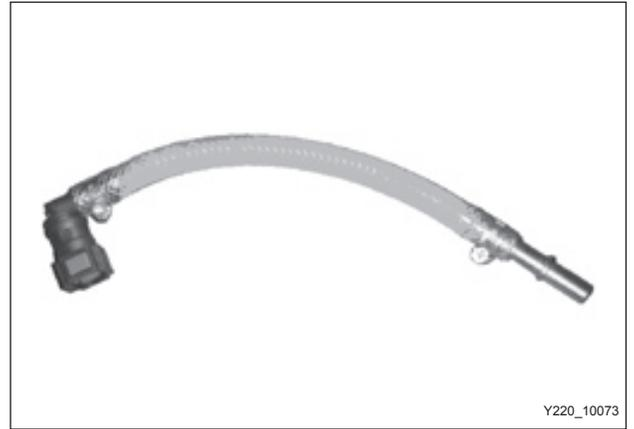
3. Desconecte el conector principal que conecta la bomba de cebado con el filtro del combustible y coloque los dos conectores de la herramienta especial en los conductos de la bomba del combustible y de la bomba de cebado.
