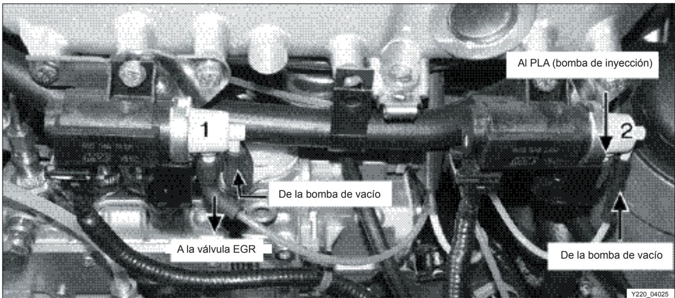
1. Modulador de vacío para la válvula de control de EGR
