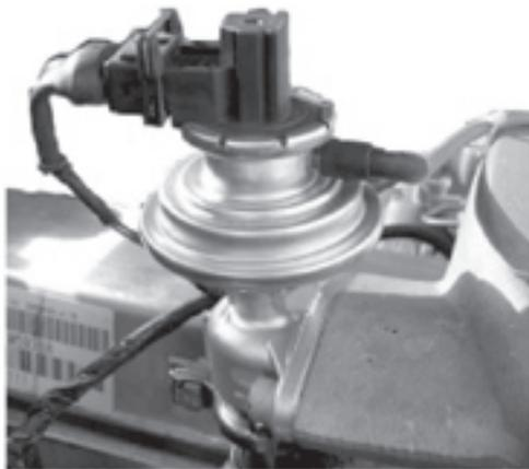
Sistema del aspirador de EGR del motor IDI
