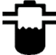
Cuando el nivel del agua dentro del separador de agua, en el filtro de combustible, excede un cierto nivel (aprox. 39 cc), se enciende esta luz de advertencia y se produce un sonido de zumbido.
