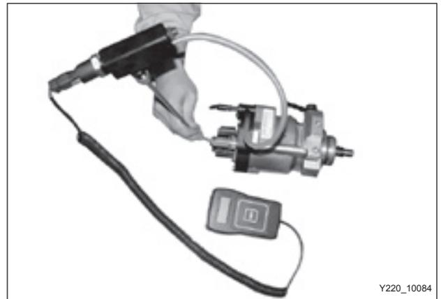
3. Coloque el extremo opuesto del conducto cerrado en el conducto de combustible de la comprobación.
