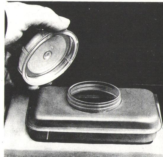
Fig. 41.- Revisión del nivel de líquido de freno y embrague.
