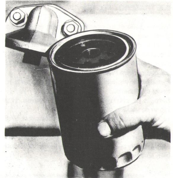
Fig. 42.— Filtro de aceite del motor.
