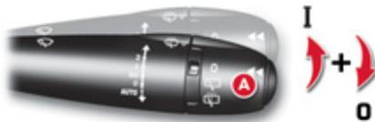
La función se neutraliza manualmente desplazando el mando **A** hacia arriba y volviendo a colocarlo en la posición "0".
