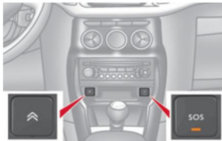
Este dispositivo permite realizar una llamada de urgencia o de asistencia a los servicios de emergencia o a la plataforma CITROËN. Para más detalles sobre la utilización de este equipamiento, remítase al capítulo "Audio y Telemática".
