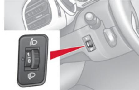
Para no molestar a los demás usuarios de la vía, los faros deben estar regulados en altura, en función de la carga del vehículo.
