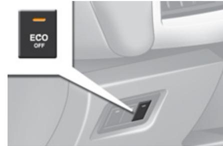
Pulse el mando "ECO OFF" en cualquier momento para neutralizar el sistema. Esto se indica mediante el encendido del piloto del mando, acompañado de un mensaje en la pantalla.
