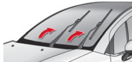
Esta posición permite levantar las escobillas para el estacionamiento en invierno o para poder limpiarlas o cambiarlas sin dañar el capó. En el siguiente minuto después de cortar el contacto, cualquier acción en el mando del limpiaparabrisas posiciona las escobillas en vertical. Para volver a colocar las escobillas después de la intervención, ponga el contacto y manipule el mando.
