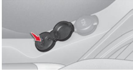
El puerto USB está situado en el módulo "AUX" de la consola central. Permite conectar dispositivos portátiles, como un reproductor digital de tipo iPod® de 5ª generación y siguientes o una llave USB. El sistema lee los archivos de audio (en formato mp3, ogg, wma, wav...) y los transmite al autorradio para ser escuchados a través de los altavoces del vehículo. El usuario puede manejar los archivos con los mandos del volante o del frontal del autorradio y visualizarlos en la pantalla multifunción.
