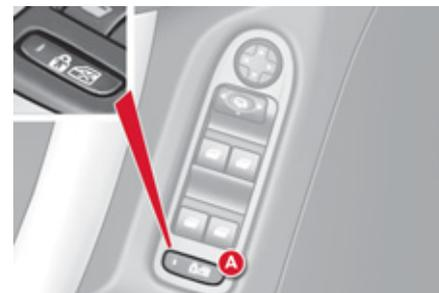
El encendido del testigo A indica la neutralización de los mandos de las puertas y de los elevavidrios traseros.
