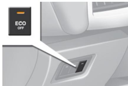
En caso de fallo de funcionamiento del sistema, el piloto del mando **"ECO OFF"** parpadea y luego se enciende de manera fija.
