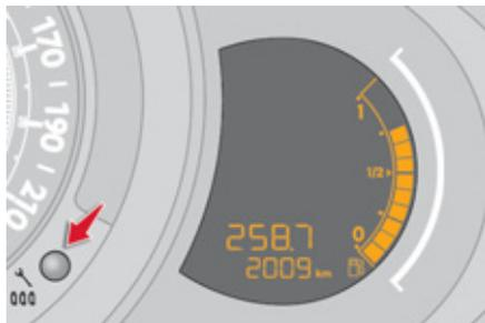
Los kilometrajes total y parcial se muestran durante treinta segundos al cortar el contacto, al abrir la puerta del conductor y al bloquear o desbloquear el vehículo.
