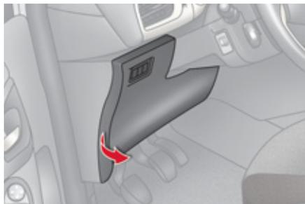
La pinza de extracción y los emplazamientos reservados a los fusibles de repuesto están situados en la cara interior de la tapa de la caja de fusibles del salpicadero.
