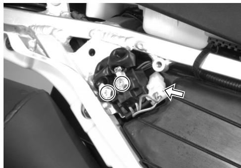
Aplique 12 V a los terminales y compruebe la continuidad entre los terminales positivo y negativo con el polímetro. Si el relé de arranque hace clic y hay continuidad, el relé está bien.
