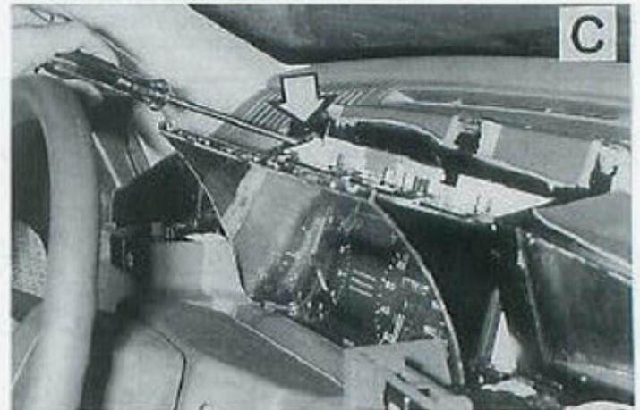
A. Fijaciones de la visera - B. Desmontaje de la visera - C. Desmontaje del cuadro de instrumentos
