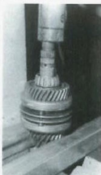
Extracción con prensa del eje primario del conjunto de rodamiento y piñón de 4º, desplazable de 3º-4º y piñón de 3º
