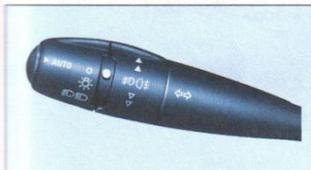
Los vehículos equipados con este mando : las luces de posición y de cruce se encienden automáticamente en caso de poca luminosidad, así como en caso de funcionamiento continuo de los limpiaparabrisas.
