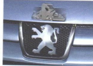
**Desde el exterior :** levante el mando, levante el capó y fije el soporte para mantener el capó abierto.
