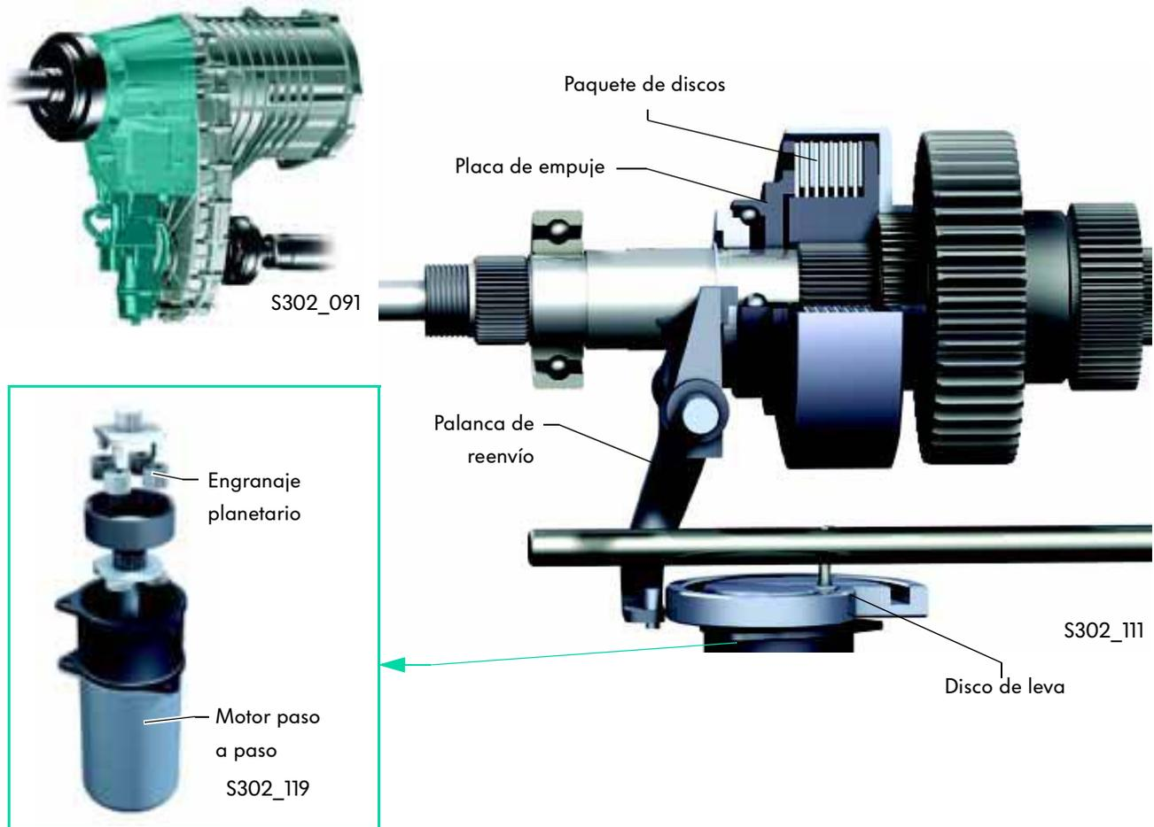
El bloqueo del diferencial central es un sistema de discos accionado mediante un motor eléctrico.
