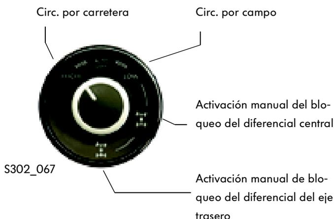
La posición **"HIGH"** del mando está indicada para la circulación por carretera (On-Road). Los bloqueos de los diferenciales se activan automáticamente en función de la situación (p. ej. si el firme está helado). En estos casos, el bloqueo no se cierra al 100 %, como sucede con un acoplamiento tipo garra, sino que se aplica de forma suave. La reductora no está conectada.
