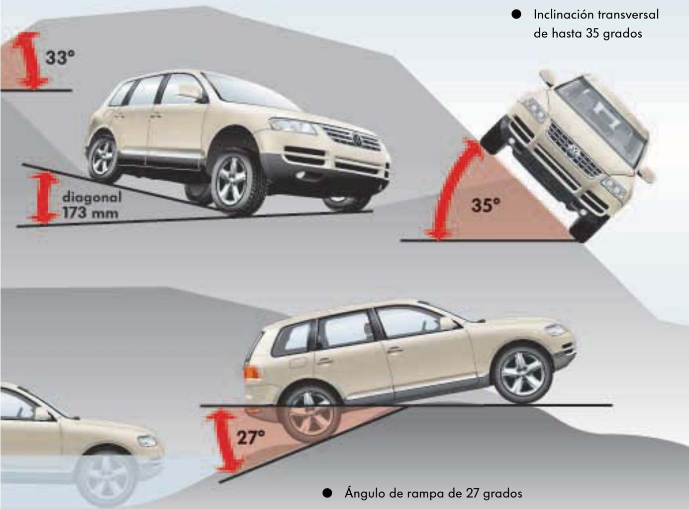
● Inclinación transversal de hasta 35 grados
