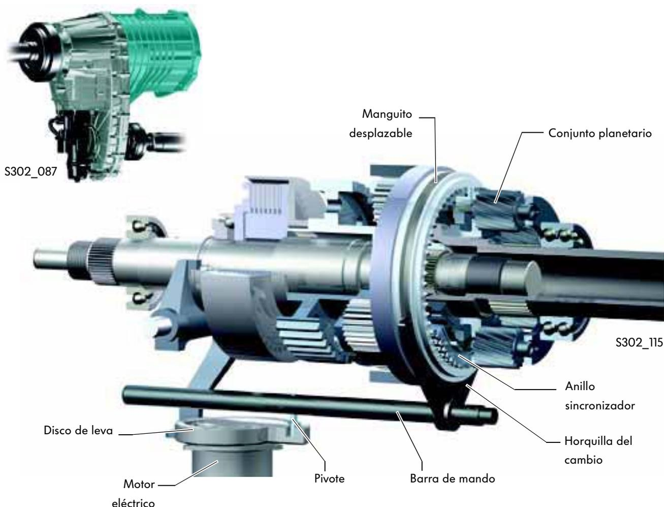
Acoplando o separando el conjunto planetario se conecta o desconecta la reductora de 2,7:1. Un motor eléctrico acciona el disco de leva. Este disco de leva tiene una pista de curva interior con la que, por medio de un pivote, se desplaza una barra de mando con horquilla. La horquilla engrana en un manguito desplazable. La parte interior de este manguito es la corona de un conjunto planetario, que se conecta o desconecta asistido por anillos sincronizadores.
