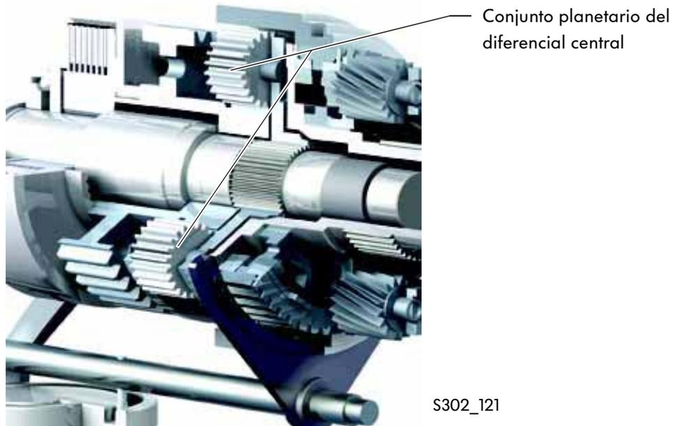
Mediante una bomba de aceite impulsada por el árbol primario se suministra aceite a todos los puntos de lubricación a través del árbol ahuecado.
