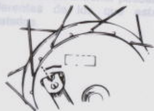
Fig. B La línea de extensión de la marca índice está fuera de la gama.
