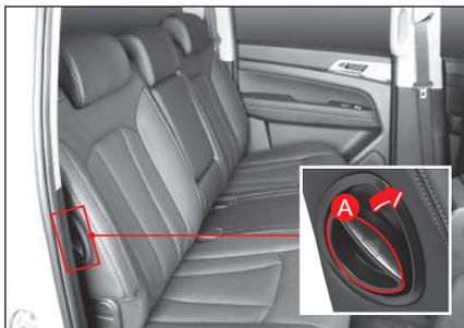
2. Pulse la palanca de liberación de espaldar de asientos posteriores (A) hacia adelante para liberar el espaldar del asiento.
