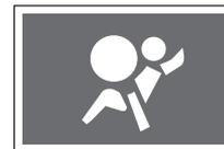
La luz de advertencia del airbag se enciende al activar el interruptor de encendido (posición ON), y se apaga al verificar el correcto funcionamiento del sistema.
