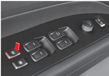
Al presionar el interruptor de BLOQUEO/DESBLOQUEO de puerta (botón tipo resorte) con todas las puertas, incluida la puerta trasera, bloqueadas, el estado de las puertas cambia entre desbloqueadas y bloqueadas cada vez que se presione el interruptor.
