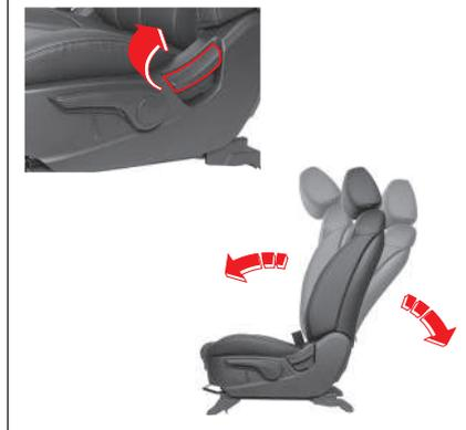
Para cambiar el ángulo de reclinación del respaldo del asiento, inclínese un poco hacia delante y levante la palanca. Luego, reclínese hacia atrás y libere la palanca en la posición deseada. Después de realizar este ajuste, asegúrese de que la palanca vuelva a su posición original y que el respaldo del asiento quede bloqueado.
