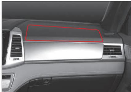
El airbag del pasajero está ubicado en la sección frontal del tablero. Este airbag protege la cabeza del pasajero delantero ante una colisión frontal.
