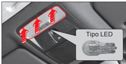
1. Gire el interruptor de luces interiores hacia la posición "OFF", y retire la cubierta utilizando un destornillador de cabeza plana.
