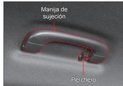
Hay manijas de sujeción en la parte superior del lado del conductor y en los asientos posteriores. Las manijas de sujeción para los asientos posteriores incorporan un perchero.
