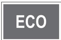
El indicador de modo ECO está disponible en vehículos con transmisión automática (A/T). Este indicador se enciende en el panel de instrumentos cuando el motor de arranque se ajusta en la posición "IGN ON".
