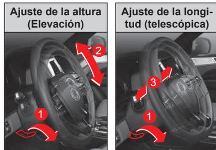
Pulse la palanca de liberación/bloqueo del volante (1) para elevar (2) o ajustar la profundidad (3) del volante. Ajuste el volante en la posición deseada y bloquéelo cerrando la palanca.
