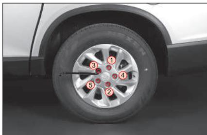
7. Luego coloque el neumático de auxilio y ajuste temporariamente las tuercas para que el neumático de auxilio no quede suelto.
