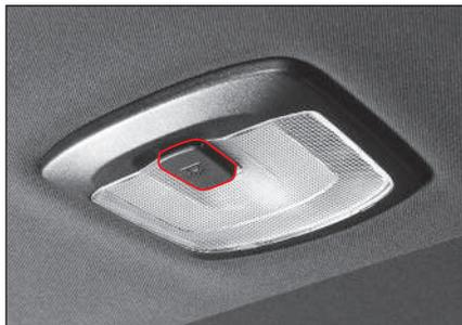
Al presionar el interruptor de luces interiores centrales se encienden las luces interiores centrales. Al presionar de nuevo el interruptor se apagan las luces interiores centrales. La luz interior central se enciende al abrir la puerta independientemente de la operación del interruptor de luz interior central siempre y cuando se pulse el interruptor de operación combinada.
