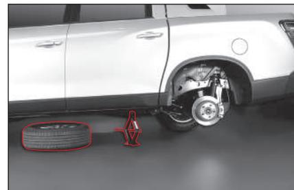
6. Extraiga el neumático y colóquelo debajo de la carrocería del vehículo. Esto minimiza el peligro en caso que el gato se corra de su posición.
