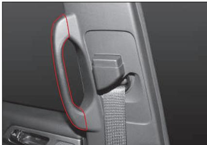
Hay manijas de sujeción en la parte delantera de los asientos posteriores para sujetarse al ingresar al vehículo.
