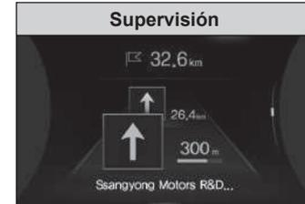
El panel de instrumentos está vinculado al sistema de navegación y muestra parte de la información de la pantalla de navegación.
