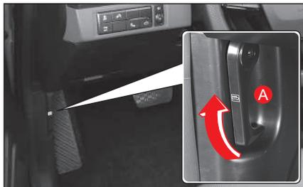
1. Hale la palanca de apertura (A) al lado izquierdo inferior del volante para descorrer el pestillo de la tapa del motor.
