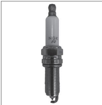
Debe comprobar periódicamente la presencia de carbonilla en las bujías. Cuando se acumula carbonilla en una bujía, ésta puede perder eficacia en la producción de la chispa.
