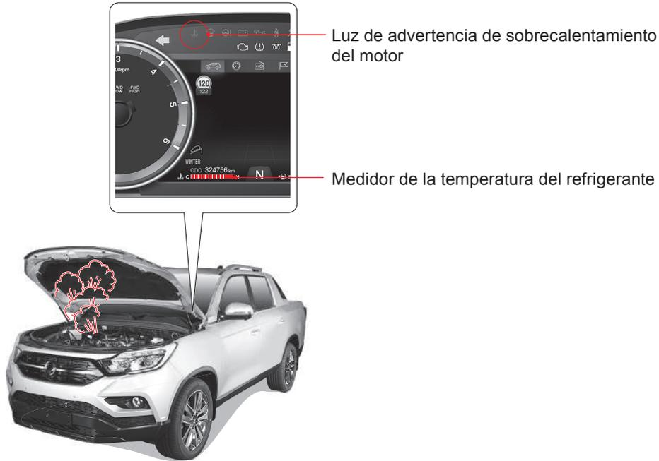
Cuando el motor se sobrecalienta, puede salir vapor o humo del compartimento del motor. O cuando el medidor de temperatura del refrigerante se acerca a “H”. Si esto sucede, se encenderá la luz de advertencia de sobrecalentamiento del motor y sonará una alarma. Detenga el vehículo inmediatamente en un lugar seguro.
