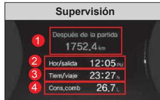
Se muestra la distancia conducida luego de encender el motor (km), la hora de partida (hh:mm), la hora de conducción (hh:mm), y el consumo de combustible (L).
