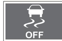
Esta luz se enciende cuando el interruptor de encendido se ajusta en "ON" y se apaga al transcurrir 4 segundos.
