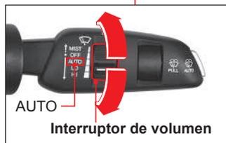
La velocidad de limpieza es ajustable mediante el interruptor de volumen con el interruptor de limpiador en posición AUTO.
