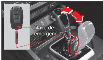
Para pasar de la posición "P" a otra posición, el interruptor de arranque debe estar en la posición ON y el pedal de frenos oprimido. Si no puede cambiar la posición "P" con el interruptor de arranque en la posición ON y el pedal de frenos oprimido:
