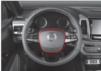
El airbag del conductor está ubicado en la parte central del volante. Este airbag protege la cabeza del conductor ante una colisión frontal.
