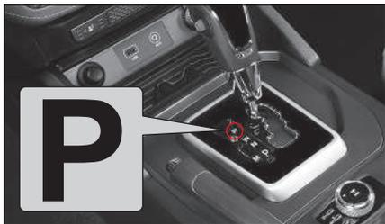
Utilice esta posición para estacionar el vehículo, arrancar el motor, calentar el motor o permanecer en un lugar durante un período de tiempo prolongado.
