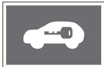
Llave REKES: parpadea cuando el sistema del inmovilizador funciona incorrectamente
