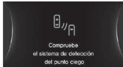
Si hay una falla en el sistema BSD, este mensaje se mostrará en la pantalla LCD.
