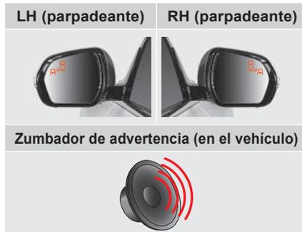
Si la palanca de señal de giro es accionada para un cambio de carril durante la alarma inicial (se encienden las luces de advertencia en color amarillo en el retrovisor), la alarma secundaria se activará de la siguiente manera:
