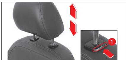
Para levantar el apoyacabezas, jale hacia arriba sin presionar el botón de liberación. Para bajar el apoyacabezas, presione el botón ① de liberación en la parte superior del respaldo del asiento y empuje el apoyacabezas hacia abajo.
