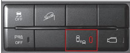
Cuando el interruptor de encendido cumple su ciclo y comienza nuevamente mientras el sistema de alarma para la sección posterior está apagado, la alarma se activa sin regresar al estado anterior.
