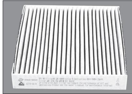
6. Reemplace el filtro de aire acondicionado por uno nuevo. Instale en el sentido inverso a la extracción.
