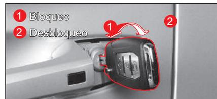
4. Inserte la llave de emergencia en el orificio para llave y gírela hacia la izquierda/derecha para bloquear/desbloquear la puerta.
