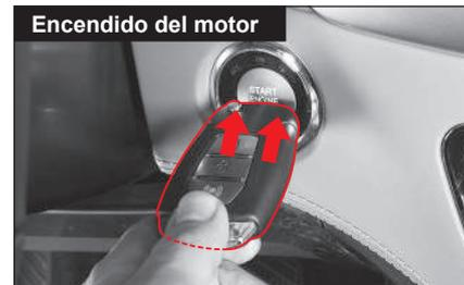
Inserte uno de los extremos de la llave inteligente en el interruptor de encendido y empujelo mientras presiona y sostiene el pedal de freno con la palanca de cambios en posición "P" o "N". La alarma de advertencia se detendrá si fue activada.
