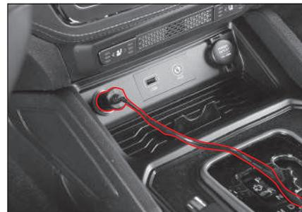
7. Conecte el cable de energía del kit de reparación al encendedor de cigarrillos.
