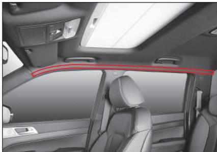
Los airbags de cortina están incorporados dentro del área sobre las puertas delanteras/posteriores, justo debajo de la sección inferior del techo en ambos lados. Este airbag se despliega ante una colisión lateral que cumpla las condiciones de despliegue del airbag para proteger a los ocupantes en los asientos posteriores.
