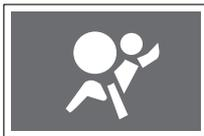
Al colocar el interruptor de arranque en la posición ON, esta luz indicadora se ilumina y se vuelve a apagar, para confirmar que el sistema de bolsas de aire está en funcionamiento.
