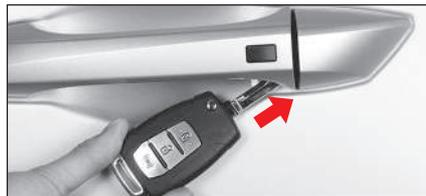
2. Inserte la llave de emergencia o un destornillador de pala (A) en la palanca con ranura de liberación para llave de emergencia y presione sobre la palanca (A).
