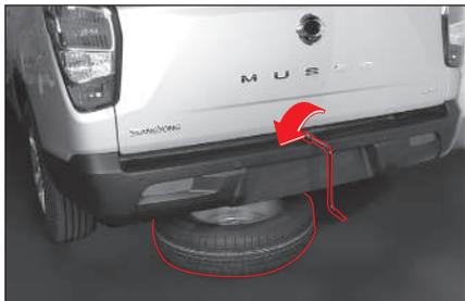
1. Inserte la barra de conexión en el orificio ubicado en la parte central superior del paragolpes después de abrir la puerta trasera, y luego conecte la llave para tuercas de neumáticos.
