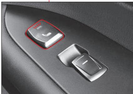
Presione el interruptor para calentar el asiento y presiónelo de nuevo para detener la calefacción. Durante la calefacción, se encenderá la luz indicadora en el interruptor. La función de calefacción de espaldas no está disponible en los asientos posteriores.
