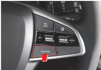
Si las condiciones de parada del cruceo automático se cumplen durante la activación del cruceo automático, la función del control de cruceo se desactiva. Sin embargo, la última velocidad establecida que está memorizada en la UCE, se reanudará al presionar el botón RES.
