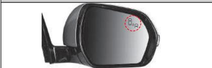
Si la luz de advertencia parpadea dos veces al ajustar el interruptor de encendido en posición "ON" o si el motor está en funcionamiento, significa que el sistema de alarma para la sección posterior está operando correctamente.
