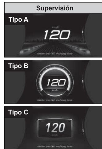
La velocidad del vehículo calculada por el tacómetro se muestra en la pantalla digital. Al presionar el interruptor (←) se apagan todas las luces a excepción de la luz en la pantalla LCD.
