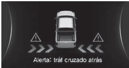
Si otro vehículo se aproxima y es detectado cuando el sistema RCTA está activado, se mostrará un mensaje de advertencia de proximidad en la pantalla LCD para la sección correspondiente junto con una alerta audible.
