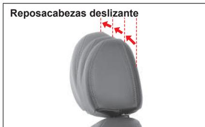
Puede ajustar el apoyacabezas hacia delante en tres posiciones diferentes halando hacia la parte frontal del apoyacabezas. Para ajustar el apoyacabezas hacia atrás, empujelo en su totalidad hacia su posición final y luego libérela. Ajuste el apoyacabezas de modo que se apoye correctamente la cabeza y el cuello.
