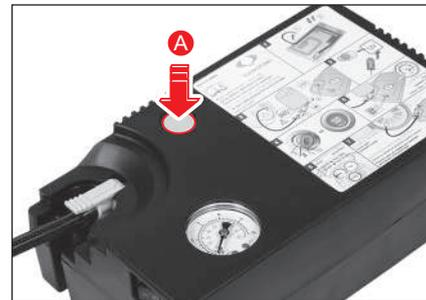
11. Si la llanta queda con mucho aire, presione el botón de liberación de presión de aire (A) para ajustar la presión de inflado.
