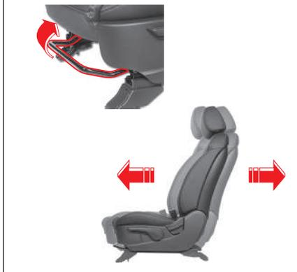
Para mover el asiento hacia adelante o hacia atrás, jale y sostenga la palanca de deslizamiento del asiento y mueva el asiento a la posición deseada. Luego, libere la palanca.
