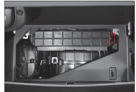
4. Extraiga la cubierta del filtro de aire presionando la parte lateral derecha de la cubierta.
