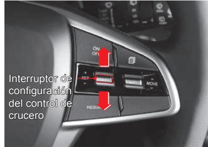
1. Interruptor de encendido/apagado del control de crucero. (Se enciende el indicador "READY")
