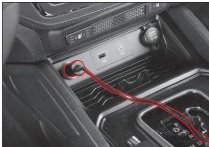
6. Conecte el cable de energía del kit de reparación al encendedor de cigarrillos.
