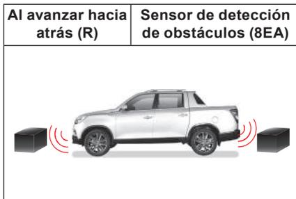
El sensor delantero/posterior funciona en modo reversa (R)
