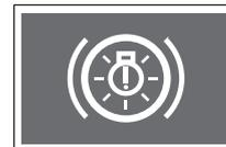
Si ocurre alguna falla en las luces de detención, este indicador de advertencia se encenderá. Si este indicador de advertencia se enciende, verifique el funcionamiento de las luces de detención y cambie el bombilla o haga revisar el vehículo en un Centro de Servicio Autorizado de Ssangyong o en un Concesionario Ssangyong.
