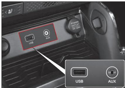
Puede conectar un dispositivo de audio externo incluido un reproductor MP3, CDP, unidades de almacenamiento USB y un iPod (dispositivo de almacenamiento multimedia) al vehículo para reproducir archivos de música o vídeo por medio del sistema de audio del vehículo.
