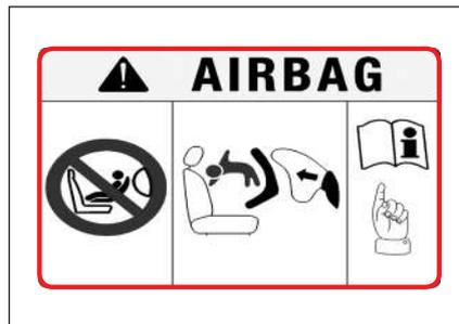
La etiqueta de seguridad del airbag está ubicada en ambos lados del visor solar lateral de los pasajeros indicando al ocupante para que comprenda la peligrosidad de los airbags. Lea y siga las instrucciones e información de seguridad antes de conducir.
