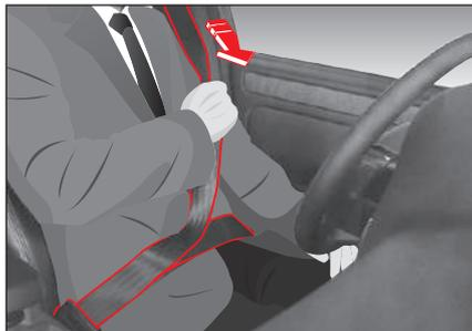
1. Jale hacia fuera la placa del seguro del retractor. Si el cinturón de seguridad está trabado cuando jala hacia afuera, rebóbinelo completamente en el retractor, luego jale hacia afuera hasta alcanzar el largo deseado.
