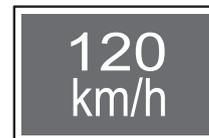
El indicador de advertencia parpadea junto con una alarma reiterada (5 veces) cuando el vehículo supera de 120 km/h.
