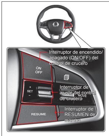
El control de crucero es un sistema de control automático de la velocidad que mantiene una velocidad de manejo constante sin presionar el acelerador. El indicador “READY” o “AUTO CRUISE” se activará en el panel de instrumentos según la operación del interruptor de control de crucero.
