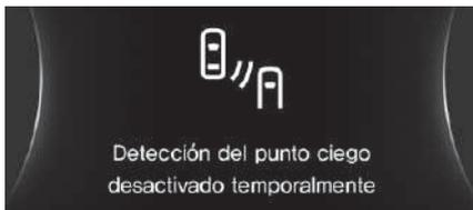
Este mensaje se muestra en la pantalla LCD (tipo supervisión) cuando el sistema BSD es activado y el sensor no logra detectar normalmente los puntos ciegos donde:
