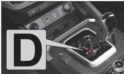
Utilice esta posición para conducción normal. La transmisión se cambia automáticamente del primer cambio hasta el sexto de acuerdo al nivel de presión en el acelerador y la velocidad del vehículo.
