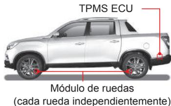
El TPMS, ECU recibe varios datos incluidos la presión de las llantas y la temperatura desde el módulo de ruedas integrado en cada rueda y muestra la información de presión en las llantas a través del panel de instrumentos.
