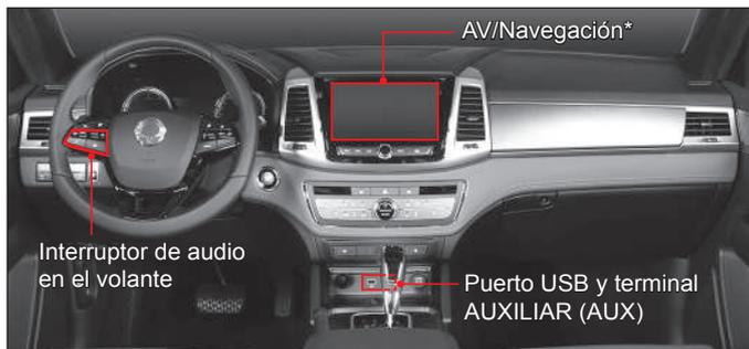
El sistema de AV/Navegación tiene un panel táctil de 9,2 pulgadas y controles de audio en el volante (Sistema de reconocimiento por voz). Puede conectar un dispositivo externo a este sistema utilizando las terminales USB (para iPod) y AUX. El sistema es compatible con tarjetas SD (para navegación)/cámaras de vista posterior/cámaras de vista circundante, y Bluetooth.
