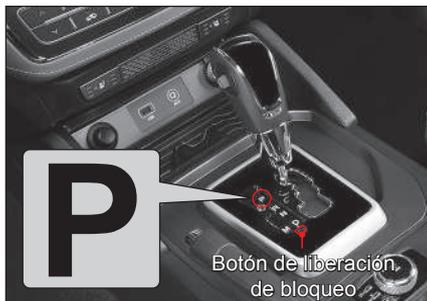
1. Apague el encendido con el pedal de freno presionado y la palanca de cambios en posición "P".
