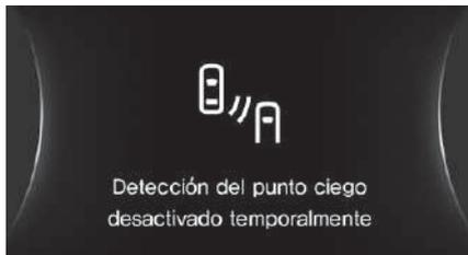
Si las condiciones de advertencia para el sistema BSD no se cumplen cuando el sistema BSD está activado, este mensaje se mostrará en la pantalla LCD.
