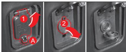
1. Levante la cubierta del toma de corriente (1) sosteniendo su extremo (A).
