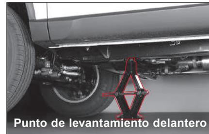
3. Coloque el gato directamente debajo de los puntos de levantamiento de tal modo que la parte superior del gato contacte el punto de levantamiento del vehículo.
