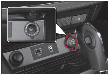
Un tomacorriente auxiliar para dispositivos eléctricos adicional está instalado en el tablero. Este tomacorriente suministra energía cuando la llave de arranque está en la posición “ON” o “ACC”.
