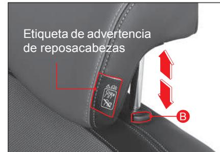
Para elevar el sujetador principal, tire de él hacia arriba sin presionar el botón de liberación. Para bajar el sujetador principal, presione el botón de liberación (B) en la parte superior del asiento trasero y tire hacia abajo del sujetador principal.
