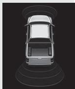
El rango de detección de los sensores delanteros/posteriores se indica sin parpadear y sonará una alarma de advertencia
