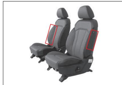
Los airbags laterales para asientos frontales están incorporados al lado del espaldar del asiento del conductor y el espaldar del asiento del pasajero. Este airbag se despliega ante una colisión lateral que cumpla las condiciones de despliegue del airbag para proteger a los ocupantes en los asientos delanteros.
