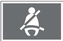
Si el conductor activa el interruptor de encendido sin abrocharse el cinturón de seguridad, este indicador parpadeará por cerca de 6 segundos, junto con una alarma de advertencia. Al abrocharse el cinturón de seguridad, la alarma de advertencia se detendrá pero el indicador permanecerá parpadearando durante el tiempo restante (para un total de 6 segundos)
