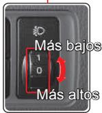
Estando las luces encendidas, el nivel de luces puede ajustarse girando el interruptor cuando las alturas de las luces delanteras y posteriores del vehículo son diferentes debido al número de pasajeros y a las condiciones de carga del vehículo.
