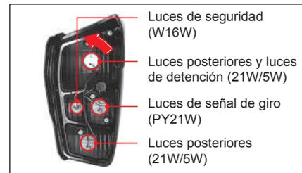
2. Tenga cuidado de no dañar la pintura de la carrocería o el conjunto de combinación posterior al removerlo.
