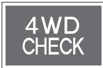
Esta luz indicadora se enciende cuando el interruptor de ignición se gira a la posición "ON" y se apaga cuando el sistema está en condición normal. Si la luz de advertencia "4WD CHECK" no se apaga, revise el sistema 4WD en un Distribuidor o Centro de Servicio Técnico autorizado de Ssangyong.
