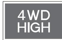
Al cambiar el modo de conducción entre "4L" a "4H", este indicador parpadea hasta que la operación de cambio está completa. Cuando la operación de cambio de modo a 4H está completa, el indicador se apaga.
