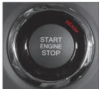
Para encender el motor, pulse el pedal de freno y presione el botón de encendido/parada del motor con la palanca de cambios en la posición P o N.
