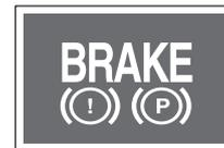
Si la luz de advertencia ABS y la luz de advertencia de freno se encienden simultáneamente, el sistema EBD (Distribución Electrónica de la Fuerza de Frenado) está dañado. En este caso, el sistema ABS no puede ser activado.
