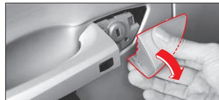
3. Mientras presiona sobre la palanca (A), pulse hacia abajo el tope lateral de la cubierta para extraerla.
