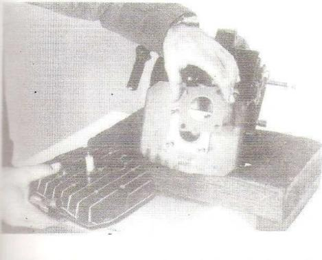
**Fig. 14:** Manualmente desmontar la culata y junta culata.
