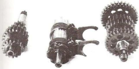
Fig. 44: Detalle del conjunto cambio de marchas de 6 V.
