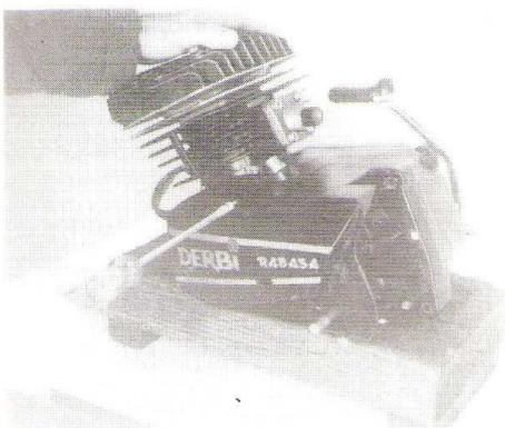
Fig. 2: Aflojar los tres tornillos fijación tapa cárter izquierdo y desmontarla.
