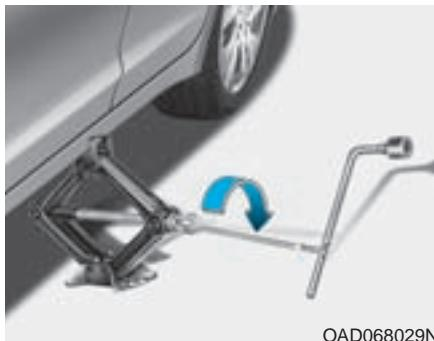
8. Introduzca la manivela del gato en el gato y gírela en sentido horario, elevando el vehículo hasta que la rueda se separe del suelo. Asegúrese de que el vehículo se apoye de forma estable sobre el gato.
