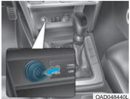
Para usar el mechero, el interruptor de encendido debe estar en la posición ACC u ON.
