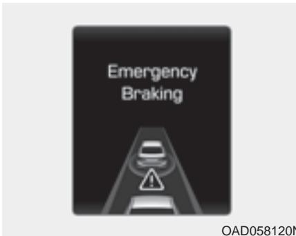
Este mensaje de aviso aparece en la pantalla LCD acompañado de una señal acústica. Además, el sistema de gestión del vehículo acciona la intervención de algún sistema del mismo para decelerarlo.
