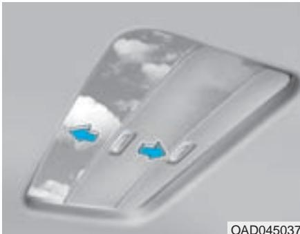
El parasol se abrirá automáticamente con el techo solar cuando se mueva el panel de cristal. Si desea mantener el parasol cerrado, muévalo manualmente.
