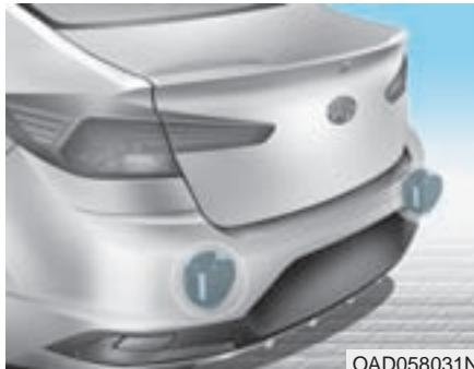
Los radares traseros son los sensores situados en el interior del parachoques trasero previstos para detectar las zonas lateral y trasera. Mantenga el parachoques trasero siempre limpio para garantizar el funcionamiento correcto del sistema.
