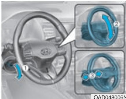
3. Tire de la palanca de liberación del bloqueo hacia arriba para bloquear el volante en su lugar.
