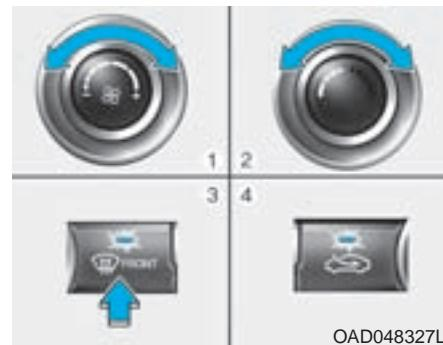
1. Seleccione la velocidad del ventilador deseada.
