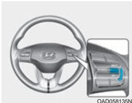
3. Pulse el conmutador hacia abajo (SET-). En la pantalla se iluminará la velocidad ajustada y la distancia de vehículo a vehículo.
