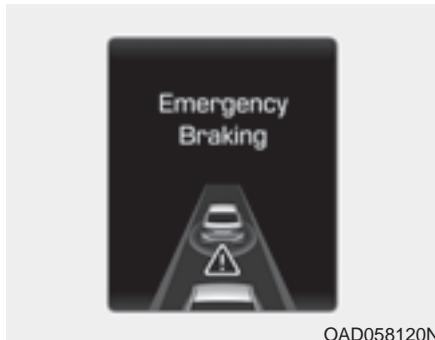
Este mensaje de aviso aparece en la pantalla LCD acompañado de una señal acústica. Además, el sistema de gestión del vehículo acciona la intervención de algún sistema del mismo para decelerarlo.
