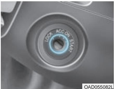
En el momento que se abra una puerta delantera, el interruptor de encendido se iluminará, si el interruptor de encendido no está en la posición ON. La luz se apagará inmediatamente cuando el interruptor de encendido se encienda o se apagará 30 segundos después de cerrar la puerta. (opcional)
