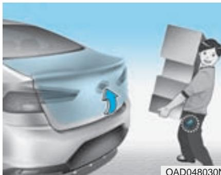
En los vehículos equipados con una llave inteligente, el maletero puede abrirse mediante el sistema del maletero inteligente.
