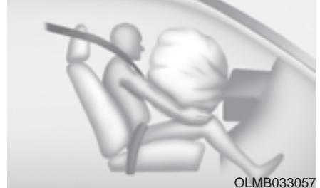
Después de completarse el inflado, el airbag comienza a desinflarse inmediatamente, permitiendo que el conductor mantenga la visión delantera y la capacidad de accionar el volante u otros controles.
