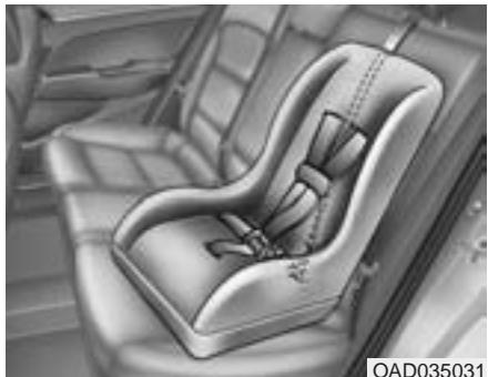
1. Coloque la cincha de sujeción del asiento del niño sobre el respaldo. Para vehículos con un reposacabezas ajustable, coloque la cincha de sujeción por debajo del reposacabezas entre las barras del reposacabezas, o puede colocar la cincha de sujeción por encima del respaldo del asiento.
