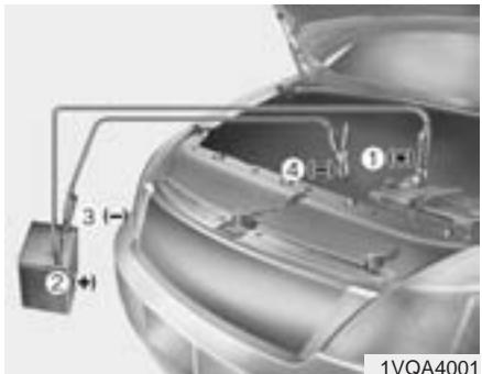
4. Conecte las pinzas de puente en la misma secuencia indicada en la imagen. Conecte primero el cable de puente al borne rojo positivo (+) en su vehículo (1).
