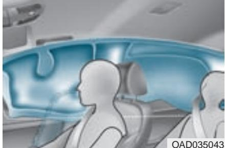
En las guías del techo de ambos lados, encima de las puertas delanteras y traseras, se encuentran airbags de cortina.
