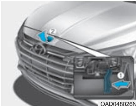
3. Vaya a la parte delantera del vehículo, eleve el capó ligeramente, tire del enganche secundario (1) interior en el centro del capó y levante el capó (2).
