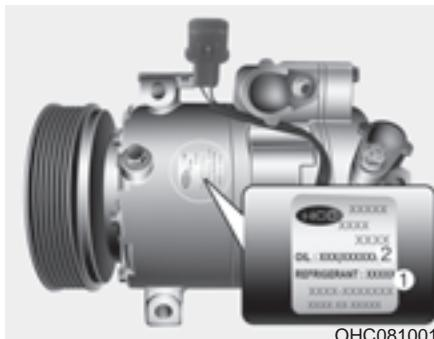
La etiqueta del compresor indica el tipo de compresor equipado en el vehículo, el modelo, el número de pieza, el número de producción, el refrigerante (1) y el aceite refrigerante (2).
