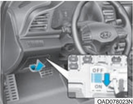
Coloque siempre el interruptor fusible en la posición ON.
