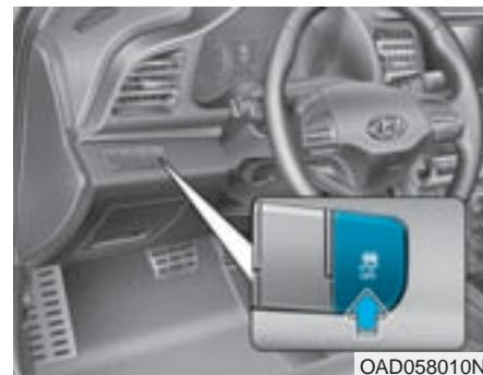
El control electrónico de estabilidad (ESC) permite estabilizar el vehículo durante maniobras en curvas. El ESC comprueba hacia dónde se gira el volante y hacia dónde se dirige realmente el vehículo.
