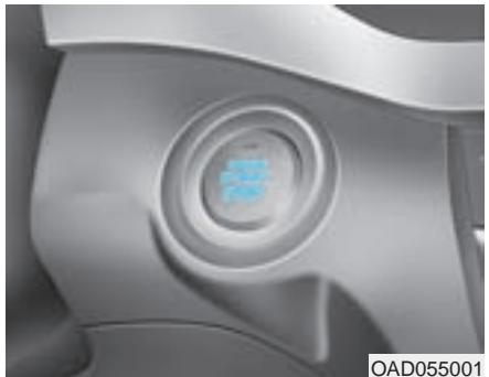
Cuando la puerta delantera está abierta, el botón Start/Stop del motor se ilumina y se apaga 30 segundos después de cerrar la puerta. (opcional)
