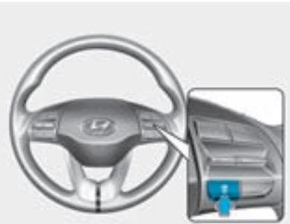
Cuando el sistema del control de crucero inteligente esté activado, puede ajustar y mantener la distancia del vehículo que le precede sin pisar el pedal del acelerador o del freno.
