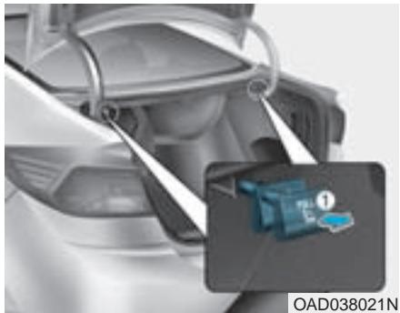
3. Tire de la palanca de pliegue del respaldo (1) que se encuentra en el maletero.
