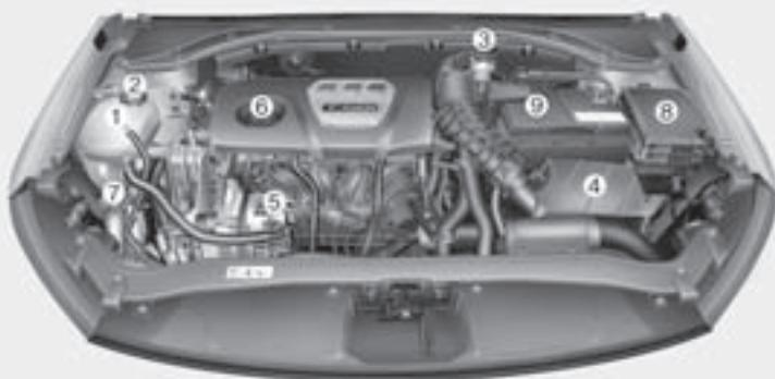
1. Depósito de refrigerante del motor
