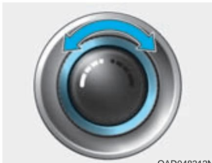
2. Gire el mando de control de temperatura para ajustar la temperatura deseada. Si la temperatura se ajusta a la posición mínima (Lo), el aire acondicionado operará de forma continuada.
