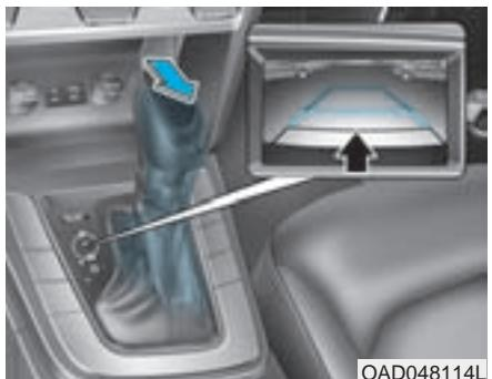
El monitor de visión trasera se activa cuando el motor está en marcha y la palanca de cambio está en la posición R (marcha atrás).
