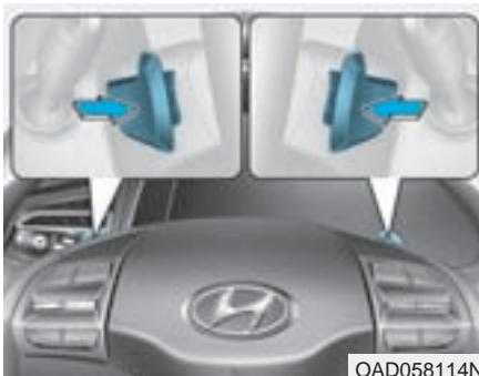
La palanca de cambio en el volante puede utilizarse cuando la palanca de cambio está colocada en la posición D (conducción) o en el modo de cambio manual.
