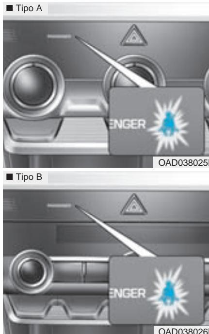
Como recordatorio al pasajero delantero, el testigo de advertencia del cinturón de seguridad se iluminará durante aprox. 6 segundos cada vez que se active el interruptor de encendido, aunque el cinturón esté abrochado.
