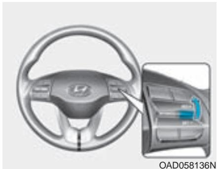
Empuje el interruptor de palanca hacia arriba (RES+). Si la velocidad del vehículo es superior a 30 km/h, el vehículo recuperará la velocidad preajustada.
