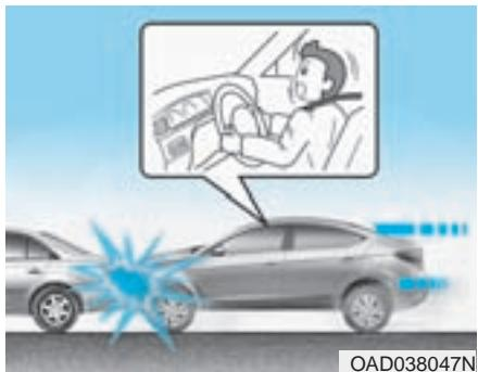
En algunas colisiones a baja velocidad, los airbags podrían no desplegarse. Los airbags están diseñados para no desplegarse en esos casos porque no aportarían beneficios adicionales a la protección ofrecida por el cinturón de seguridad.
