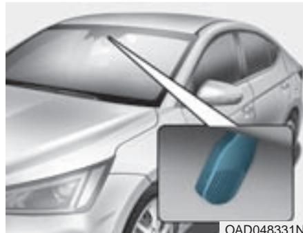
El sistema de desempañado automático reduce la probabilidad de empañamiento en el interior del parabrisas al detectar automáticamente la humedad del interior del parabrisas.
