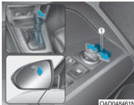
Cuando coloca la palanca de cambios en R (marcha atrás), el(es) retrovisor(es) exterior(es) se girará(n) hacia abajo para facilitar el estacionamiento marcha atrás.
