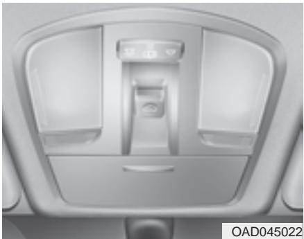
Si el vehículo está equipado con un techo solar, puede deslizar o inclinar su techo solar con los interruptores de control ubicados en la consola superior.
