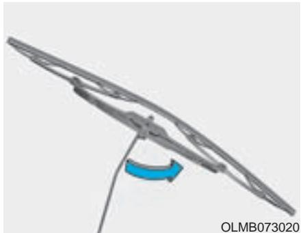
1. Levante el brazo del limpiaparabrisas y gire el conjunto de la escobilla para descubrir el clip de plástico de sujeción.
