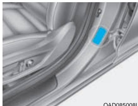
La etiqueta de certificación del vehículo situada en la columna central en el lado del conductor (o del acompañante) muestra el número de identificación del vehículo (VIN).
