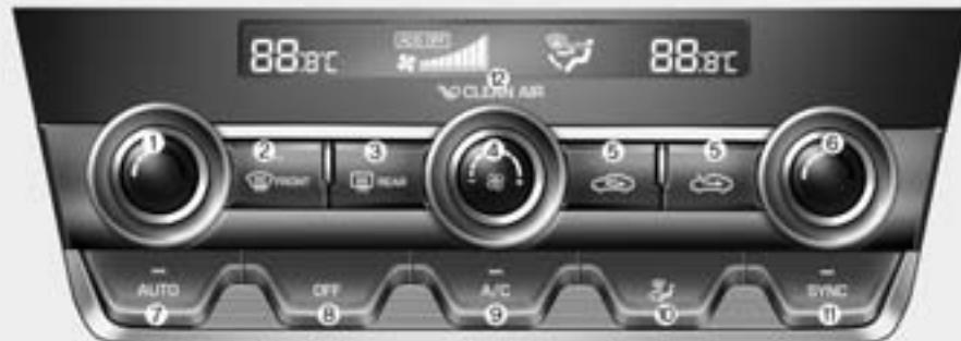
1. Mando de control de temperatura del conductor
