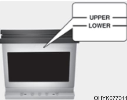
Si su vehículo está equipado con una batería con las marcas LOWER (MIN) y UPPER (MÁX) a un lado, deberá comprobar el nivel de electrolito.
