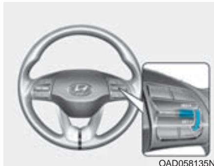
3. Empuje el interruptor de palanca hacia abajo (SET-) y suéltelo. Se iluminará el indicador SET o la velocidad ajustada en la pantalla LCD.
