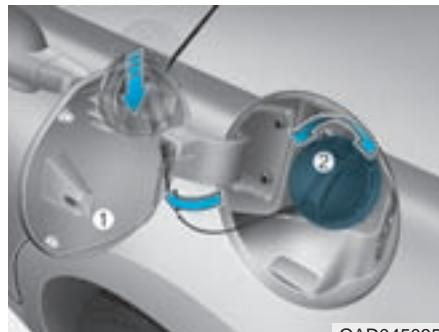
3. Tire hacia afuera la compuerta de llenado de combustible (1) para abrirla completamente.
