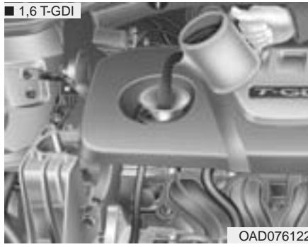
Si está cerca de L, añada el aceite suficiente para que llegue a F. **No llene excesivamente. Utilice un embudo para evitar que el aceite se derrame por los componentes del motor.**
