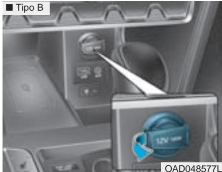
La toma de corriente está diseñada para proporcionar potencia a teléfonos móviles u otros aparatos eléctricos diseñados para funcionar con el sistema eléctrico del vehículo.
