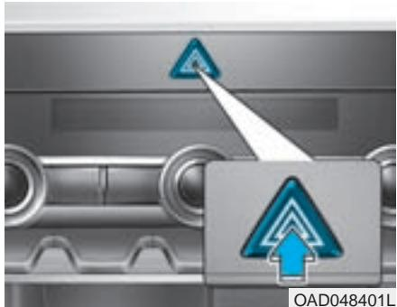
Para encender y apagar las luces de emergencia, pulse el botón de las luces de emergencia con el interruptor de encendido en cualquier posición. El botón se encuentra en el centro de la consola delantera. Todos los intermitentes de giro parpadearán al mismo tiempo.
