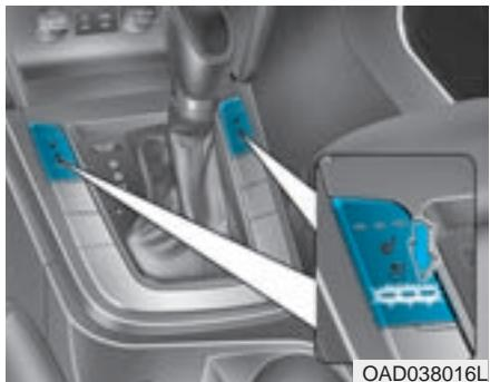
Los asientos con ventilación de aire tienen la función de enfriar los asientos delanteros haciendo salir aire a través de pequeños orificios de ventilación en la superficie de los cojines y los respaldos.
