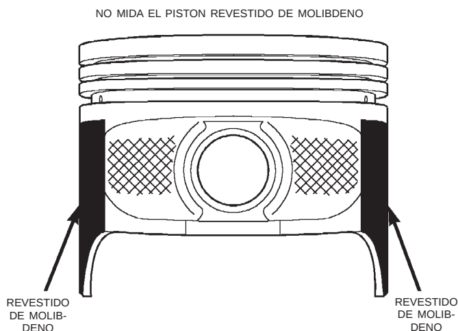
Fig. 3 Pistón revestido de molibdeno
