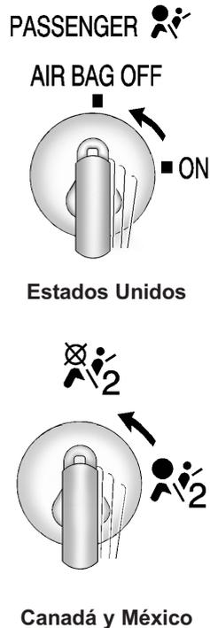
Para desactivar la bolsa de aire del pasajero del asiento delantero derecho, inserte la llave de ignición en el interruptor, oprímala hacia dentro y mueva el interruptor hasta la posición de desactivado.
