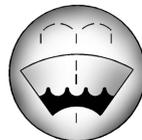
Abra el tapón que tiene el símbolo del lavaparabrisas. Agregue líquido para lavaparabrisas hasta llenar el tanque. Vea en *Visión general del compartimiento del motor en la página 10-6* la ubicación del depósito.
