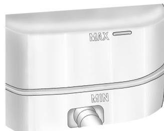
El nivel del líquido debe estar por arriba de la marca MIN (MÍNIMO); de no ser así, haga que revisen el sistema hidráulico de los frenos para ver si hay alguna fuga.
