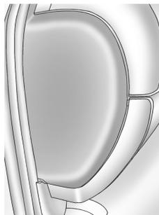
La puerta de acceso al bloque de fusibles del tablero de instrumentos se encuentra en el borde del lado del conductor del tablero de instrumentos.
