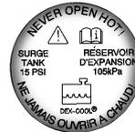
1. Retire el tapón de presión del tanque de compensación del refrigerante cuando el sistema de enfriamiento, incluyendo el tapón de presión del tanque de compensación del refrigerante y la manguera superior del radiador, ya no estén calientes.
