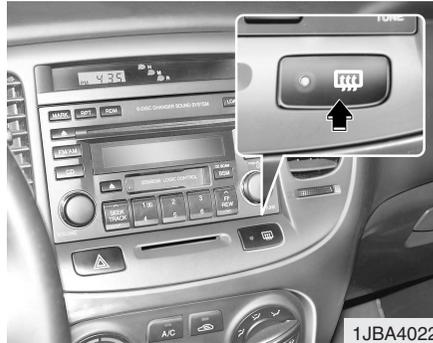
El dispositivo de deshielo calienta el cristal para eliminar el hielo, el vaho o la escarcha del interior o el exterior de la luneta trasera, siempre que funcione el motor.
