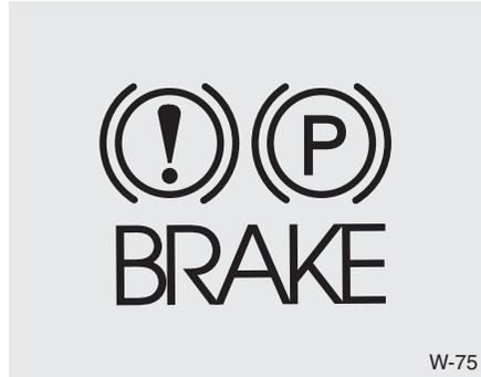
Compruebe la luz de aviso del freno colocando el contacto en ON (no arranque el motor). Este piloto se iluminará siempre que se aplique el freno de estacionamiento mientras el contacto está en las posiciones START u ON.
