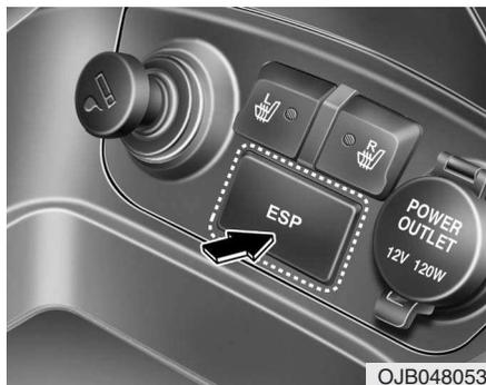
El control electrónico de estabilidad (ESP) controla la información de varios sensores y entonces compara las órdenes del conductor con la conducta real del vehículo. Si el vehículo llegara a acusar una condición de inestabilidad, por ejemplo durante una brusca maniobra para evadir un obstáculo, el ESP interviene en fracciones de segundo sobre el ordenador del motor y sobre el sistema de frenos e intenta estabilizar el vehículo.
