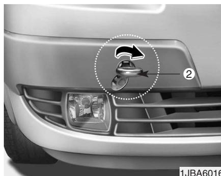
3. Instale el gancho de remolque girándolo en el sentido de las agujas del reloj dentro del orificio hasta que esté apretado del todo (2).
