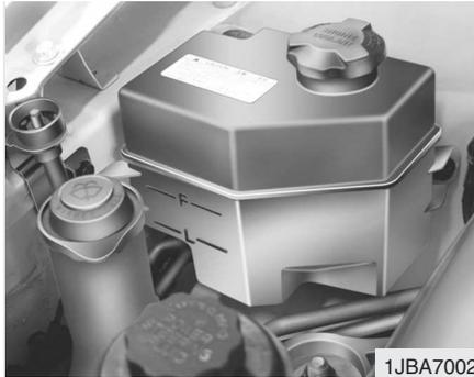
Compruebe el estado y las conexiones de todos los manguitos del sistema de refrigeración y calefacción. Sustituya los que estén deteriorados.
