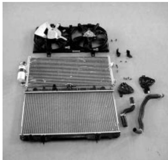
Figura 68 | Radiador, condensador y electroventilador
