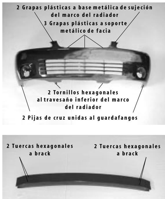
Figura 12 | Unión del conjunto defensa delantera
