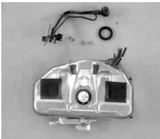
Figura 73 | Depósito de combustible
