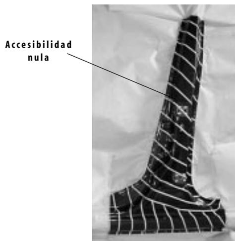
Figura 47 | Accesibilidad sección y forma del poste central
