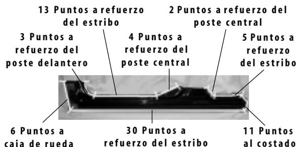
Figura 43 | Unión del estribo
