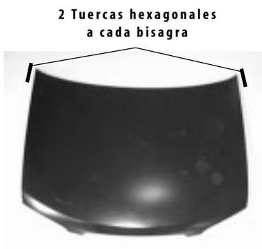
Figura 26 | Unión del cofre
