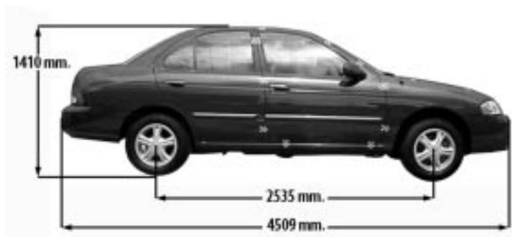
Figura 2 | Dimensiones exteriores del vehículo
