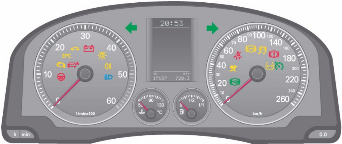
Cuadro de instrumentos de una versión con motor diésel
