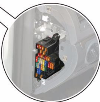
Caja de fusibles, en el tablero de instrumentos, lado izquierdo
