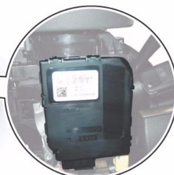
Unidad de control para electrónica de la columna de dirección J527, bajo el mando combinado de la columna de dirección
