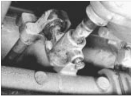
5.18 Shift rod coupling screw
