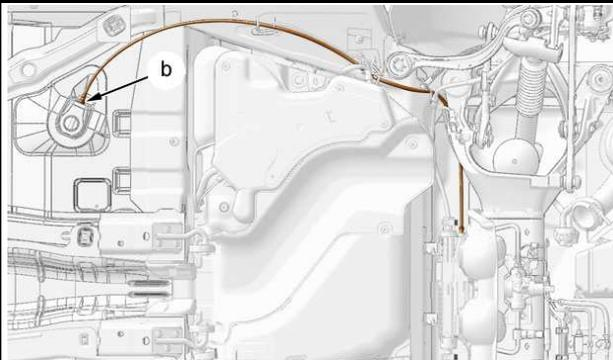
Desgrapar los cables de freno de sus fijaciones sobre la caja.
