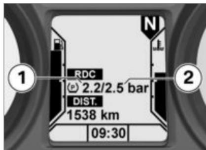
La presión de inflado de los neumáticos indicada hace referencia a una temperatura de los neumáticos de 20 °C. El valor de la izquierda **1** representa la presión de inflado de la rueda delantera, y el de la derecha **2**, el de la rueda trasera. Inmediatamente después de conectar el encendido aparece -- --, ya que la transmisión de los valores de presión de inflado comienza una vez se ha sobrepasado una velocidad aproximada de 30 km/h por primera vez.<
