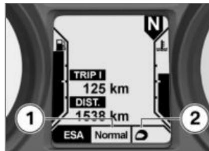
La amortiguación elegida se visualiza en la pantalla multifunción, en la zona **1**, y el tipo de carga en la zona **2**. Los indicadores tienen el significado siguiente:
