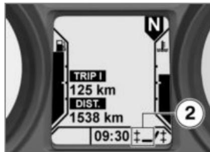
El asiento del conductor puede calentarse en dos niveles. El segundo nivel sirve para calentar rápidamente el asiento; a con-
