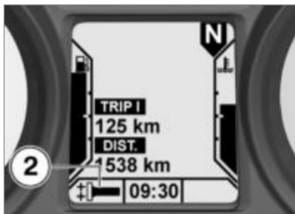
Los puños del manillar disponen de dos posiciones de calefacción. El segundo nivel sirve para calentar rápidamente los puños; a continuación debe volverse al primer nivel. El nivel de calefacción ajustado **2** se muestra en la pantalla multifunción.
