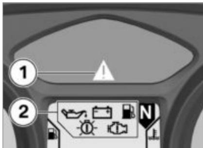
Los avisos se representan mediante el testigo de advertencia general **1** en combinación con uno de los símbolos de advertencia **2**. En función de la urgencia de la advertencia, el testigo de advertencia general se ilumina en rojo o en amarillo.
