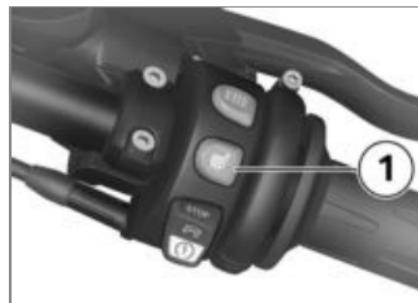
• Pulsar la tecla **1** hasta que se muestre el nivel de calefacción deseado.
