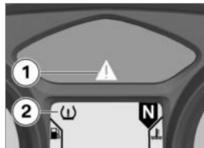
Si se muestra adicionalmente el símbolo de advertencia **2**, significa que se trata de un indicador de advertencia. La presión crítica de inflado de los neumáticos parpadea.
