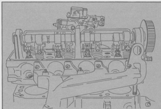
Fig. 52 - Instalación de la tapa de cilindros
