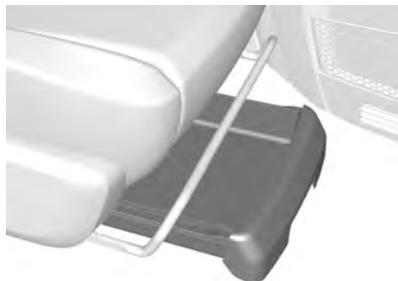
Para utilizar la bandeja inferior del asiento del acompañante, tire del extremo de la bandeja y deslícela hacia el panel de mandos. Para llevarla otra vez a su posición original, deslice la bandeja debajo del asiento.
