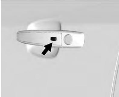
Con el transmisor de acceso sin llave a menos de 1 m (3 pies), aproxímese a la puerta delantera y tire de la manija para desbloquear y abrir la puerta. En algunos modelos, hay un sensor táctil en la manija de la puerta. Si se reconoce el transmisor, la puerta se desbloqueará y abrirá.
