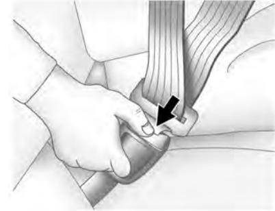
Para abrir el cinturón, presione el botón de la hebilla. El cinturón debe volver a la posición de guardado. Deslice la lengüeta metálica por encima del cinto cuando no se está usando el cinturón de seguridad. La lengüeta metálica debe apoyarse sobre la costura del cinturón de seguridad, cerca de la hebilla de guía en la pared lateral.
