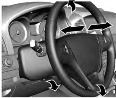
El vehículo tiene un volante inclinable y telescópico.
