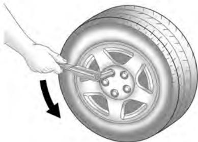
3. Utilice la llave para ruedas para aflojar todas las tuercas de la rueda. No saque ninguna de las tuercas hasta que la rueda esté levantada del suelo.
