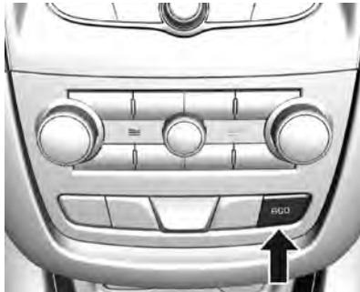
El modo de economía de combustible se activa pulsando el botón ECO que se encuentra en el tablero de instrumentos. Cuando está activado, se enciende la luz eco en el tablero de instrumentos. *Indicador de consumo de combustible* ⇨ 126. Al presionar el
