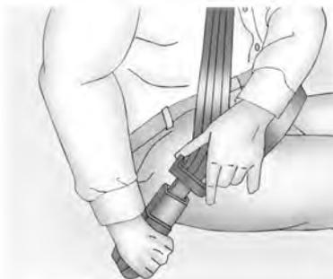
2. Tome la lengüeta metálica y tire del cinturón pasándolo por encima suyo. No permita que se retuerza. El cinturón de hombro y cintura puede bloquearse si tira de la correa muy rápidamente. Si ocurre esto, deje que la correa vuelva un poco para desbloquearla. Después tire de la correa por encima suyo, más lentamente.
