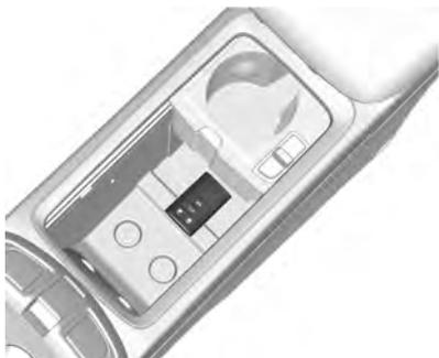
Si la batería del transmisor tiene poca carga, el DIC puede indicar **ELECTRONIC KEY NOT DETECTED (LLAVE ELECTRÓNICA NO DETECTADA)** cuando usted trata de arrancar el vehículo. Para arrancar el vehículo, coloque el transmisor en el bolsillo para el transmisor del área del portaobjetos de la consola central con los botones mirando hacia arriba. Luego, con el vehículo en P (estacionamiento) o en N (Punto muerto), pise el pedal de freno y presione la perilla de control del
