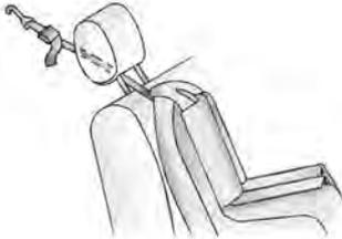
Si la posición del asiento trasero exterior que está usando tiene apoyacabezas ajustable y está usando una correa única, levante el apoyacabezas y pase la correa por debajo del apoyacabezas y entre sus columnas.
