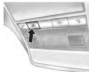
Si desea desactivar el sistema antirrobo adicional, pulse el botón que se encuentra en el forro del techo. Se enciende el indicador de sistema antirrobo desactivado del botón.
