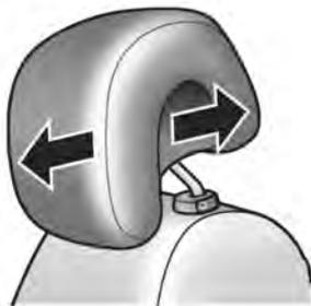
El apoyacabezas se puede ajustar hacia adelante y hacia atrás. Para ajustar el apoyacabezas hacia delante, tómelo por su parte inferior y tire hacia delante a la posición deseada hasta que trabe. Para ajustar el apoyacabezas hacia atrás, tómelo por su parte inferior y tire hacia delante hasta que se afloje el mecanismo, permitiendo que el apoyacabezas vuelva hacia la posición plenamente hacia atrás.
