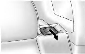
3. Levante la palanca de la parte superior del respaldo para desbloquearlo. Luego, pliegue el respaldo hacia delante.
