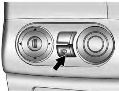
El botón del lavafaros se encuentra en el tablero de instrumentos cerca del control de las luces exteriores. Para usar esta función, deben encenderse los faros.
