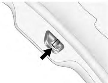
Para abrir el portón trasero si se desconectó la batería o si hay bajo voltaje, acceda a la palanca de liberación. Retire el revestimiento del lado interior del portón trasero. Utilice una herramienta para empujar la palanca del cierre hasta que se libere el portón.
