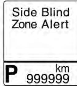
Si su vehículo tiene el SBZA activado, pulse
