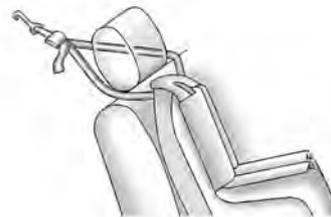
Si la posición del asiento trasero exterior que está usando tiene apoyacabezas ajustable y está usando una correa doble, pase la correa alrededor del apoyacabezas.
