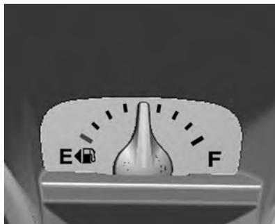
El medidor de combustible indica cuánto combustible queda en el tanque de combustible cuando el encendido está en ON.
