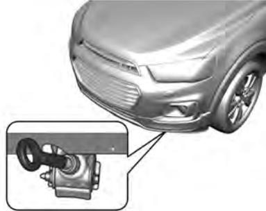
El anillo de remolque delantero se encuentra debajo del paragolpes delantero. Retire el desviador de aire del lado del conductor y sujete el anillo de remolque. Debe haber un conductor en el vehículo para dirigirlo y para usar los frenos.
