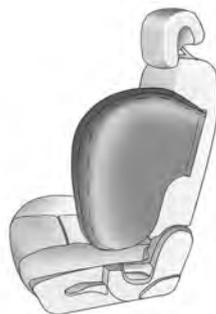
Si el vehículo tiene airbags para impacto lateral montados en el asiento del conductor y del pasajero de la parte delantera externa, estarán en el costado de los respaldos más cercanos a la puerta.
