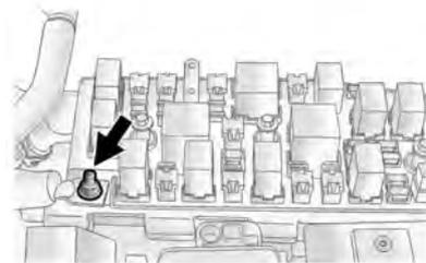
El vehículo cuenta con un terminal positivo (+) remoto. Está ubicado en el compartimento del motor del bloque de fusibles debajo del capó. *Vista del compartimento del motor* ⇨ 267.
