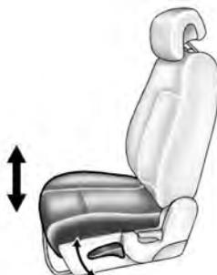
Si está equipada, mueva la palanca hacia arriba o abajo varias veces para elevar o bajar el asiento del conductor. *Ajuste de los asientos* ⇨ 49.
