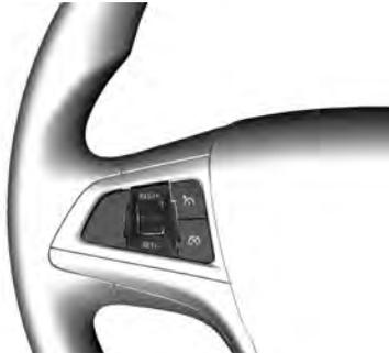
El sistema de Infoentretenimiento, el control de velocidad crucero y un teléfono móvil conectado se pueden operar por medio de los controles en el volante de dirección.
