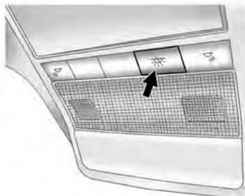
**☼ (Anular lámparas de techo) :** Pulse para mantener apagadas las luces de techo y las demás luces interiores cuando se abre una puerta. Pulse este botón otra vez para devolverlo a la posición en la que sobresale, y las luces se encenderán automáticamente cuando se abra cualquiera de las puertas.
