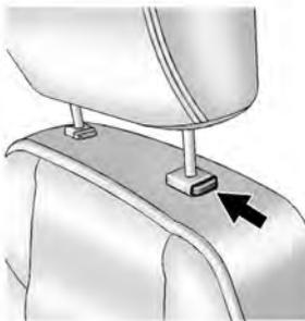
Se puede ajustar la altura del apoyacabezas. Tire del apoyacabezas hacia arriba para levantarlo. Intente mover el apoyacabezas para verificar que está trabado en su lugar.
