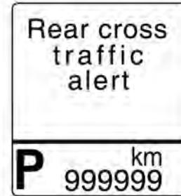
Si su vehículo tiene el RCTA activado, pulse
