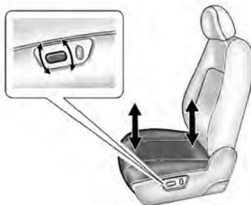
Suba o baje la parte delantera o trasera del almohadón del asiento, moviendo el frente o la parte trasera del control hacia arriba o abajo.
