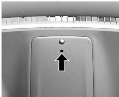
Si el vehículo tiene el sistema de alarma activado, el indicador muestra que el sistema está funcionando.
