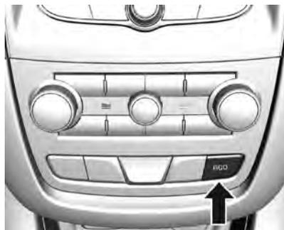
Puede desactivar manualmente el sistema de arranque/detenimiento pulsando el botón ECO.
