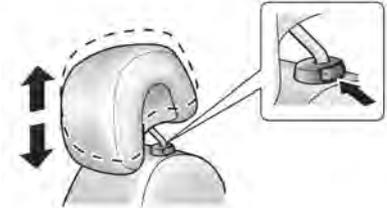
Tire los apoyacabezas hacia arriba para ajustar la posición hacia arriba. Empuje los apoyacabezas hacia abajo mientras pulsa el botón de liberación para ajustar la posición hacia abajo.
