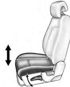
Si está equipado, mueva la palanca hacia arriba o abajo repetidamente para elevar o bajar el asiento del conductor.
