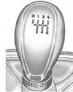
**1 (Primera)** : Pise el pedal del embrague y cambie a 1 (primera). Luego, suelte lentamente el pedal del embrague a medida que presiona el pedal del acelerador.
