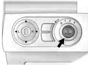
Para atenuar o aumentar el brillo de las luces del tablero de instrumentos, pulse el botón y gírelo en sentido horario o antihorario.
