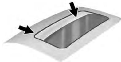
Se pueden acumular basura u objetos extraños en el sello del techo solar o en el carril. Esto podría causar un problema en el funcionamiento del techo solar, ruido o taponamiento del sistema de drenaje de agua. Abra periódicamente el techo solar y quite los obstáculos que encuentre o materias extrañas. Limpie el sello del techo solar y la zona de sellado del techo con un trapo limpio, jabón suave y agua. No quite la grasa del techo solar.
