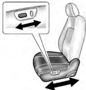
Si está equipado, mueva el asiento hacia adelante o detrás deslizando el control horizontal hacia delante o detrás.
