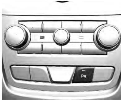
Para activar el sistema, pulse el botón del asistente de estacionamiento del tablero de instrumentos. EL botón del indicador se enciende.
