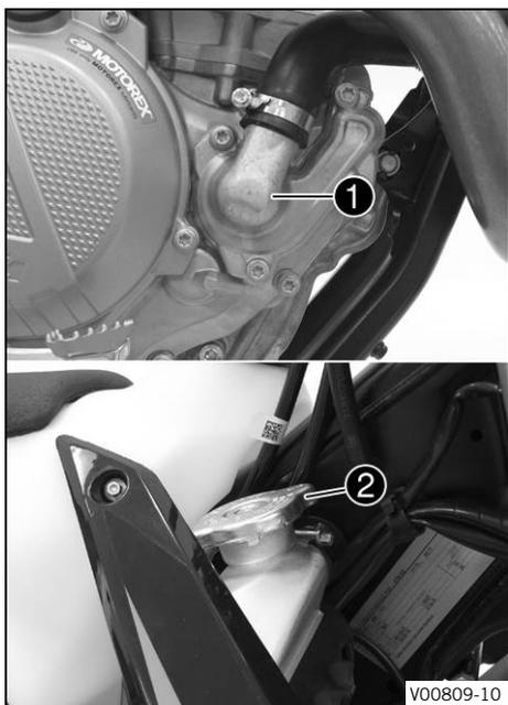
La bomba de agua ① del motor hace circular de manera forzada el líquido refrigerante.
