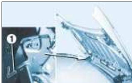
⇨ Desde la parte trasera derecha del vehículo, abra la tapa de maletero completamente **y todo ello sujetándola**, bloquéela introduciendo la llave hexagonal 1 a tope en el mecanismo.
