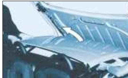
⇨ Coja el techo, despléguelo, (es necesario realizar un esfuerzo importante) y condúzcalo hasta que entre en contacto con el marco parabrisas.
