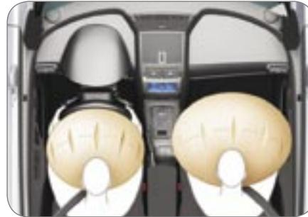
Están integrados en el centro del volante para el conductor y en el panel de instrumentos para el pasajero delantero. Se disparan simultáneamente, salvo si el airbag pasajero está neutralizado.
