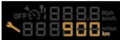
Después de haber señalado una indicación sobre el nivel de aceite motor, la pantalla indica el kilometraje total y parcial.
