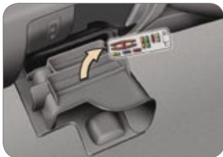
Antes de sustituir un fusible, es necesario conocer la causa del incidente y haberlo solucionado. Los números de los fusibles están indicados en la caja de fusibles.
