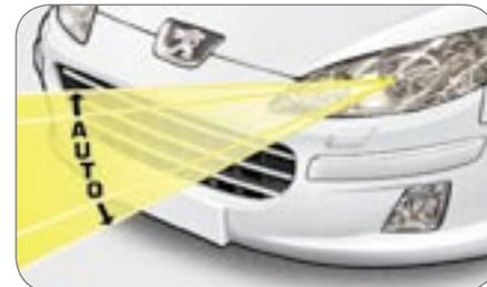
En los vehículos equipados con lámparas de xenón : **parado**, el sistema corrige automáticamente la altura del haz de luz, sea cual fuere el estado de carga del vehículo. El conductor está entonces seguro de tener una iluminación óptima y de no molestar a los otros automovilistas.
