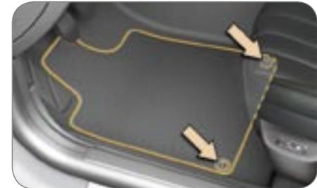
Para el desmontaje de la sobremuqueta lado conductor, retroceda el asiento al máximo y retire las fijaciones.
