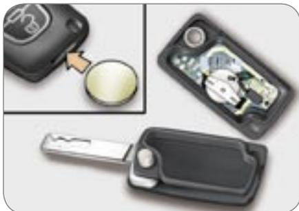
Para sustituir la pila, suelte el cajetín, con la ayuda de una moneda a nivel del anillo (pila CR 1620/3 voltios).
