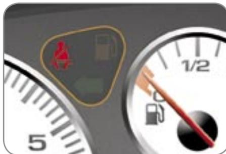
Nada más **poner el contacto**, si un pasajero delantero no ha abrochado su cinturón de seguridad y si la velocidad del vehículo es **inferior a 20 km/h**, usted está avisado por el **testigo de cinturón** que se enciende.
