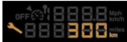
Después de la señalización del mantenimiento y del nivel de aceite, el totalizador kilométrico vuelve a su funcionamiento normal y la llave se queda encendida.
