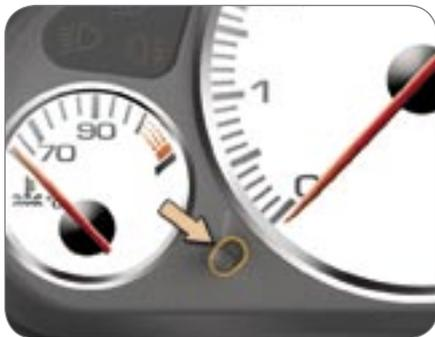
Luces encendidas, pulse el botón para variar la intensidad de iluminación del puesto de conducción. Cuando la iluminación alcanza el reglaje mínimo (o máximo), suelte el botón y vuelva nuevamente a pulsarlo para aumentar la intensidad (o disminuirla).
