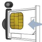
Instale la tarjeta SIM en el soporte e insértela a continuación en la trampilla.
