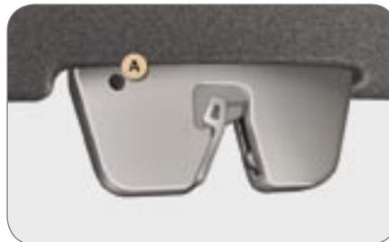
Permite, en caso de incidente de funcionamiento del cierre centralizado, el desbloqueo del maletero.
