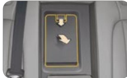
La apertura de la trampilla se efectúa tirando de la empuñadura hacia abajo y hacia Ud.
