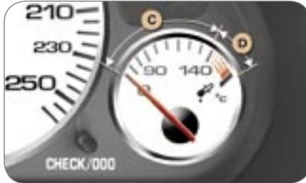
Al poner el contacto o vehículo circulando, indica la temperatura del aceite motor.
