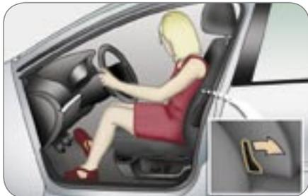
Accione la palanca para obtener la buena posición.
