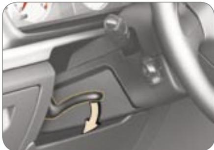
Parado, desbloquee el volante empujando hacia delante el mando. Ajuste la altura y la profundidad del volante y después bloquéelo tirando a fondo del mando.
