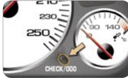
Un impulso en el botón "CHECK/000" del combinado lanza el CHECK manual (autotest del vehículo).
