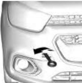
Enrosque el gancho de remolque todo lo posible hasta que haga tope en una posición horizontal.
