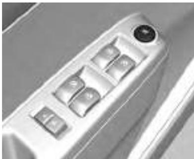
Pulse el interruptor
