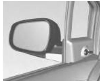
Sencillamente, mueva la palanca en el sentido deseado para ajustar el ángulo de los espejos retrovisores.
