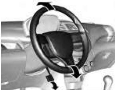
Desbloquee la palanca, ajuste el volante, luego enclave la palanca y asegúrese de que esté totalmente bloqueada. Ajuste el volante sólo con el vehículo detenido.
