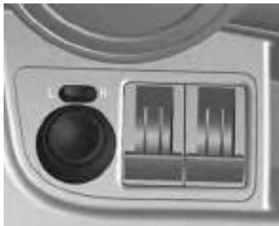
Seleccione el espejo exterior correspondiente girando el control a la izquierda **L** o a la derecha **R**. Luego, gire el control para ajustar el retrovisor.
