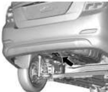
La argolla de amarre para transportación trasera no se puede utilizar para remolcar o para recuperar un vehículo.
