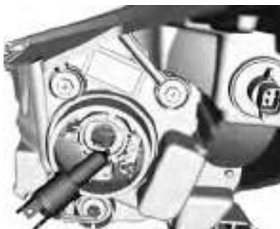
4. Retire la lámpara de la carcasa del reflector.
