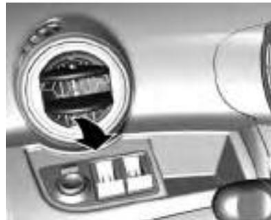
Presione la cubierta de cada salida de aire para abrir las salidas de aire laterales y oriéntelas como prefiera.
