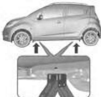
3. Haga girar la manilla del gato para alzar ligeramente el cabezal de elevación, y coloque el gato vertical en la posición marcada con un semicírculo.
