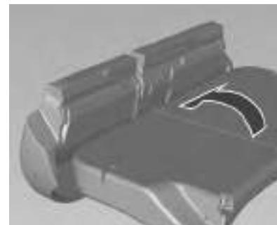
3. Tire hacia arriba de la perilla de desbloqueo existente en la parte superior del respaldo del
