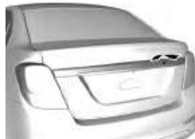
Para abrir la tapa del baúl, introduzca la llave en la ranura y gírela en el sentido de las agujas del reloj. Levante la tapa del baúl.
