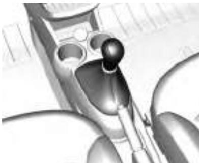
Marcha atrás: con el vehículo inmóvil, presione el pedal del embrague y coloque la marcha.
