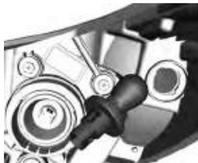
2. Empuje la lámpara ligeramente dentro del enchufe, gire hacia la izquierda, retire y cambie la lámpara.
