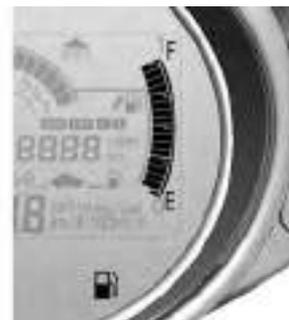
El testigo de control
