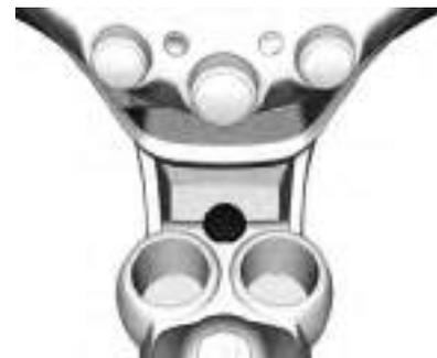
Hay un tomacorriente de 12 V situado en la consola delantera.
