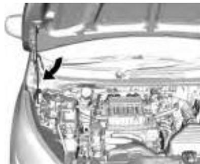
3. Levante el capó, retire la varilla de soporte del capó del alojamiento y fíjela correctamente.
