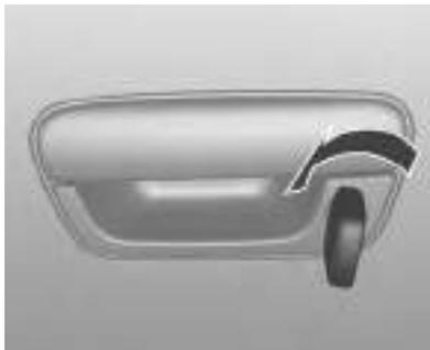
Desbloquee manualmente la puerta del conductor girando la llave en la cerradura.
