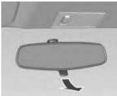
Para reducir el deslumbramiento, ajuste la palanca de la parte inferior de la carcasa del espejo retrovisor.
