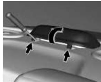
1. Inserte un destornillador en el espacio que está en la carcasa de la lámpara inferior. Libere la tapa moviendo el destornillador cuidadosamente hacia abajo.
