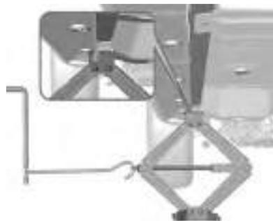
4. Coloque la manilla en el gato y coloque la llave correctamente en la manilla del gato.
