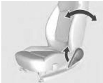
Tire de la palanca, ajuste la inclinación y suelte la palanca. Deje que el asiento bloquee audiblemente.
