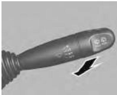
Tire de la palanca. El líquido de lavado se rocía en el parabrisas y los limpiaparabrisas realizan unos cuantos barridos.
