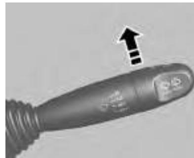
Para accionar el limpiaparabrisas, active el encendido y lleve hacia arriba la palanca del limpia/lavaparabrisas.
