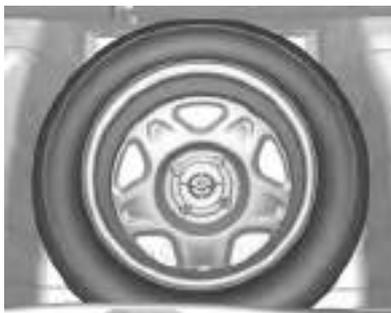
La rueda de auxilio está situada en el compartimento de carga, debajo de la cubierta del piso. Está fijada en el rebaje mediante una tuerca de mariposa.
