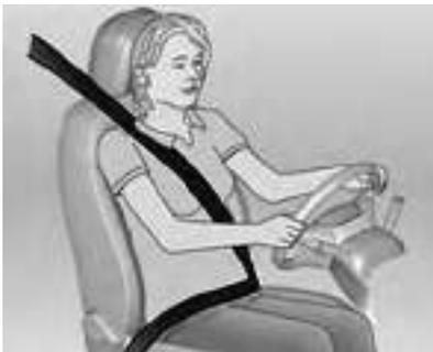
Extraiga el cinturón del riel, guíelo sin torsiones sobre el cuerpo y abrache la lengüeta en la hebilla.
