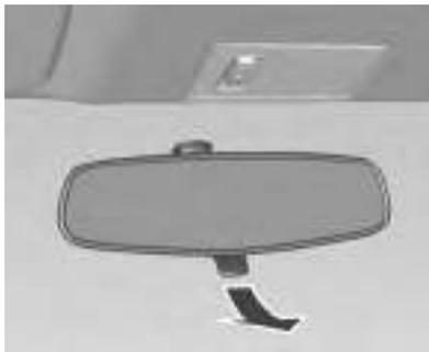
Para reducir el encandilamiento, ajuste la palanca que se encuentra debajo de la carcasa del espejo.
