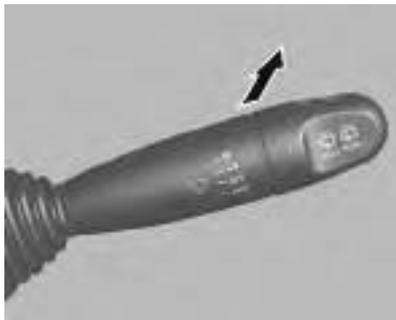
Para operar el limpia/lavaluneta trasera, presione la palanca hacia el tablero de instrumentos. Presione una vez: el limpiaparabrisas funcionará continuamente a baja velocidad. Para rociar líquido lavador, presione la palanca una vez más.
