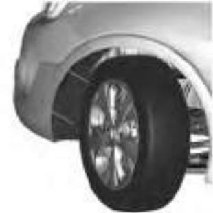
1. Incline la rueda y retire las 2 tuercas a presión de la parte inferior del revestimiento de la rueda.
