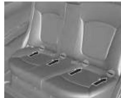
Para instalar un sistema de retención infantil con elementos de amarre bajos y superiores ISOFIX, siga las instrucciones entregadas con el sistema de retención.
