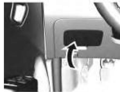
La caja de fusibles se encuentra del lado del conductor detrás de una tapa en el tablero de instrumentos.
