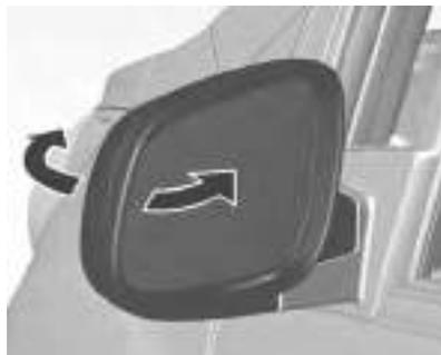
Para la seguridad de los peatones, los retrovisores exteriores basculan de su posición de montaje normal al recibir impactos de una determinada fuerza. Vuelva a colocar el retrovisor en su posición presionando ligeramente sobre la carcasa.
