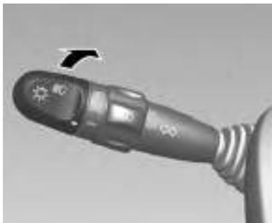
Para encender y apagar los faros y las luces traseras, gire el extremo de la palanca del interruptor combinado. El interruptor de luces tiene tres posiciones que activan diversas funciones de luz, a saber:
