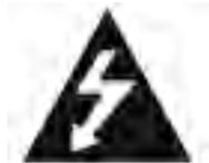
El símbolo de un rayo con una punta de flecha hacia abajo, en el interior de un triángulo equilátero, sirve para alertar al usuario acerca de la presencia de tensión peligrosa no aislada dentro del cuerpo del producto, que puede ser suficiente
