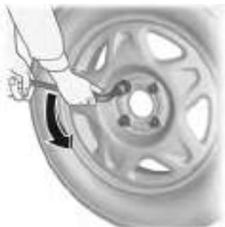
2. Despliegue la llave para tornillos de rueda e instálela asegurándose de que se coloca bien, y afloje cada tuerca de rueda media vuelta.
