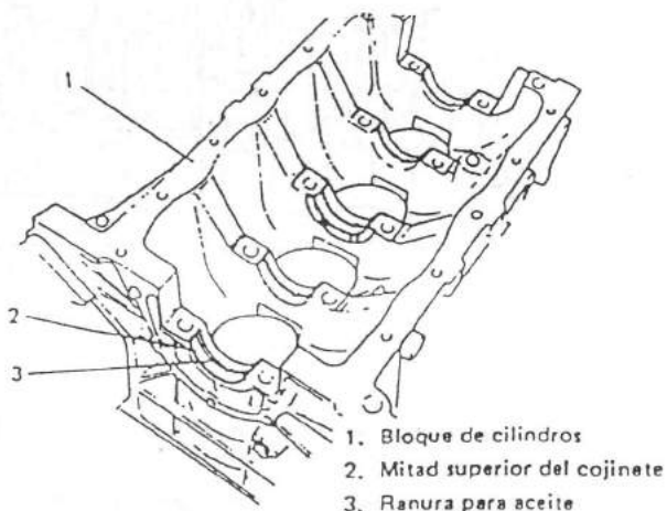
Fig. 3-5-42 Instalación de la mitad superior del cojinete
