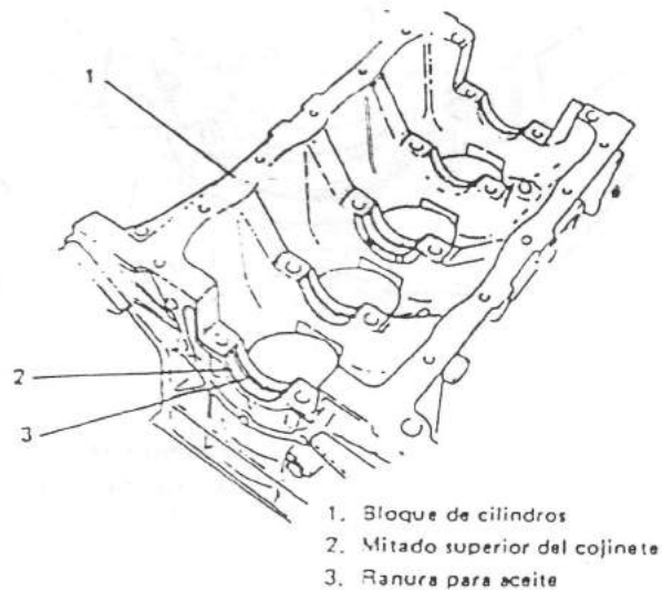
Fig. 3-6-1 Instalación de la mitad del cojinete con ranura para aceite
