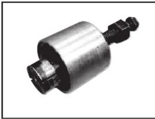
**Remove buje anti fricción**
