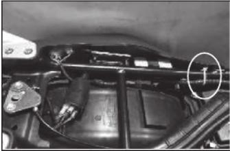
Soportes de cables cerca al filtro de aire usando pinzas de PVC
