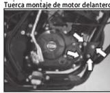
Tuerca montaje de motor delantero
