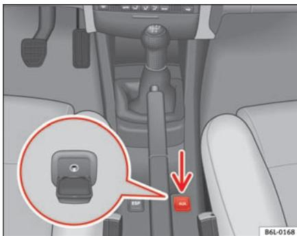
Fig. 83 Conecotor para la entrada auxiliar de audio
