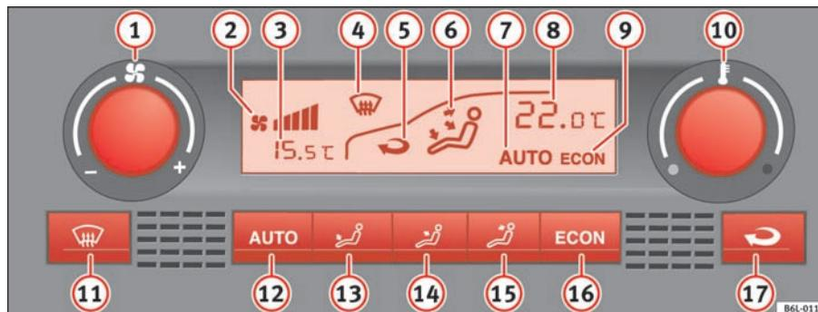
Fig. 91 Mando del Climatronic en el tablero de instrumentos
