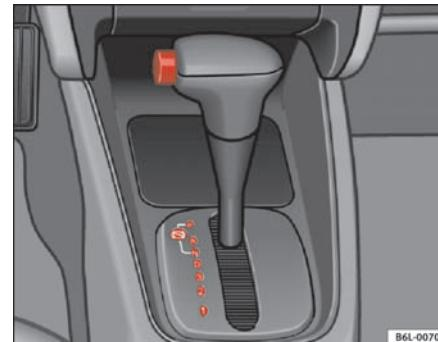
Fig. 97 Consola central: palanca selectora del cambio automático
