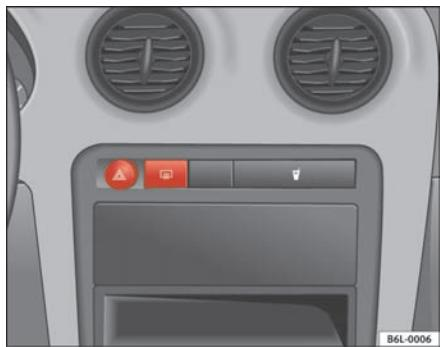
Fig. 57 Tablero de instrumentos: comutador de luneta térmica
