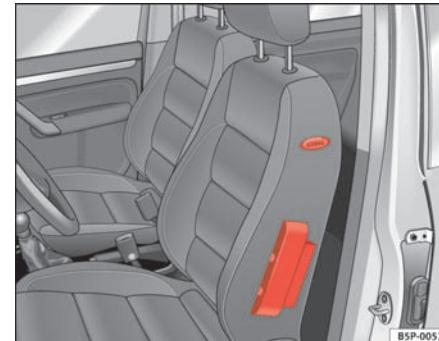
Fig. 20 Airbag lateral en el asiento del conductor
