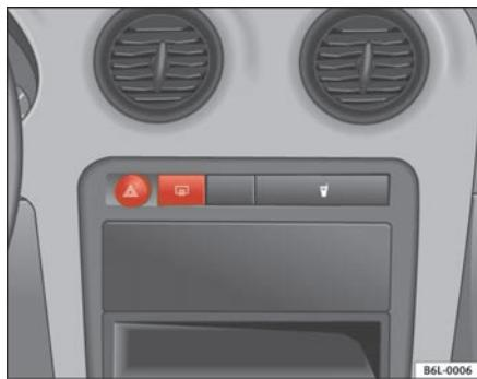
Fig. 58 Tablero de instrumentos: comutador de los intermitentes de emergencia
