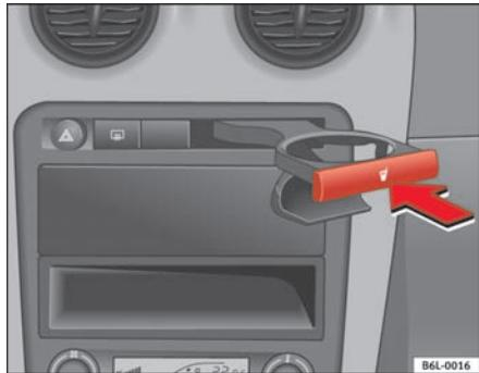
Fig. 79 Portabebidas delantero en la consola central
