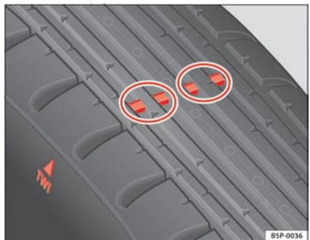
Fig. 129 Indicadores de desgaste del perfil del neumático
