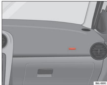
Fig. 17 Airbag del acompañante en el tablero de instrumentos
