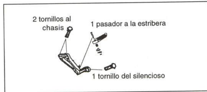
Figura 25.- Unión del soporte de estribera de pasajero derecha
