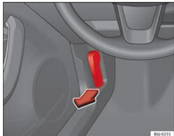
Fig. 123 Palanca apertura capó motor
