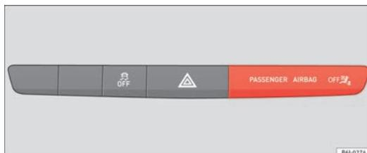
Fig. 22 Testigo de control de la desactivación del airbag del acompañante
