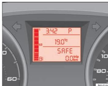
Fig. 110 Cambio automático: Pantalla del cuadro de instrumentos
