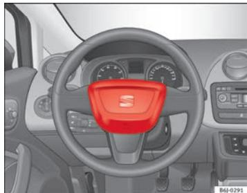
Fig. 16 Airbag del conductor en el volante
