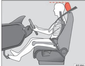
Fig. 2 Posición correcta del apoyacabezas del conductor
