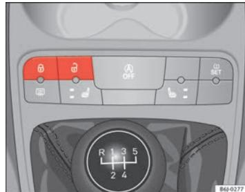
Fig. 43 Pulsador del cierre centralizado
