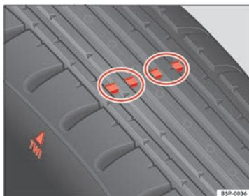
Fig. 134 Indicadores de desgaste del perfil del neumático
