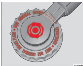
Fig. 133 Tapón del depósito del líquido de frenos en el vano motor
