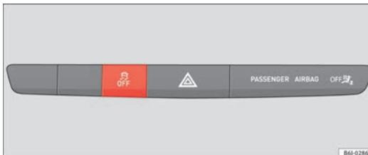
Fig. 98 Detalle del tablero de instrumentos: tecla ESC.
