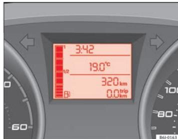
Fig. 32 Indicador de nivel del depósito de combustible
