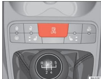
**Fig. 100 Consola central: comutador de control del sistema de gas.**
