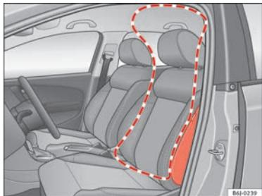
Fig. 20 Airbag lateral en el asiento del conductor
