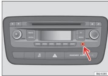
Fig. 88 Conexión AUX en consola central (en función del equipamiento)
