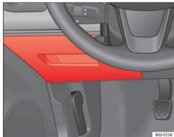
Fig. 141 Fusibles en tablero de instrumentos
