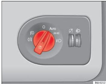
Fig. 55 Encendido automático de luces
