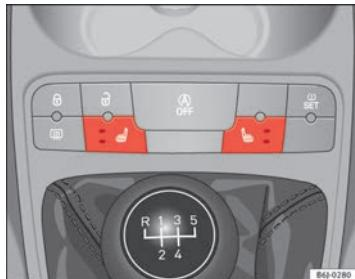
Fig. 73 Comutador de la calefacción de los asientos delanteros
