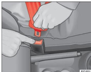
Fig. 15 Retirar la lengüeta del cierre del cinturón ►
