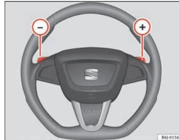
Fig. 109 Volante con levas para cambio automático
