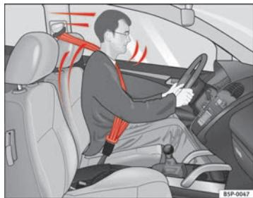
**Fig. 10** Conductor con el cinturón de seguridad bien puesto: es sujetado por él mismo en un frenazo brusco
