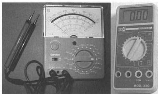
Estos representan la totalidad de los multímetros utilizados para realizar las medidas sobre los vehículos, gracias a la mejor precisión de lectura y también a su facilidad de manejo. Generalmente un multímetro nos permite medir resistencias, tensiones continuas y alternas, corrientes y capacidades. En las imágenes siguientes se representan algunas medidas efectuadas por el multímetro integrado en Uniprobe donde además encontramos las indicaciones para su funcionamiento.
