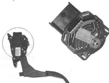
Para fines de diagnóstico normalmente el potenciómetro para pedal de acelerador se monta como sensor doble (redundante). Este circuito redundante se monta con dos potenciómetros o con interruptor de ralentí.
