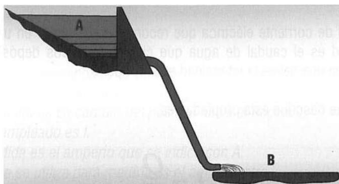
Hay que destacar que, a igualdad de condiciones, cuánto más alto se encuentra el depósito A, mucha mayor será la velocidad del agua y por consiguiente también aumentará el caudal. La estructura del tubo determina el caudal máximo de agua.
