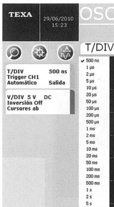
La particularidad que permite medir el tiempo que la señal emplea en recorrer en sentido horizontal cada división de la pantalla, es definida por el eje de las abscisas con selecciones que pueden variar de 500ns/div. a 5s/div.
