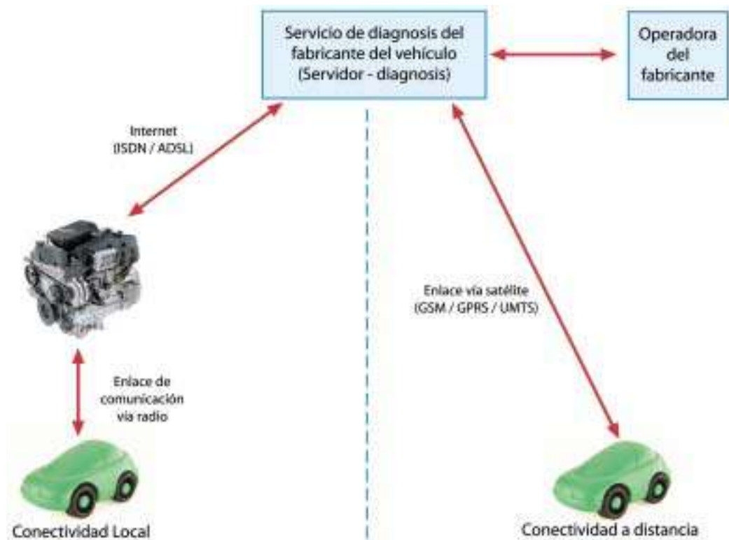
Figura 2.4 Diagrama de bloques ilustrativo de la diagnosis remota (off- line)
