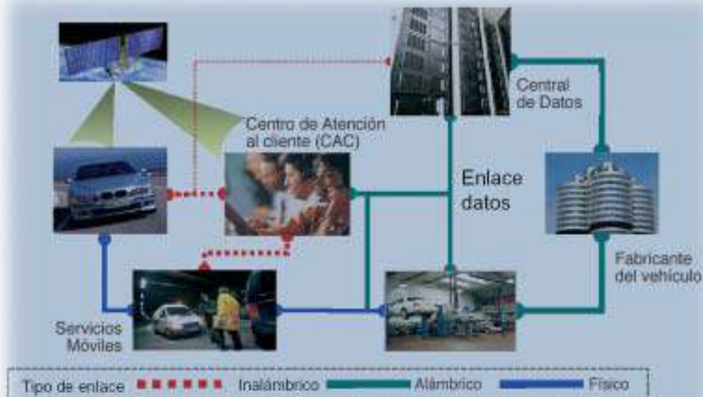
Figura 2.14 Diagrama de bloques general del concepto de la tercera generación de diagnosis de a bordo (OBD-III).
