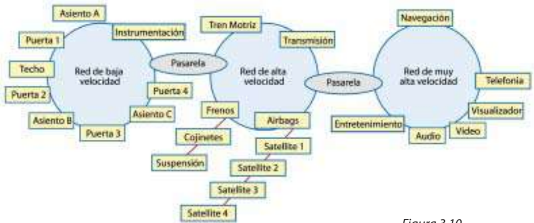
Figura 3.10 Ejemplo de enlace entre redes y multiplexación de información en vehículos avanzados.
