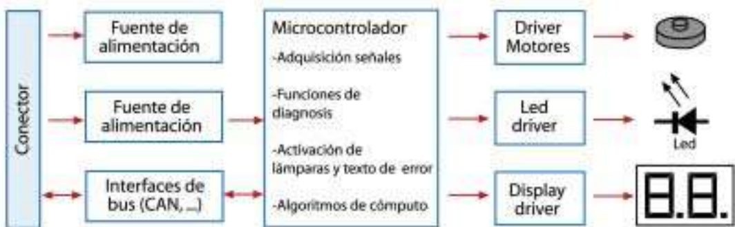
Figura 3.21 Esquema de un panel de instrumentación (instrument cluster) típico de automóvil.
