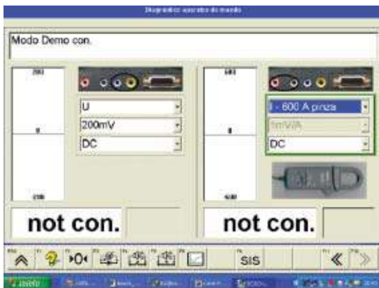
Figura V.8 Información sobre el conexionado a realizar para medidas de tensión y/o corriente.
