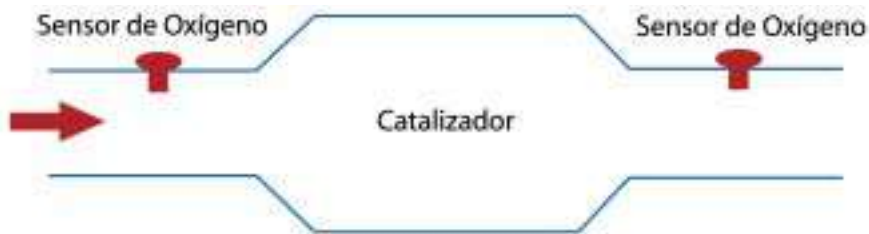
Figura 2.8 Sensores adicionales para la monitorización del catalizador.
