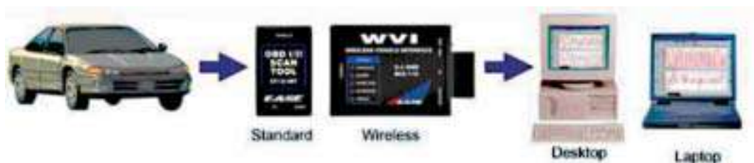
Figura 3.40 Elementos y conexionado entre el coche y el equipo de diagnosis
