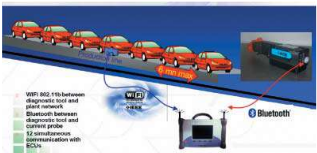
Figura 4.75 Servicios de diagnosis y calibración en el entorno de una línea de fabricación
