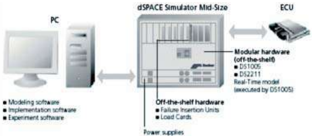
Figura 4.31 Ejemplo de prueba de un ECU en un sistema de emulación (Hardware in the Loop)
