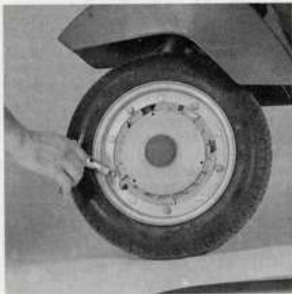
Desmontaje rueda delantera; para la trasera seguir procedimiento análogo.
