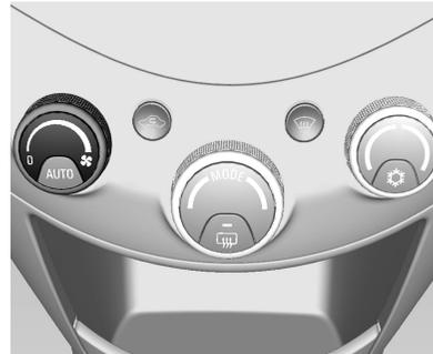
Gire el conmutador giratorio izquierdo. En sentido horario para aumentar la velocidad del ventilador y en sentido antihorario para disminuirla.
