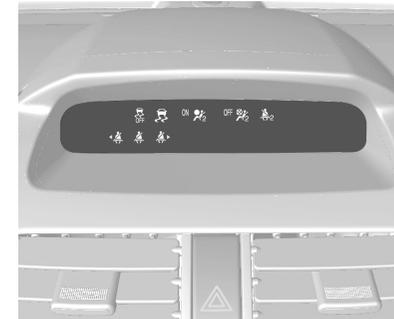
En caso de colisión, el sistema del airbag del acompañante se inflará siempre que el testigo de control
