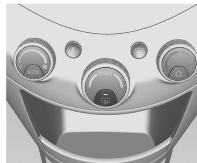
Se conecta pulsando el botón
