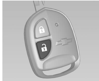
Si se desbloquea el vehículo con el botón
