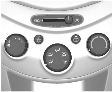
1. Configure el modo de recirculación en el modo de aire exterior y ponga el mando del distribuidor de aire en DEFROST
