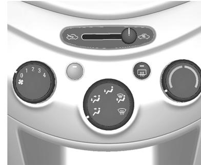
1. Configure el modo de recirculación en el modo de aire exterior y ponga el mando del distribuidor de aire en DEFROST
