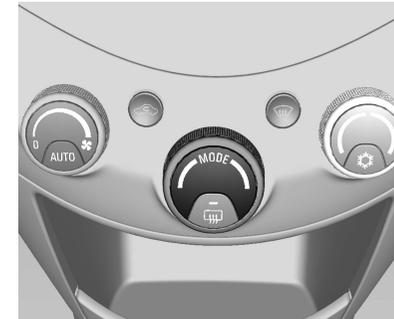
Gire el mando **MODE** una o más veces para obtener el ajuste deseado. La distribución de aire se indica en la pantalla.
