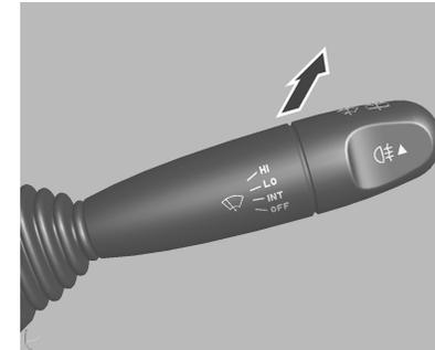
Para poner en marcha el limpiaparabrisas y el lavador traseros, mueva la palanca hacia el panel de instrumentos.
