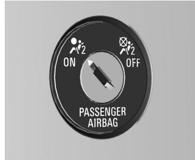
El sistema de airbag del acompañante se puede desactivar mediante una cerradura en el lado del tablero de instrumentos, visible con la puerta del acompañante abierta.
