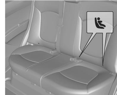
2. Busque las dos posiciones de anclaje inferiores. La ubicación de los anclajes inferiores está señalada con una marca circular en el borde inferior del respaldo del asiento trasero.
