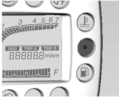
El testigo de seguridad parpadeará para indicar que el sistema de alarma antirrobo está en funcionamiento.
