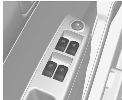
Los elevallunas eléctricos se pueden accionar con el encendido conectado.
