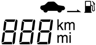
Este modo indica la distancia estimada que se puede recorrer hasta que se agote el combustible que queda en el depósito.
