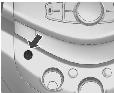
La información de la temperatura recogida en el interior del vehículo se utiliza para establecer las necesidades del sistema de ventilación cuando funciona en el modo **AUTO**.
