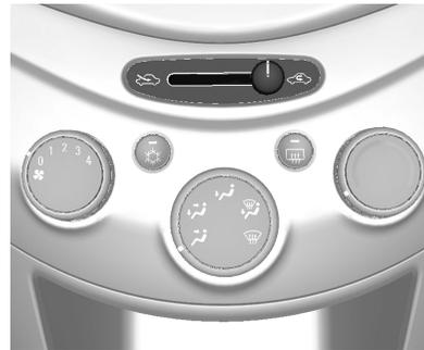
El modo de recirculación de aire se acciona con la palanca
