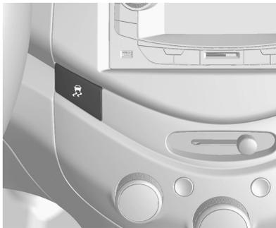
Para una conducción muy deportiva, se puede desactivar el ESC: pulse el botón
