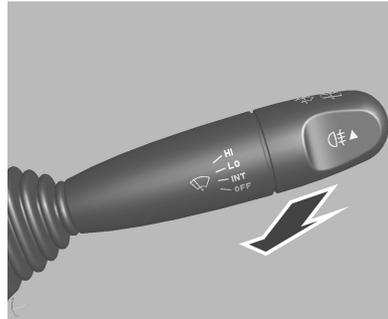
Tire de la palanca. Se pulveriza líquido de lavado sobre el parabrisas y el limpiaparabrisas se realiza el barrido varias veces.
