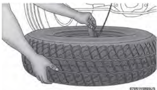
Presione en el retenedor a través del centro de la rueda y posicíonelo
