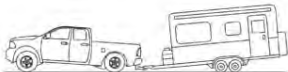
EJEMPLO — Sin enganche de distribución del peso (incorrecto)
