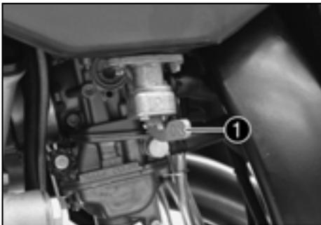
El grifo de la gasolina se encuentra en el lado izquierdo del depósito de combustible. Con el mango giratorio 1 en el grifo de la gasolina puede abrirse y cerrarse la alimentación de combustible para el carburador.
