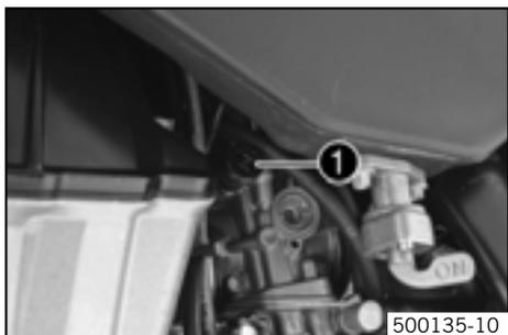
El botón de arranque en frío ❶ se encuentra en el lado izquierdo del carburador. Si está activada la función de arranque en frío, se abre un orificio en el carburador que permite que el motor aspire combustible adicional. Como consecuencia, la mezcla de aire y combustible es más rica, tal como es necesario al arrancar con el motor en frío.
