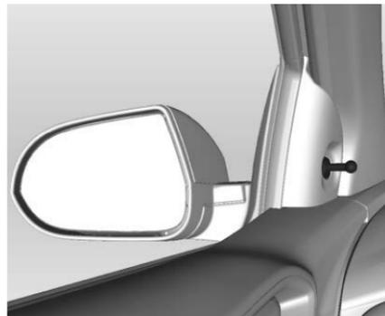
Si está equipado con espejos manuales, ajuste el espejo exterior usando la manija.
