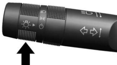
El control de las lámparas exteriores está en la palanca de señal direccional.
