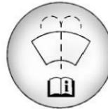
Abra el tapón que tiene el símbolo del lavaparabrisas. Agregue líquido para lavaparabrisas hasta llenar el tanque. Vea en *Vista general del compartimento del motor* ⇨ 137 la ubicación del depósito.
