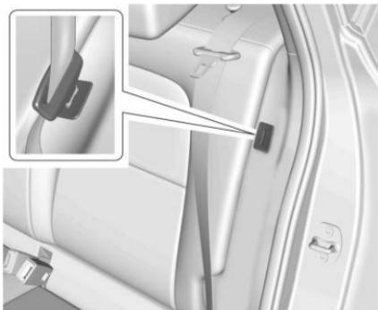
2. Guarde el cinturón de seguridad en la placa de almacenamiento insertando la placa de seguro en la ranura.
