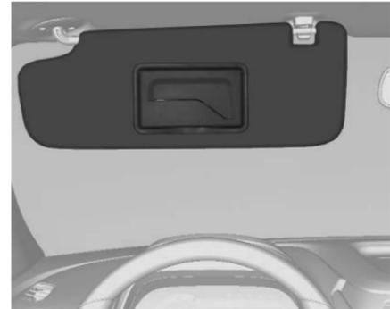
Tire de la visera hacia abajo para bloquear el resplandor. Desprenda la visera del montaje central para girarla a la ventana lateral.
