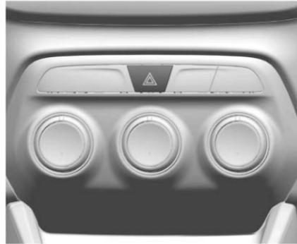
⚠ : Presione ⚠ para hacer que las luces direccionales delanteras y traseras destellen intermitentemente. Presione nuevamente para apagar las intermitentes.
