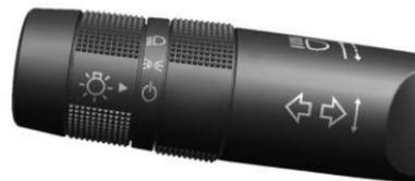
☰● : Presione la palanca de señal direccional hacia adelante y libérela para encender las luces altas. Para volver a las luces bajas, empuje la palanca de nuevo o jálela hacia usted y libérela.
