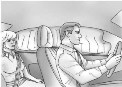
El vehículo tiene bolsas de aire de riel de techo para el conductor y el pasajero exterior delantero, están ubicadas en el techo, arriba de las ventanas laterales.
