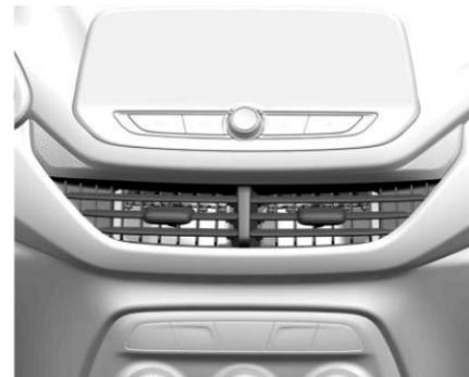
Use las aletillas ubicadas en las ventilas de aire para cambiar la dirección del flujo del aire.
