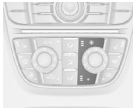
Pulse el botón inferior para disminuir la velocidad del ventilador o el botón superior para aumentarla, como se muestra en la ilustración. La velocidad del ventilador se indica mediante el número de segmentos en la pantalla.
