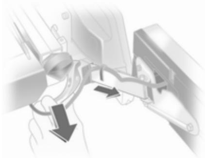
Baje la palanca de retención y extraiga los dos soportes de las luces de sus alojamientos.
