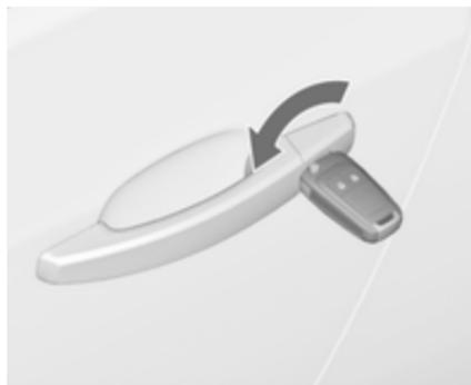
Desbloquee manualmente la puerta del conductor girando la llave en la cerradura. Conecte el encendido y pulse el botón del cierre centralizado
