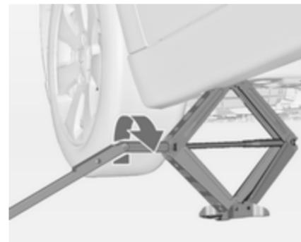
Acople la llave para ruedas y, con el gato correctamente alineado, gire la llave para ruedas hasta que la rueda se despege del suelo.
