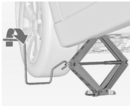
Acople la manivela del gato y, con el gato correctamente alineado, gire la manivela hasta que la rueda se desprege del suelo.
