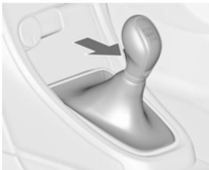
Para engranar la marcha atrás, con el vehículo parado, pulse el botón de desbloqueo de la palanca selectora y engrane la marcha.
