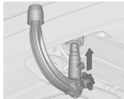
Meta la barra de rótula apretada en el orificio y empuje con firmeza hacia arriba hasta que oiga que se acopla.
