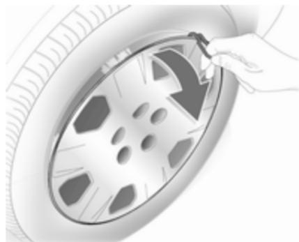
1. Desenclave los tapones de las tuercas de rueda con un destornillador y desmóntelos. Quite el tapacubos con el gancho. Herramientas del vehículo ↗ 210.
