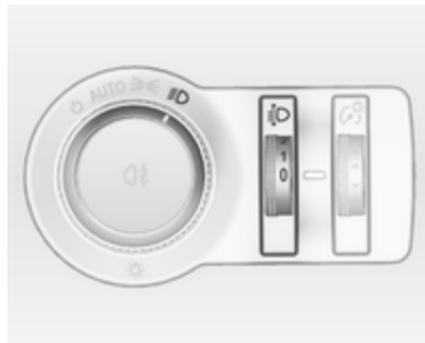
Para adaptar el alcance de los faros a la carga del vehículo y evitar el deslumbramiento: gire la rueda de ajuste
