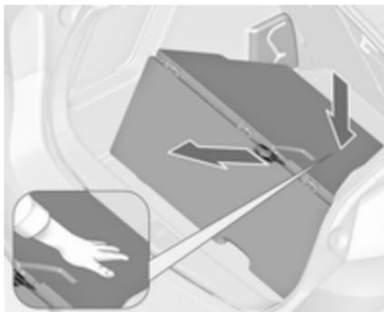
Para bajar la cubierta, tire de la correa hacia atrás y presione sobre el centro delantero de la cubierta a la vez.
