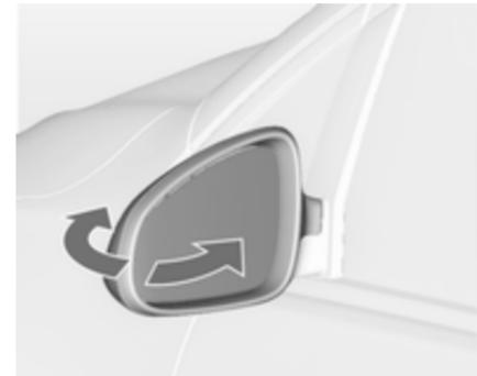
Para la seguridad de los peatones, los retrovisores exteriores basculan de su posición de montaje normal al recibir impactos de una determinada
