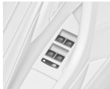
Pulse el interruptor
