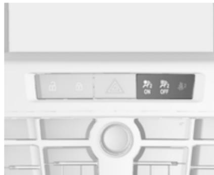
En caso de colisión, el sistema de airbag del asiento del acompañante se inflará siempre que el testigo de control
