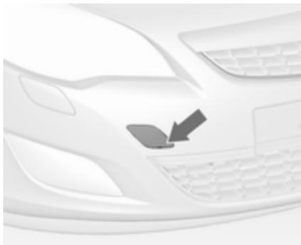
Introduzca un destornillador en la ranura de la curva inferior de la tapa. Suelte la tapa moviendo cuidadosamente el destornillador hacia abajo.
