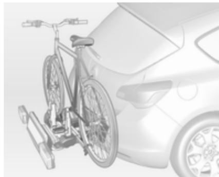
El portabicicletas trasero (sistema Flex-Fix) ofrece la posibilidad de fijar bicicletas en un soporte extraíble integrado en el piso del vehículo. No se permite el transporte de otros objetos.
