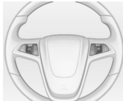
El sistema de infoentretenimiento, el regulador de velocidad y un teléfono móvil conectado pueden manejarse con los mandos en el volante.
