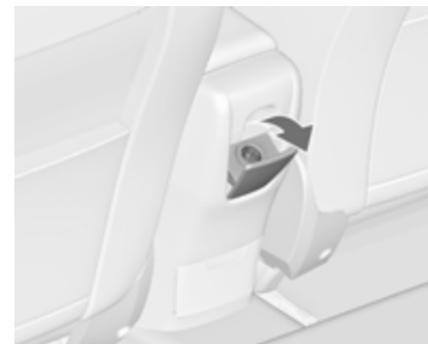
Hay otra toma de corriente de 12 V situada en la consola trasera. Pliegue la cubierta hacia abajo.
