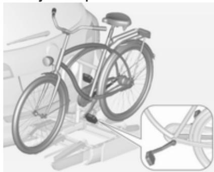
1. Gire los pedales hasta que estén como se muestra en la ilustración y coloque la bicicleta en el alojamiento para las ruedas que queda más adelante.
