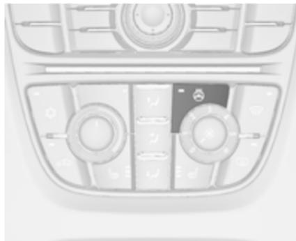
Active la calefacción pulsando el botón
