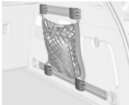
Inserte los adaptadores en la posición deseada de los carriles. El bolsillo de la red puede colgarse de los adaptadores.
