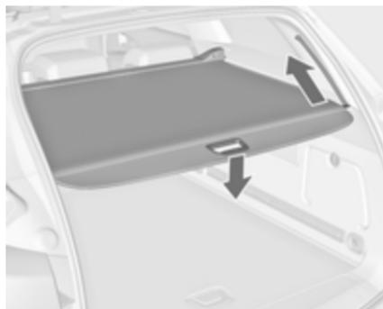
Empuje el asidero en el extremo de la cubierta hacia abajo. La parte trasera de la cubierta se guía automáticamente hacia arriba.
