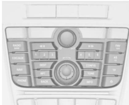
Seleccione una función a través de los botones del sistema de infotainment. Se muestra el menú de la función seleccionada.
