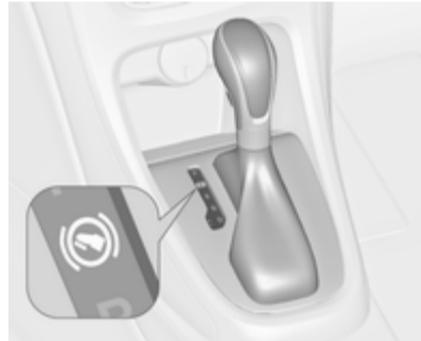
Si el pedal del freno no está pisado, se enciende el testigo de control (P).
