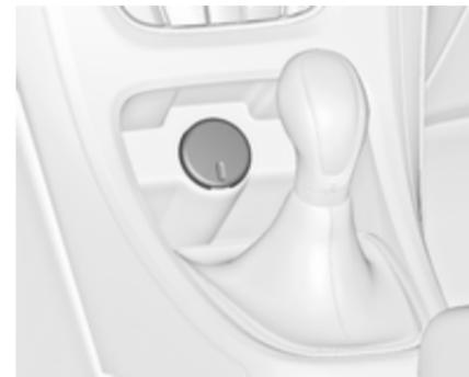
Hay una toma de corriente de 12 V situada en la consola delantera.
