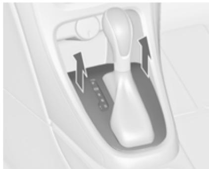
2. Quite la moldura de la palanca selectora de la consola central por delante, pliéguela hacia arriba y gírela a la izquierda.
