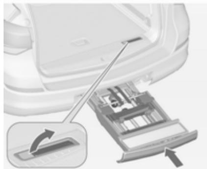
Tire de la palanca de desbloqueo hacia arriba y empuje el portabicicletas hacia el parachoques hasta que oiga que se enclava.
