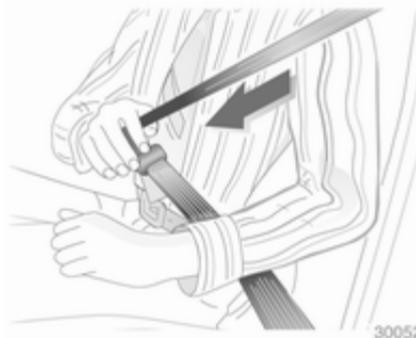
Extraiga el cinturón del retractor, guíelo por encima del cuerpo sin retorcerlo e inserte la lengüeta en el cierre. Durante el viaje, tense frecuentemente el cinturón abdominal tirando suavemente de la banda torácica. Recordatorio del cinturón de seguridad ↻ 106.
