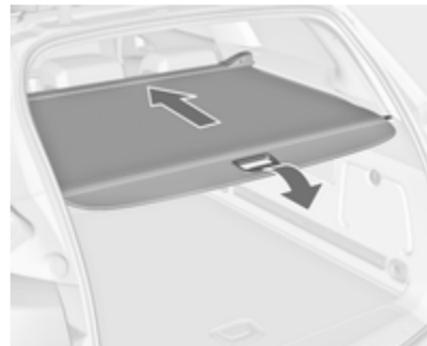
Tire del asidero en el extremo de la cubierta hacia atrás y hacia abajo. Se enrolla automáticamente.
