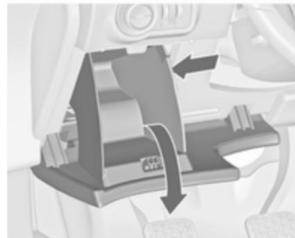
En los vehículos con volante a la izquierda, la caja de fusibles está detrás del compartimento portaobjetos en el tablero de instrumentos.
