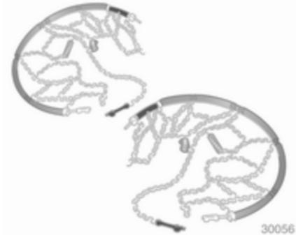
Sólo se pueden utilizar cadenas en las ruedas delanteras.
