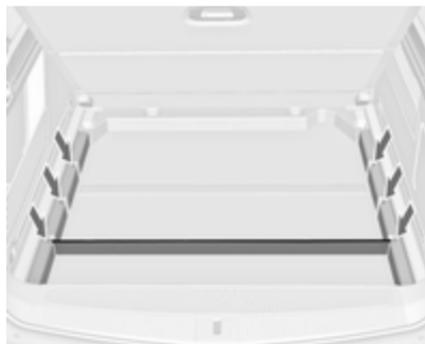
Inserte la barra en los rebajes de las paredes laterales.
