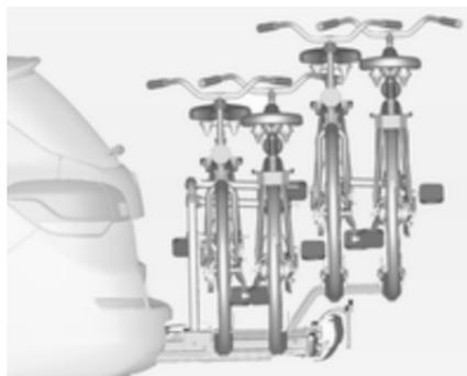
El portabicicletas trasero (sistema Flex-Fix) ofrece la posibilidad de fijar dos bicicletas en un soporte extraíble integrado en el suelo del vehículo. Se pueden sujetar dos bicicletas más en un adaptador. No se permite el transporte de otros objetos.
