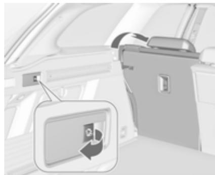
Accione el interruptor en el lado izquierdo o derecho del compartimento de carga para abatir la parte correspondiente del asiento trasero.
