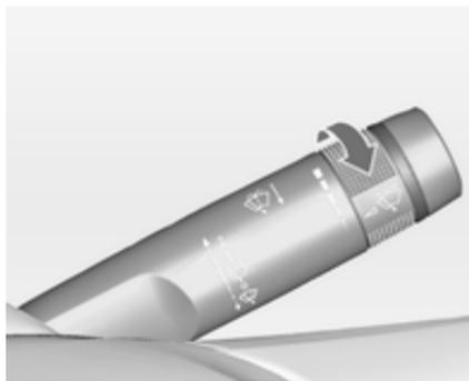
Palanca del limpiaparabrisas en posición .
