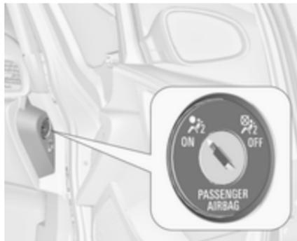
El sistema del airbag del acompañante delantero puede desactivarse con un interruptor accionado por llave situado en el lado derecho del panel de instrumentos.
