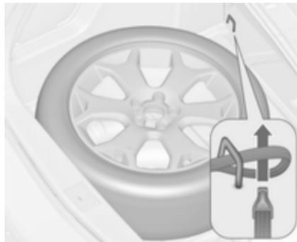
2. Coloque el lazo del extremo de la correa en la argolla delantera del lado correspondiente.
