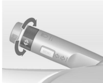
Las señales de tráfico se muestran en la página **Detección de señales de tráfico** en el **Menú de información viaje/combustible**, que se selecciona mediante la rueda de ajuste en la palanca de los intermitentes ⇄ 113.
