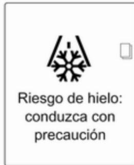
Si la temperatura exterior desciende a 3 °C, se muestra un mensaje de advertencia en el centro de información del conductor con pantalla de gama alta.
