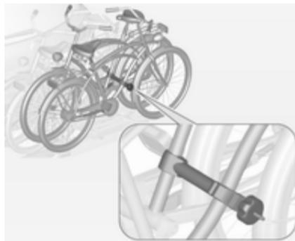
Utilice el soporte de montaje auxiliar corto para colocar la cuarta bicicleta. El soporte se tiene que fijar entre los cuadros de la tercera y la cuarta bicicleta.
