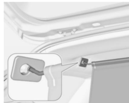
Hay dos aberturas de montaje en el marco del techo: enganche y enclave la varilla de la red en un lado, comprima la varilla para engancharla y enclavarla en el otro lado.
