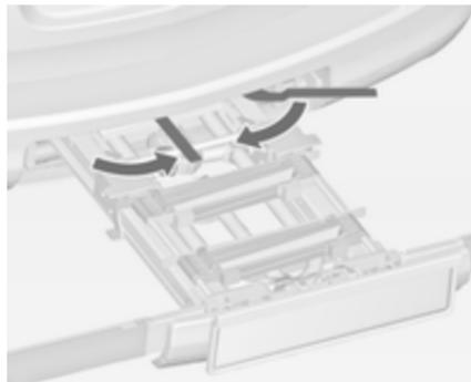
Mueva las dos palancas de fijación hacia dentro todo lo que se pueda.
